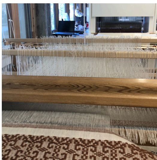
Skaft 1 er flyttet bak, og renningen kan klippes ned
