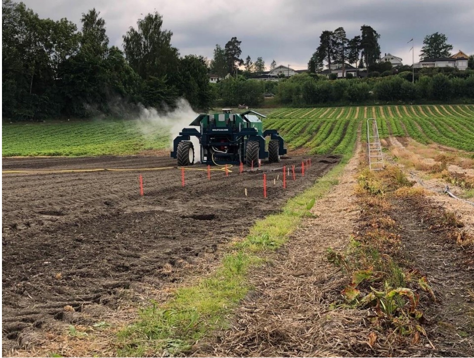
Figur 2.2.1. Bildet er tatt juni 2023 og viser «FieldSaver» maskinen. Den viser også rutene hvor maskinen dampet markert med røde pinner og navngitt på trepinner i rutene (SoilSteam, 2024).
