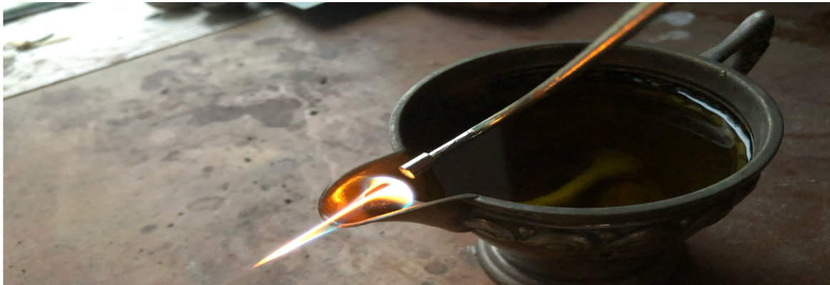
Figur 13: Første preliminnære forsøk med olivenolje og 4mm bomullveke. Eget foto.
