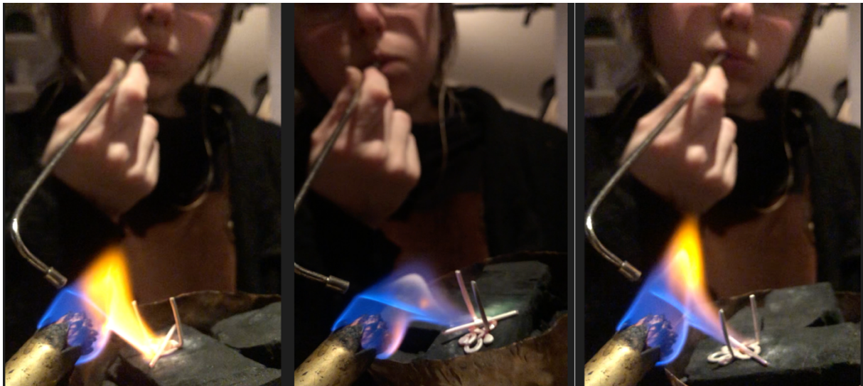
Figur 23: Lodder fatting med klør på kullblokk i stor kolstabe..
