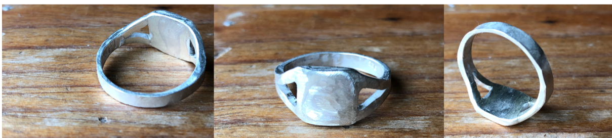
Figur 20: signet ring loddet og litt filt. Eget foto.
