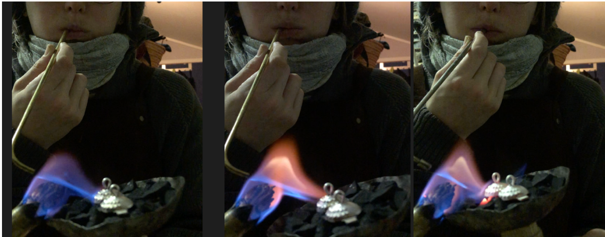
Figur 26: stillbilder fra video av at jeg lodder halsknappen til bunnplaten på den lille kolstabben. I de to bildene til venstre blåser jeg med røret med det store hullet, bare for øving, i bilde c. til høyre bruker jeg den med dyse. Se en litt mer skapt definert blå ildkjegle i bilde c. med mer konsentrert luftstråle med dysen.
