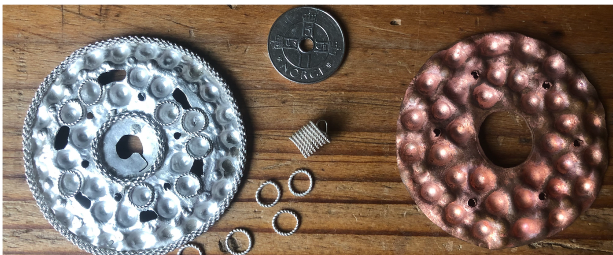
Figur 29: delvis loddet skålsølje-utprøving med kunst-tråd ytre og indre sarg, og kobberprøve
