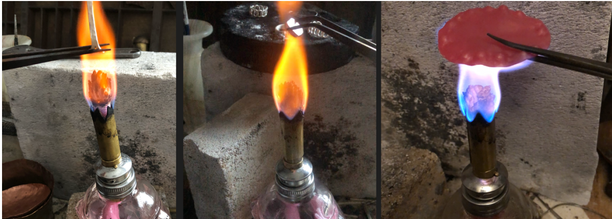
Figur 16: Gløding uten blåserør. Den myke store ilden fra lampen egner seg godt til gløding alene.
