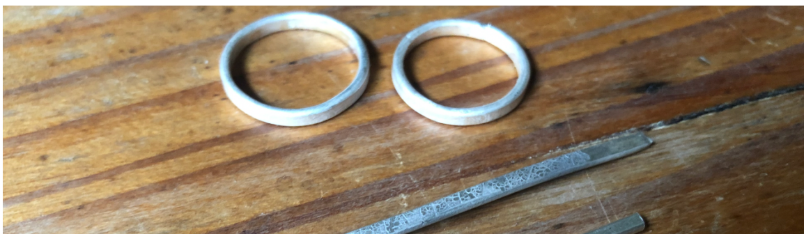
Figur 17: ringer i 935 sølv med bladskjelett fra hassel valset inn. Eget foto
