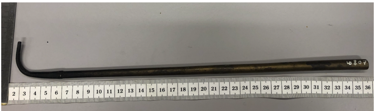
Figur 9: Blåserør LB.00807. Todelt i messing og kobber uten dyse. Eget foto.
