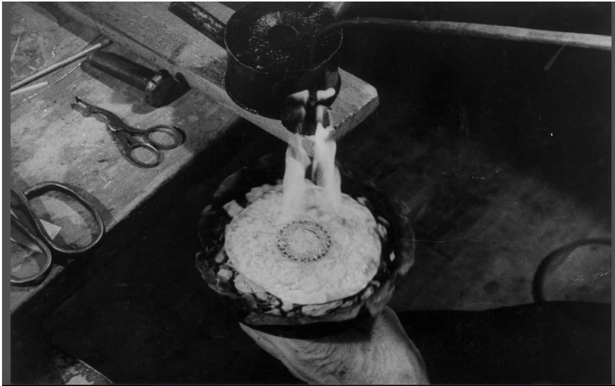
Figur 6: «Laging av sølje, Hylestad, Valle, Aust-Agder, 1959. Sølvsmed Knut Helle i arbeid med lodding.» Fotograf Kyrre Grepp, kilde digitalt museum. Her er det synlig at sølja ligger på en kolstabbe som blir rotert i venstre hånd mens blåserøret retter ilden mot det. Det ser for meg ut som at kolstabben og sølja er litt uklare fordi de er i bevegelse/rotasjon. Se blåserøret kommer ned fra øvre høyre hjørne og med utblåsningen leder flammen mot kolstabben og arbeidsstykket.
