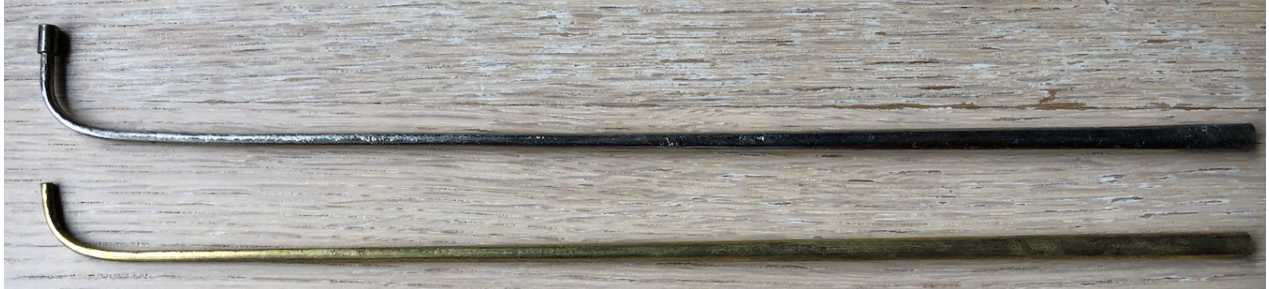
Figur 11: Blåserør benyttet av meg i prosjektet. Øverste med dyse på enden og lite hull og nederste uten dyse med stort hull. Eget foto.
