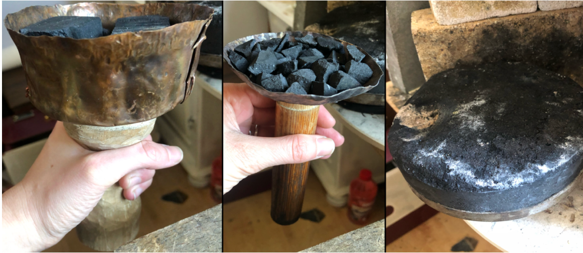
Figur 14: a. stor kolstabbe, b.liten kolstabbe, c. rund loddekull-flate. Egne foto.
