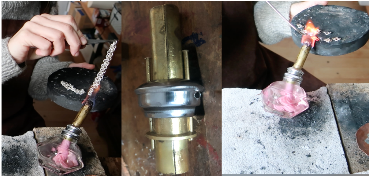
Figur 12: a: loddelampen gløder lenke. b: Min modifikasjon på lampen. Messing-delene har jeg lagt til på originalt skrulokk. c: lodding av lenke med blåserør. Veken er rosa fordi rødsprit er mest tilgjengelig brennesprit i Norge. Egne foto og stillbilder fra video av praksis.
