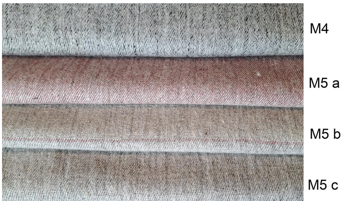
Figur 30. treskaftet kypert, M4 øverst og M5 a, b og c. Eget foto.
