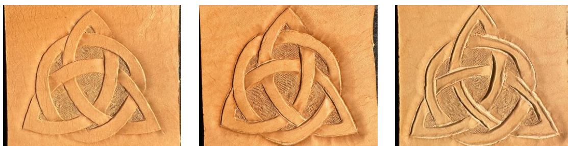
Figur 10 Bildene viser ferdig preget mønster i ulike fuktgrader, f.v. tørt (nr. 22), lettfuktet (nr. 23), overfuktet (nr. 24). Lærets tykkelse 3,5mm.
