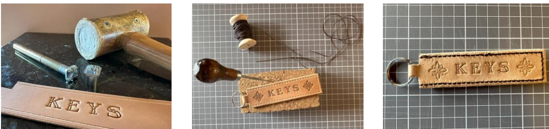
Figur 14 Bildene viser prosessen med å lage nøkkelring. F.v. arbeidet med preging, lager sømhull med syl, ferdig sydd nøkkelring.
