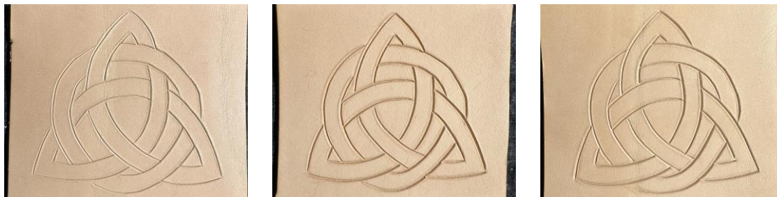
Figur 9 Bildene viser arbeid med svivelkniv i ulikt fuktgrad, f.v. tørt (nr. 10), lettfuktet (nr. 11), overfukta (nr. 12). Lærets tykkelse 2mm.
