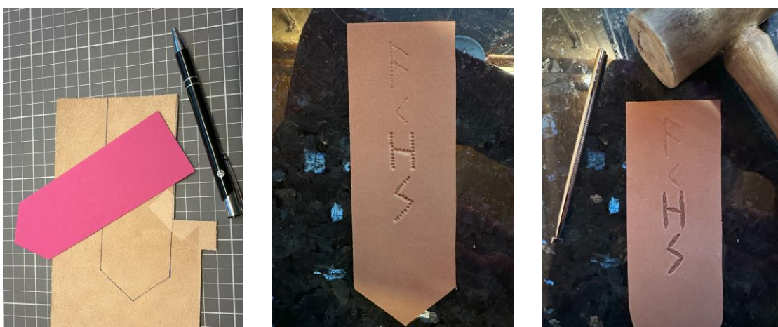
Figur 15 Bildene f.v. viser oppmerking av bokmerke, bokmerke preget med strikkepinne og bokmerke preget med punsel.
