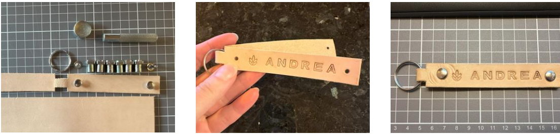
Figur 13 Bildene viser prosessen med å lage nøkkelring med navn. F.v. punslene brukt samt utstyr til sammenføring, ferdig preget og ferdig nøkkelring.
