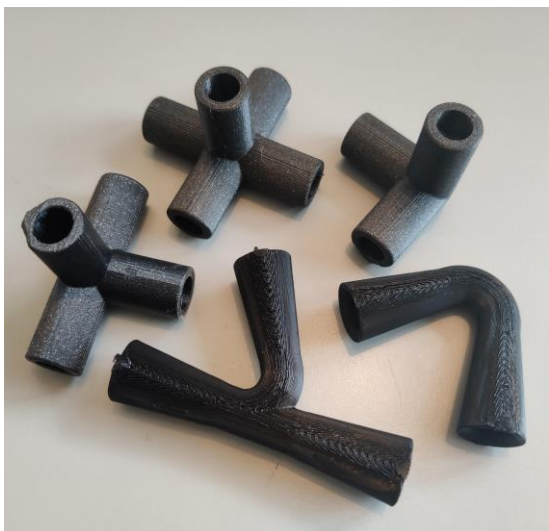
Figur 32: 3D-modellerte og 3D-printede «muffeer». (Foto: Eget foto)
