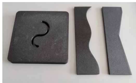
Figur 18: 3D-printet ekstrudermal (t.v.) og dreieskinner (t.h.). (Foto: Eget foto)
