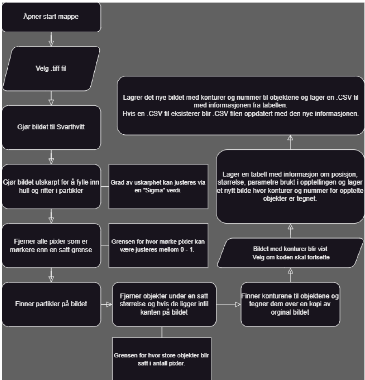
Figur 5: Diagram over de forskjellige trinnene i Python-skriptet som finner objekter på bildene av filtrene.
