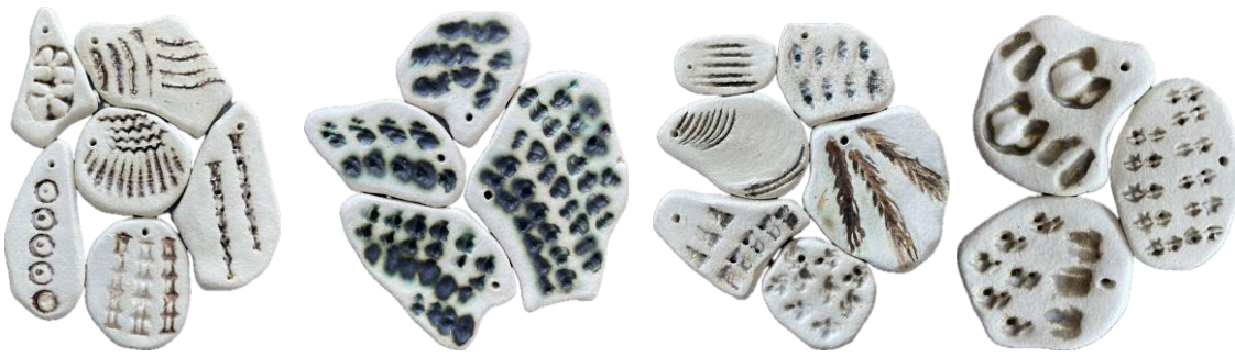
Figur 30-47 Utprøving med oksider. Fra venstre: Manganoksid, svart kobberoksid, rød jernoksid og svart nikkel oksid
