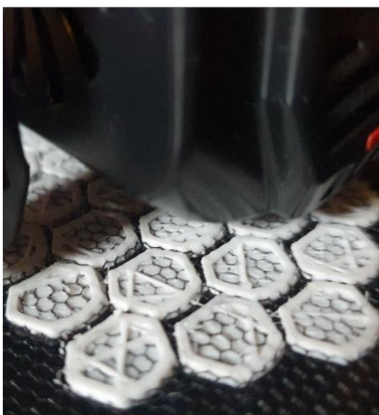
Figur 47: Her ser man tydelig hvordan tyllstoffet blir festet mellom lagene på 3D-printen
