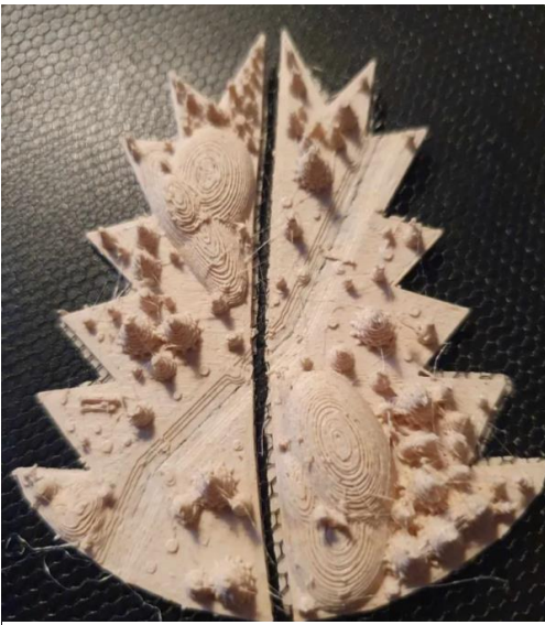
Figur 58: Ikke helt det resultatet jeg var ute etter. For liten skala og for mange detaljer som ikke kommer tydelig nok frem
