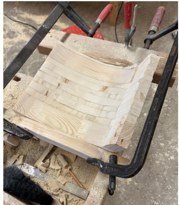
Figur 33 - Bilde: utjevning av innvendig dørblad
