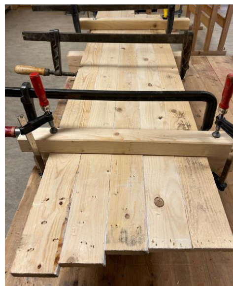
Figur 19 - Bilde: liming av benkeplaten
