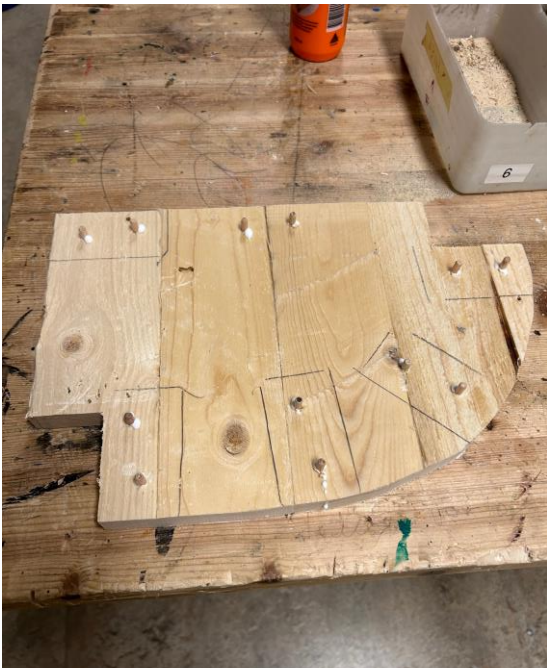
Figur 29 - Bilde: gulyplate med treplugger Figur 30 - Bilde: gulyplate med klosser
