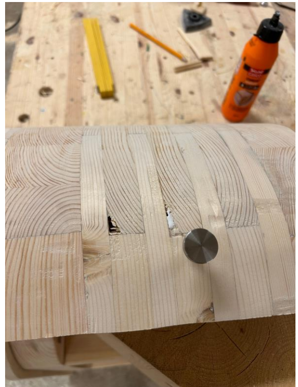
Figur 37 - Bilde: sprekker i dørbladet
