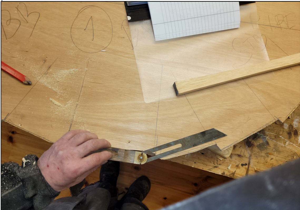
Fig. 14. Til brunfellingen hentet jeg vinkelen på direkte fra modellspantene.
