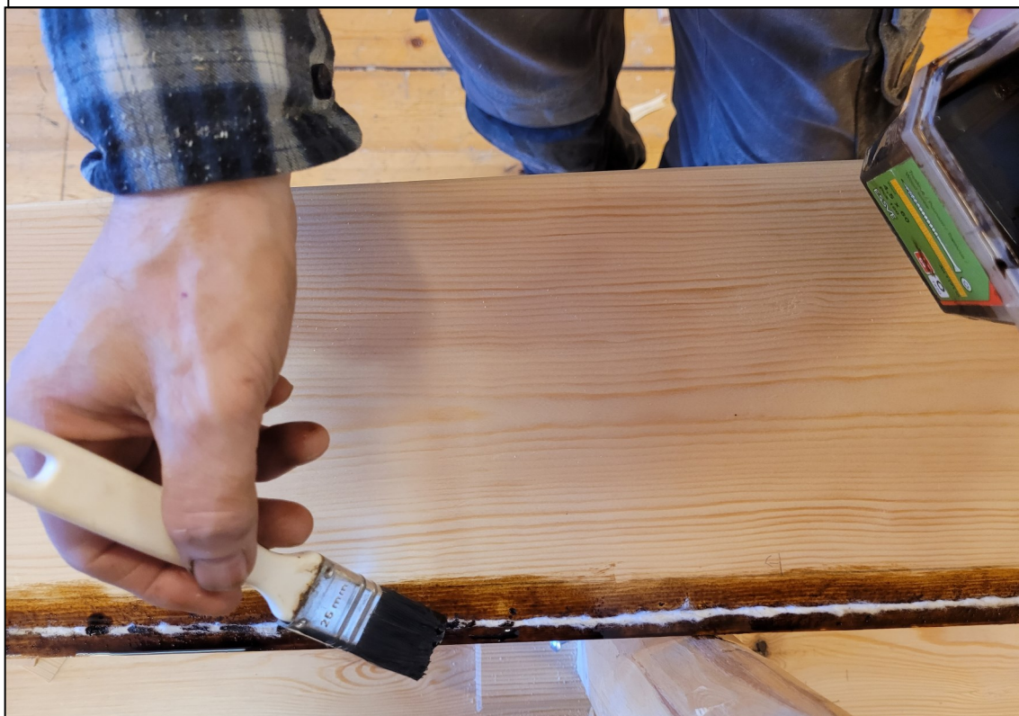
Fig. 24. Sua mellom bordene ble tjæret og en sitråd av bomull lagt midt i sua. Tjære i sua har vært benyttet, men sitråd er jeg usikker på om har vært i bruk. Det var ikke mulig å fastslå dette ut i fra undersøkelsen av Lårdalsprammen.
