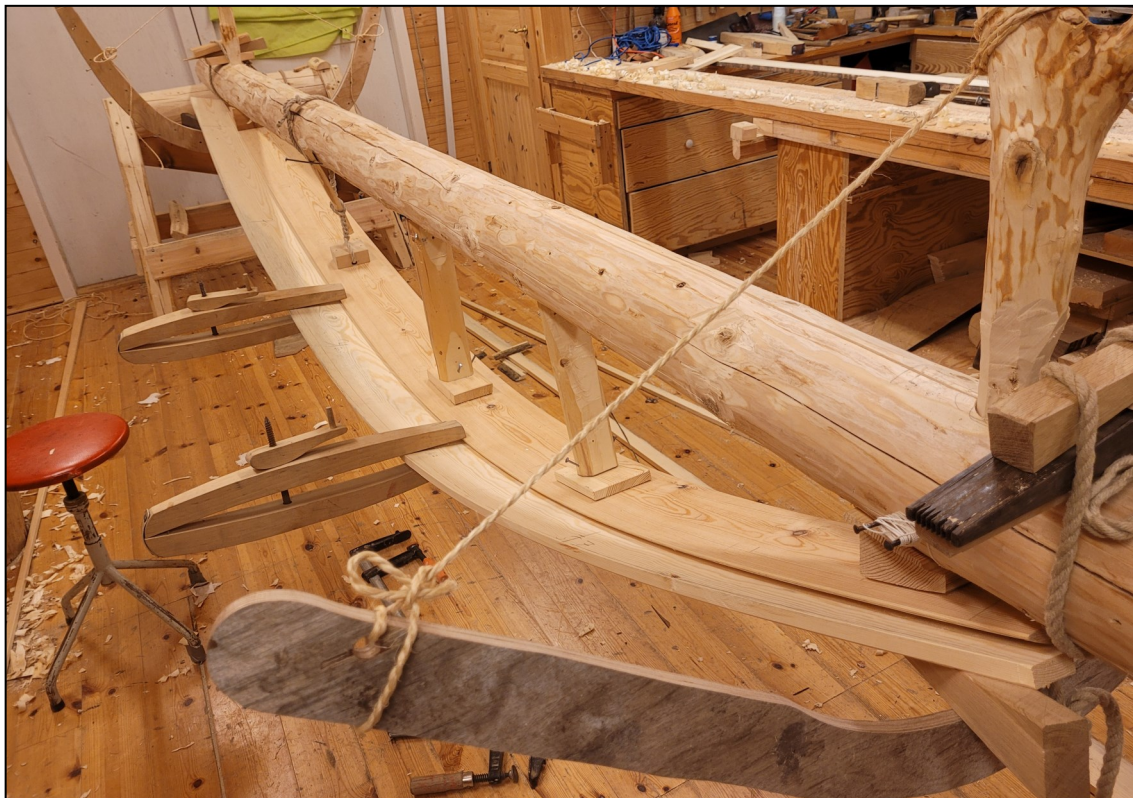
Fig. 23. Med bordet holdt på plass med båtklemmer, ble prambordet kilet opp fremme med en trekile mellom bord og støttespant. Den siste glipen mellom bordene ble trukket i hop med tau og et vinnebord. På dette bildet har jeg ennå ikke festet den trekantede klossen på oversiden av byggestokken. Tauet med vinnebordet sklei framover på grunn av vinkelforskjellen mellom byggestokken og prambordet. Når trekantklossen kom på plass, ble denne prosessen langt enklere.
