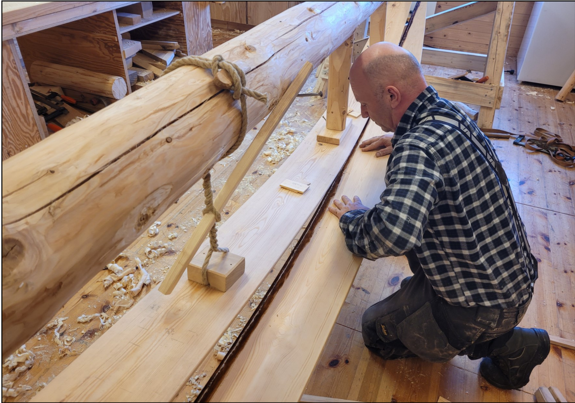
Fig. 25. Det første bordet er klart for montering etter mange runder med utprøving. Bordet ble lagt opp i støttespantene og klemt ned under prambordet.
