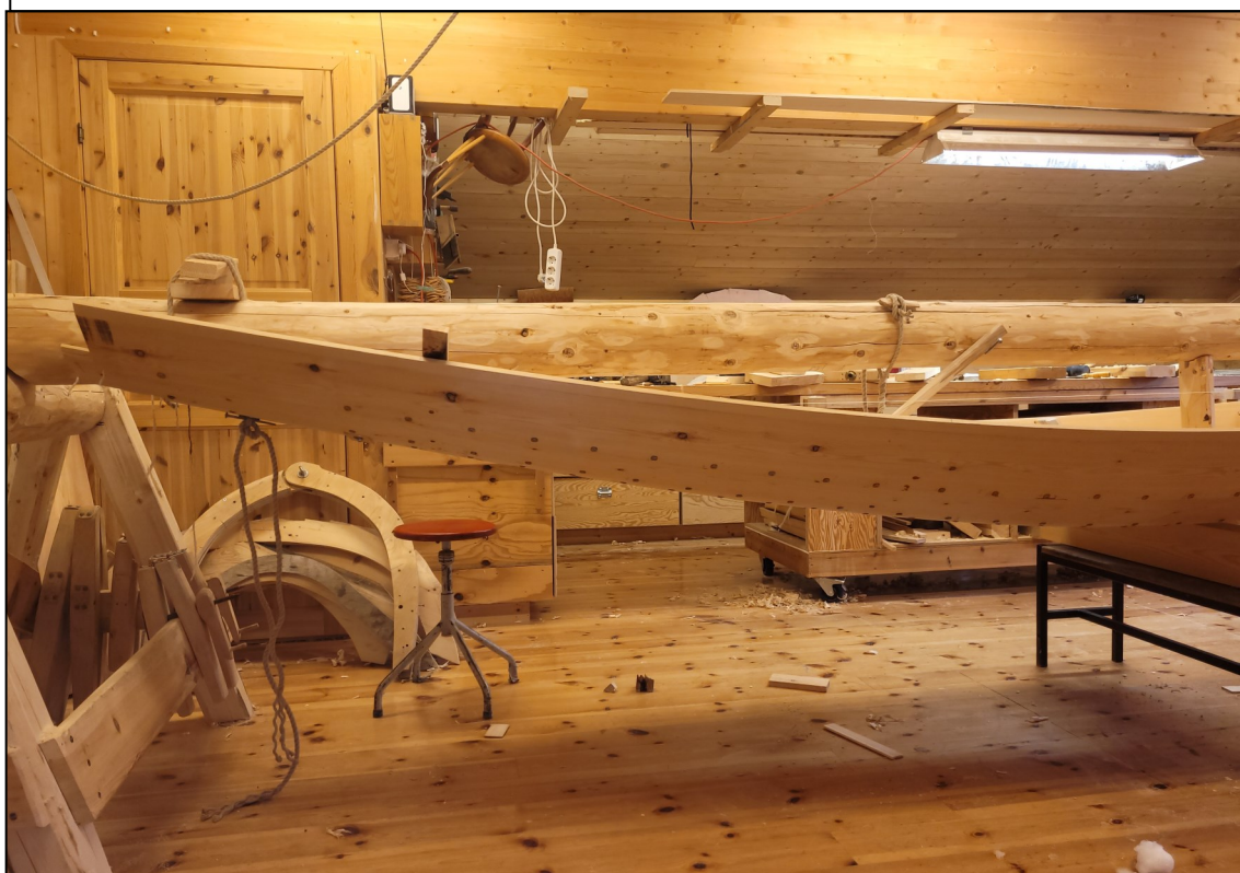
Fig. 44. Springet og formen på prammen har gjennom hele byggingen vært vanskelig å få øye på. Byggestokken har vært til hinder for dette.
