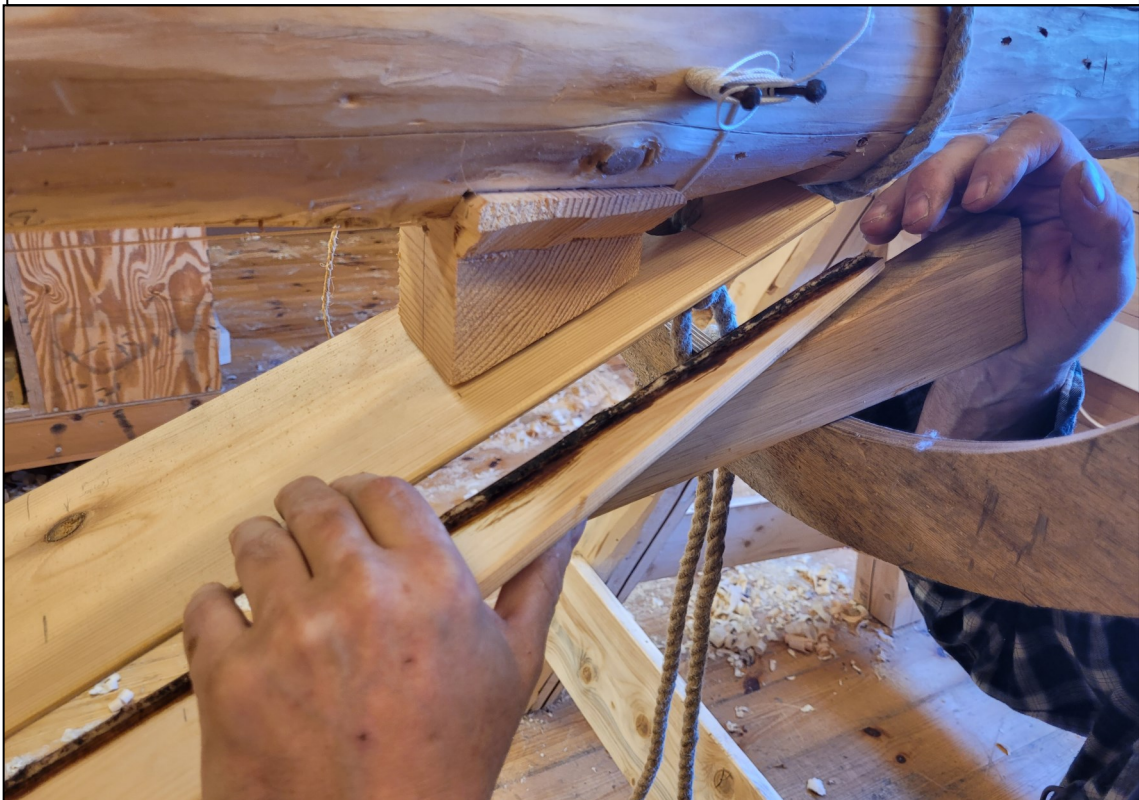
Fig. 28. Framme ble bordet klemt opp med en kile mot støttespantet.
