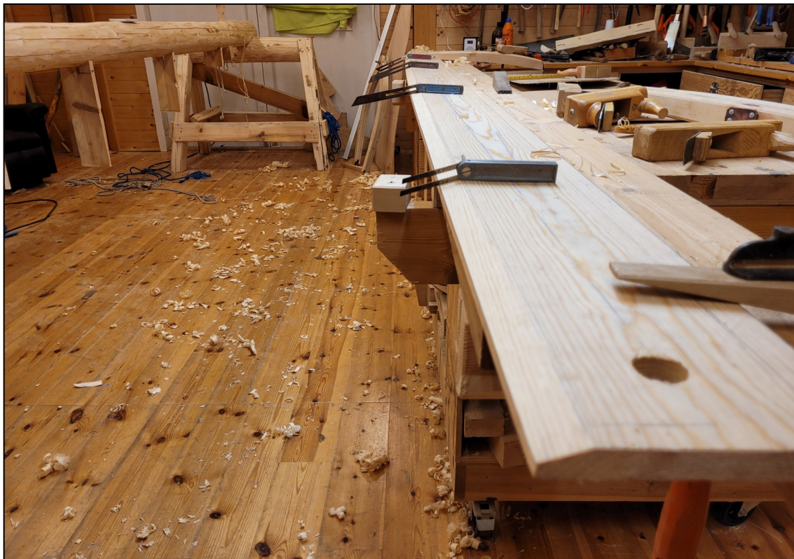
Fig. 15. Vinkelen ble overført fra modellspantene til prambordet. Det ble laget et modellspant for hvert av de 5 målepunktene. Målepunktene er alle satt inntil hvert av banda.
