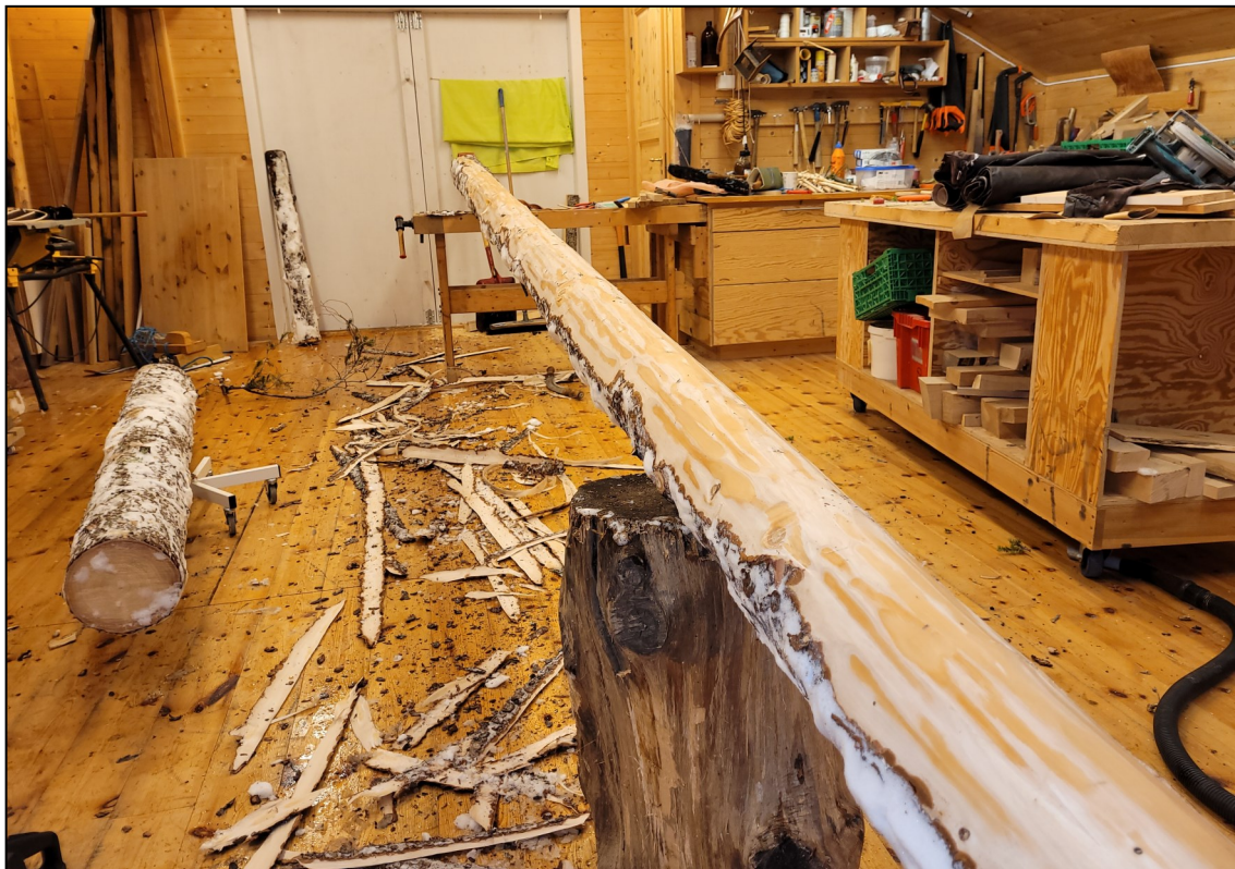
Fig. 1. Grana til byggestokken ble felt få dager før byggingen startet. Granstokken var rettvokst og uten store kvist. Stokken burde ha vært tørr eller ferdig med vridningsbevegelser. Dette ble kompensert for gjennom å leite opp den mest rettvokste grana på tomta.
