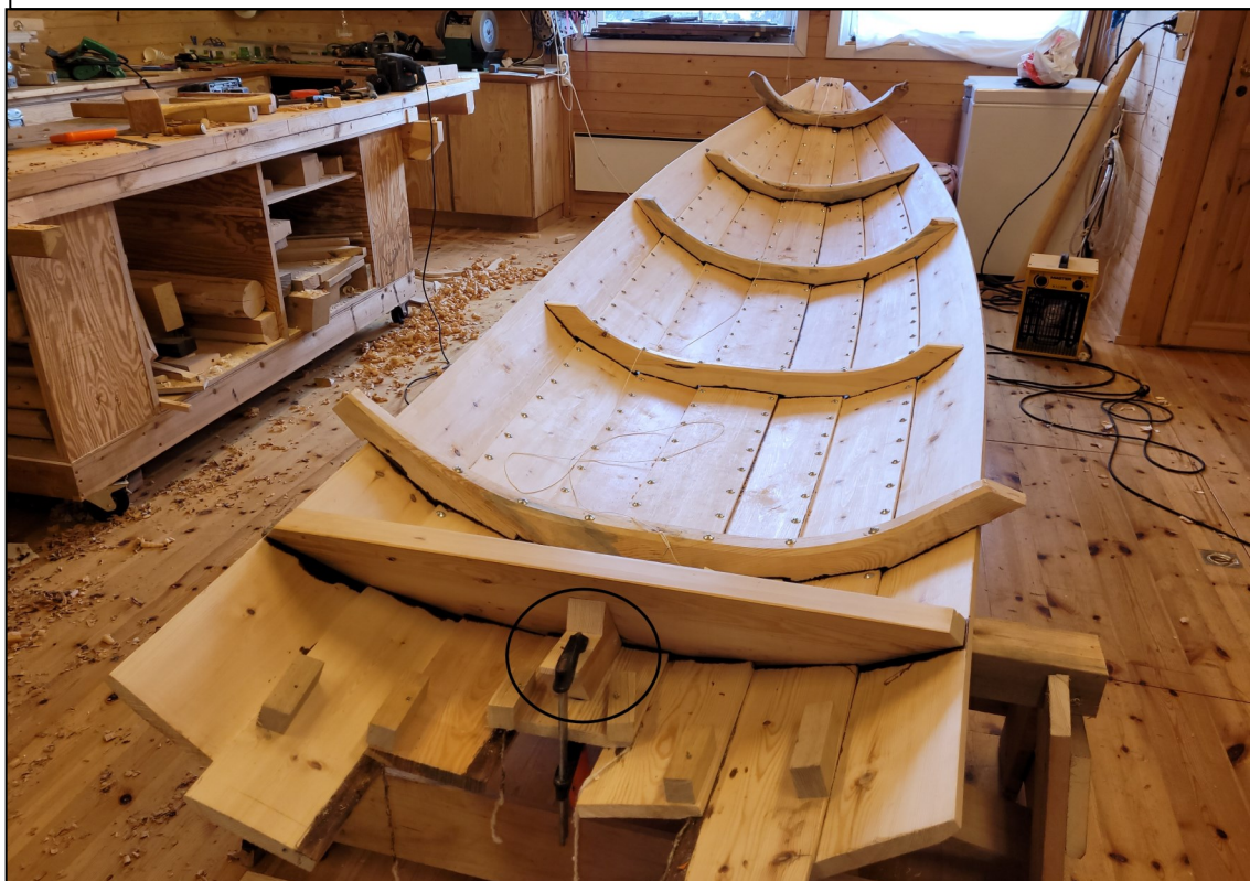
Fig. 46. Nedre delen av akterspeilet felles ned etter en fast vinkel fra oppmålingen. Nedre del avsluttes en tomme over tredje bordgang. Under byggingen var det greit å ha litt overlengde på borda. Dette ble sagt av når borda var ferdig spikret i speilet.
