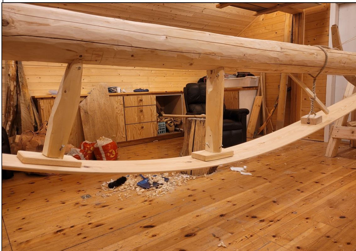
Fig. 16 Prambordet var ferdig høvlet, kantene brukket og brunfelling på plass. Den endelige plassering av skorer og opptrekk er bestemt. Prambordet ble festes framme først og ble deretter bøyd opp bakover, over den akterste skoren. Når bordet var festet bak, ble den fremste skoren satt og opptrekket vinnet opp. De midlertidige avstandsstykkene var nå fjernet.
