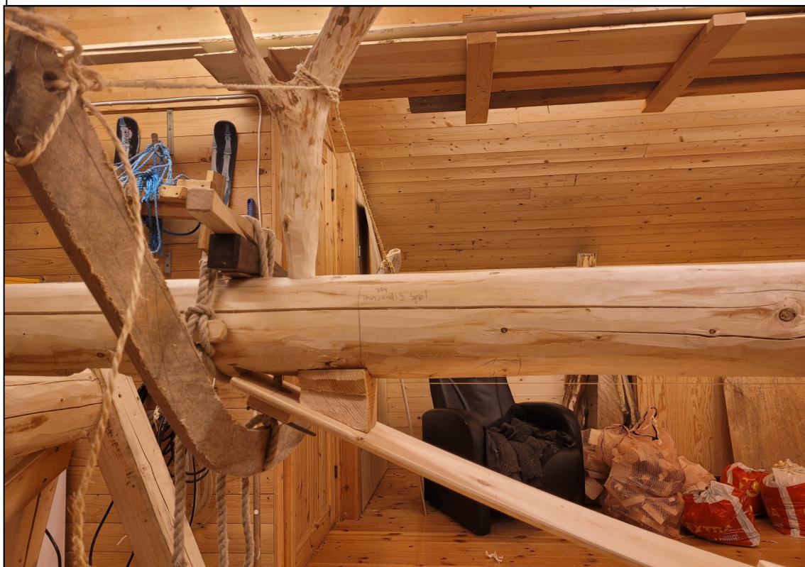
Fig. 12. Fotografiet til Stigum viste ikke hvordan støttespantet framme var utformet. Jeg laget det som et fast støttespant for også å kunne prøve et slikt ut. Ved å aktivt bruke tauet opp til tårnet kunne også dette støttespantet justeres. Det fungerte greit under byggingen av Lårdalspramkopian, men det har trolig vært laget delt slik som støttespantet bak.
