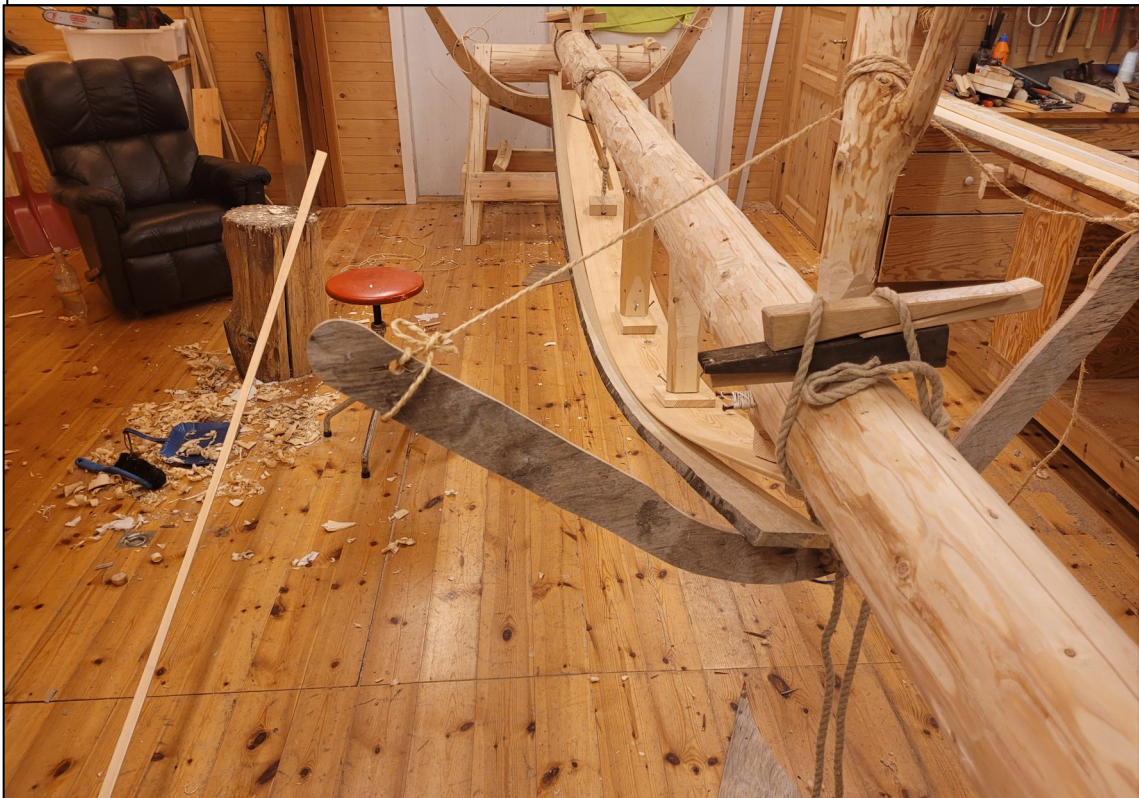
Fig. 18. Et vrakbord ble brukt som malbord for å avtegne underkanten på den neste bordgangen. Malbordet måtte bøyes helt opp og festes tett inntil foregående bord før det kunne vise det neste bordets sanne form.
