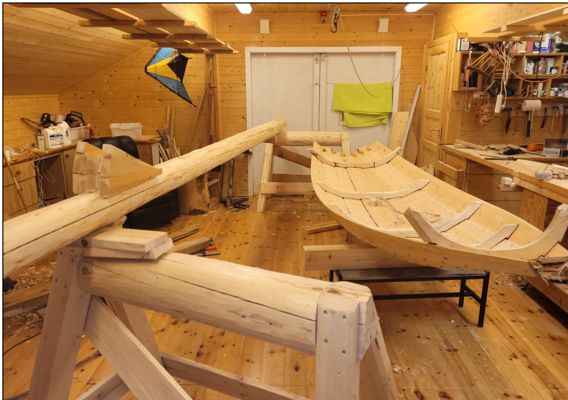
Fig. 45. Jeg var usikker på om prammen ville strekke seg ut og miste noe av formen når den ble løsnet fra byggestokken. Før prammen ble sluppet løs, strakk jeg en snor mellom framband og det akterste bandet. Fra snoren målte jeg ned til et avmerket punkt i bunnen av båten. Etter to dager var det fortsatt ingen endring på målet. Prambunnen var formstabil.
