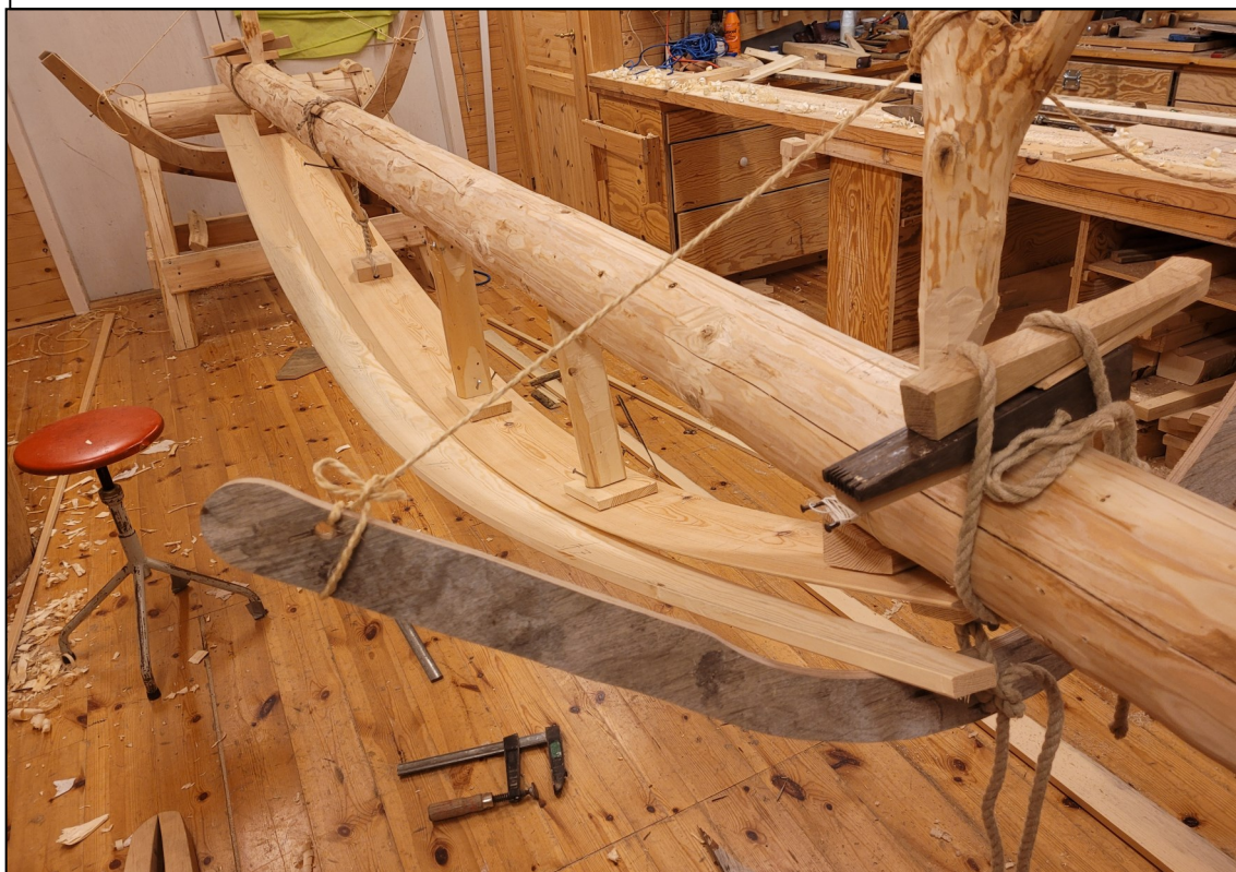
Fig. 22. Både fremme og bak ble bordet liggende med en glipe på 10 cm. Uten båtklemmer ble ikke bordet liggende på plass hvis støttespantet ble hevet ytterligere. Med støttespantet festet høyere opp mot prambordet økte vanskeligheten med å få bordet på plass. Med vidje til innfesting av støttespantet ville høyden vært fiksert og ikke regulerbar. Etter noen forsøk med forskjellige høyder, festet jeg støttespantene permanent.
