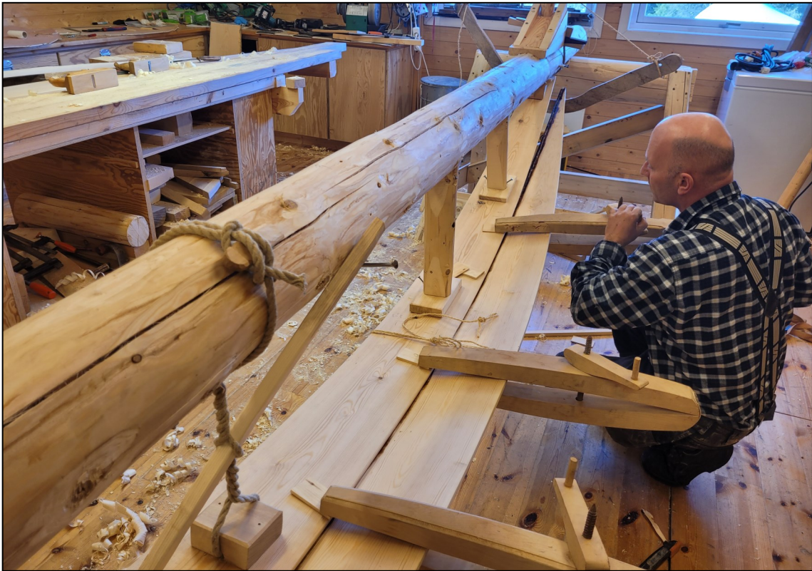
Fig. 27. Bordet festes fra midten og ut mot hver ende. Jeg vet ikke hvordan båtbyggeren, i 1943, festet bordene. Jeg brukte båt-klemmer med aner i Hardanger. Klemmene viste seg å være for store og bak-tunge. Det endte med at jeg modifiserte fire av klemmene slik at de ble lettere og kortere.
