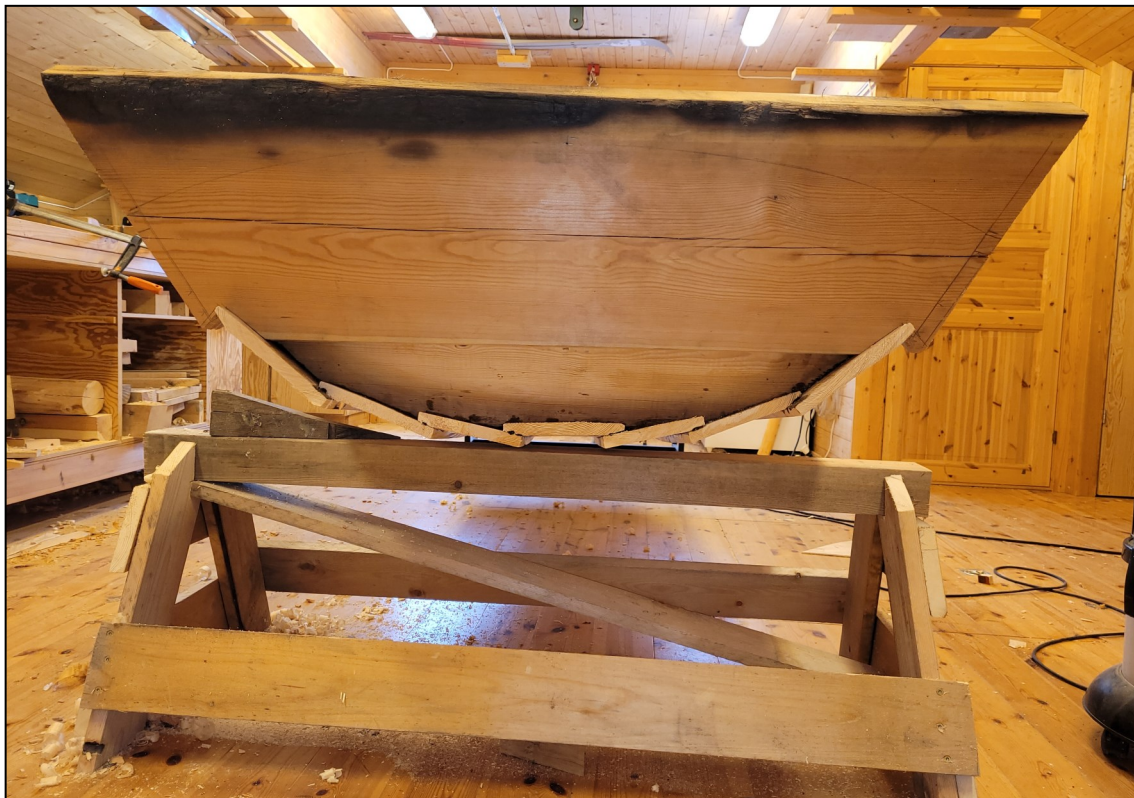
Fig. 47. Akterspeilets øvre del ble felt på plass på utsiden med en overlapp tilstrekkelig for spikring til underspeilet.
