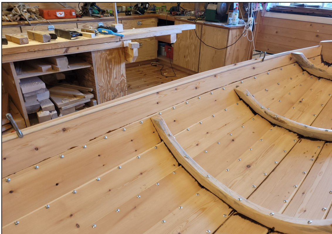
Fig. 51. Før opplengerne ble lagt inn ble den øvre bordgangen og springet siktet til.
