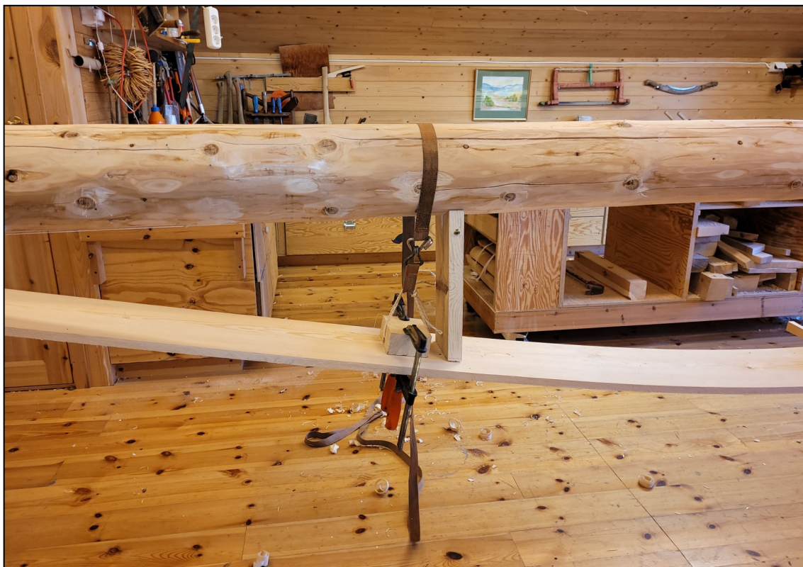
Fig. 9. Opptrekket. Klossen var midlertidig festet med tvinger. Sammen med skorene ble dette punktet også flyttet en del før plassering ble bestemt. Under utprøvingen ble trekket ble justert med lastestrammere. Det vanskelig se på fotografiene til Stigum hvordan denne klossen var festet. Trolig var det en form for jernbolter som ble brukt. Jeg brukte ordinære treskruer med store skiver på undersiden av prambordet.
