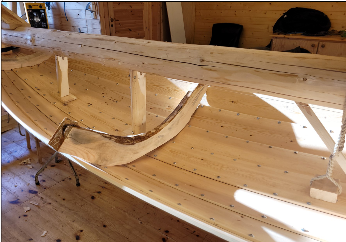
Fig. 38. De fleste banda i Lårdalsprammen er grenkroker. På større prammer har rotkroker slik som denne også blitt benyttet. Mine materialer var ikke prima og heller ikke tørre nok. Planlegging og innhenting av emner til innved har vært gjort i god tid, gjerne mer enn ett år før bygging.
