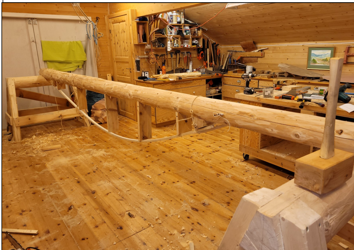
Fig. 4. Byggestokken ligger løst ovenpå bukkene. I rotenden (bak) er stokken avflatet på undersiden. Reien viser nå samme fasong som prambordet skulle få.
