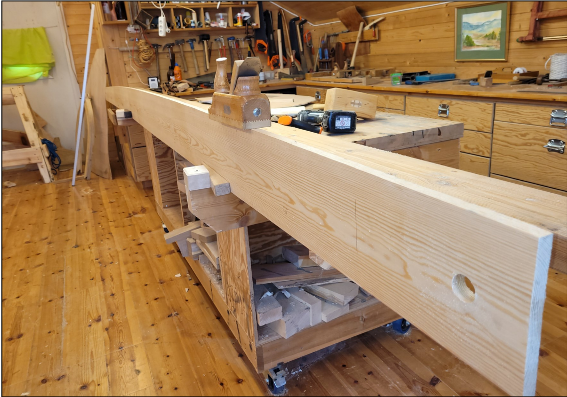
Fig. 13. Prambordet i arbeidsbenken. På Stigums fotografier var det avbildet en enkel arbeidsbenk, bred og lang nok til å legge et båtbord. På siden kunne båtbordet festes enkelt med kiler. Arbeidsbenken ble laget av to bord på til sammen 12 x 2 tommer. Framme på benken var det montert en kloss med noe som så et ut som et kileformet hakk. Jeg lagde en slik, men fant aldri ut hvordan den kunne brukes. Den kan ha vært brukt til å kile fast band for høvling av flatsidene eller ha fungert som en bordstopper.
