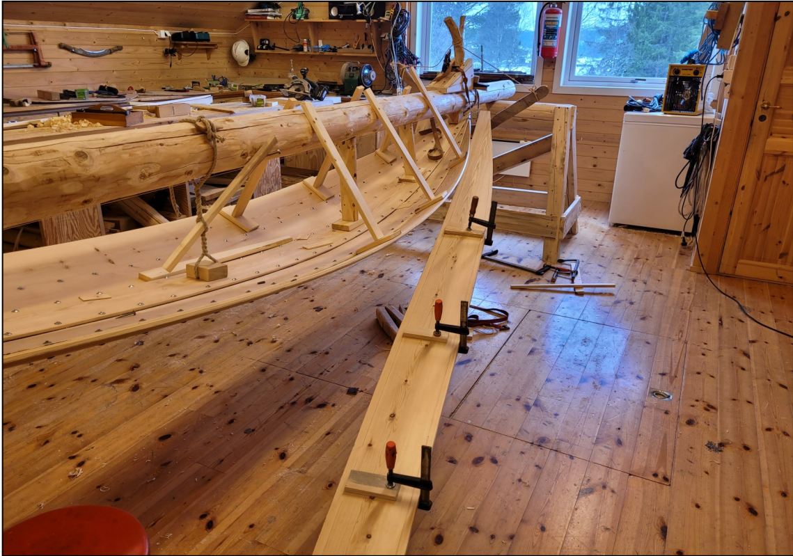
Fig. 35 Underveis ble det forsøkt å feste bordet fremme for så å bøye det på plass bakover. Det fungerer ikke. Prammen hang under byggstokken som en kirkeklokke. Ved ensidig press på denne måten, vippet prammen til siden og byggstokken rullet uten stor nok motstand til å få bordet på plass.
