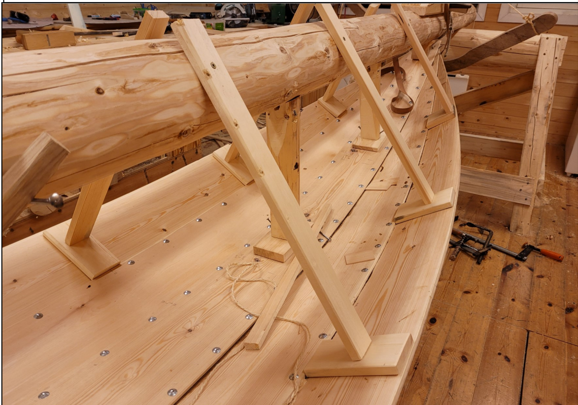
Fig. 34. Før tredje bordgang skulle bøyes på plass, gjorde jeg et forsøk med å stabilisere formen fram- me i prammen. Skorene bøyer ikke ut eller former boardet, men holder boardet på plass slik at det mot- står innbøyning fra neste bordgang som skal på. Metoden kan ha vært brukt.
