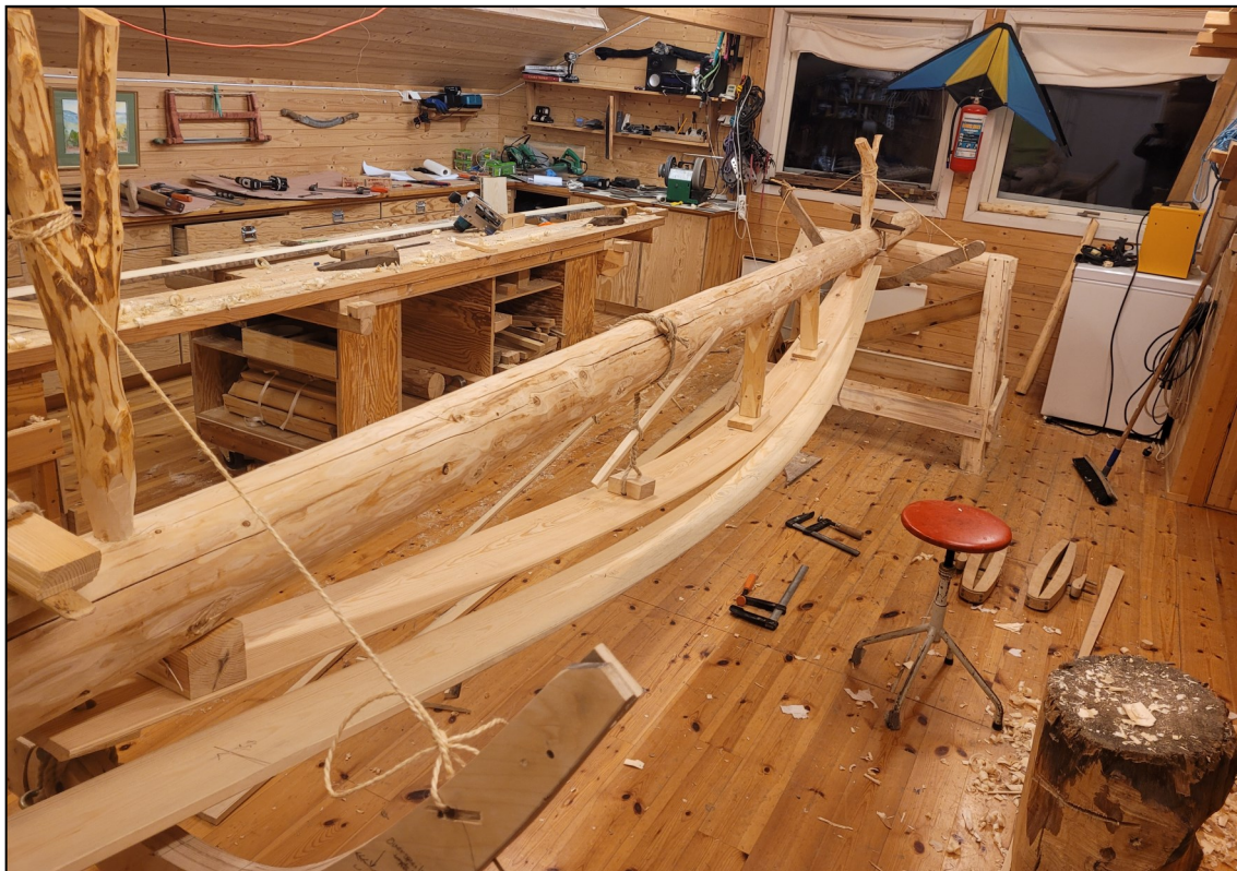
Fig. 21. Det første bordet ble lagt opp i støttespantet på hver side og ble bøyd ned under prambordet. Underveis ble det prøvd ut forskjellige høyder og vinkler på støttespantene.
