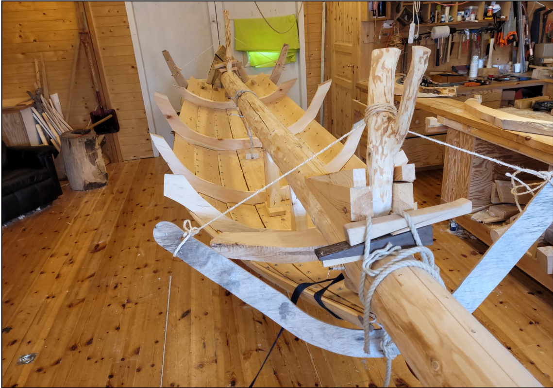
Fig. 37. Med tre bordganger på plass var det på tide å felle banda ned i prammen. Hjelpespantene blir brukt som maler for å finne emner til banda.
