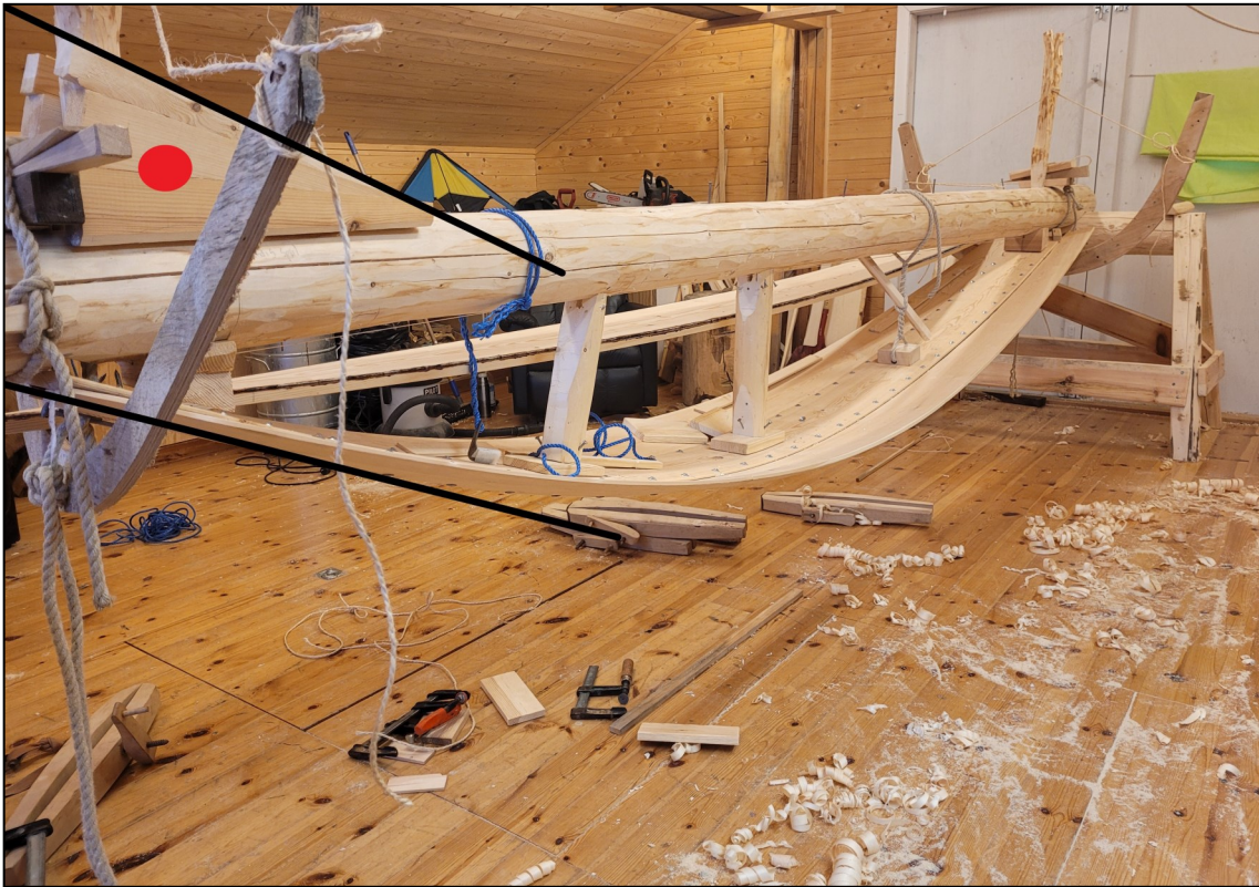
Fig. 29. Begge bordgangen i første omfar på plass. Trekantklossen var festet ved fremre tårn (rød prikk). Trekantens øvre flate dannet en nesten parallell linje med båtbordene og gjorde det enklere å bruke tau for å vinne opp den siste glipen mellom bordene.
