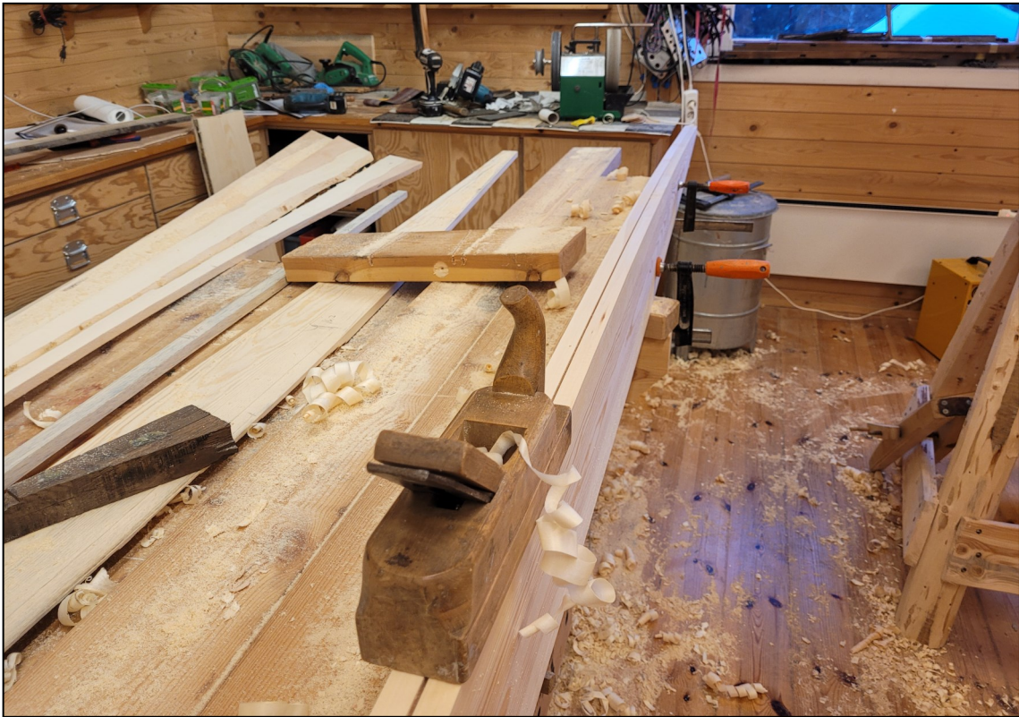
Fig. 19. På Lårdalsprammen var det forskjeller på bordbreddene fra side til side. Det varierte opp mot 3 cm. Jeg valgte å lage bordene like etter et gjennomsnitt av oppmålingen. Bordene ble stukket ut og høvlet som par. Bredden på sua varierte også. Båtbyggeren har trolig improvisert og har i liten grad høvlet bordene som par.
