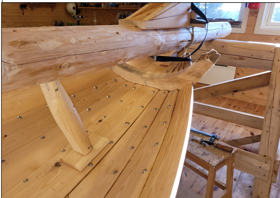
Fig. 40. Med et bredere prambord ville det vært lettere å feste frambandet. Både klinking av søm og felling av band var utfordrende oppunder byggestokken.
