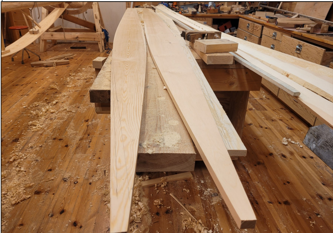
Fig. 20. De første to bordgangene gikk nesten i en spiss opp mot framspeilet. De to neste bordgangene bygde høyde. Bredden på bordene var størst ved ro-toften. Det er her prammen har størst behov for volum og oppdrift. Den lille tjønnprammen har trolig vært brukt mest med en person ombord. Bruken av båter er viktig for å forstå formen.
