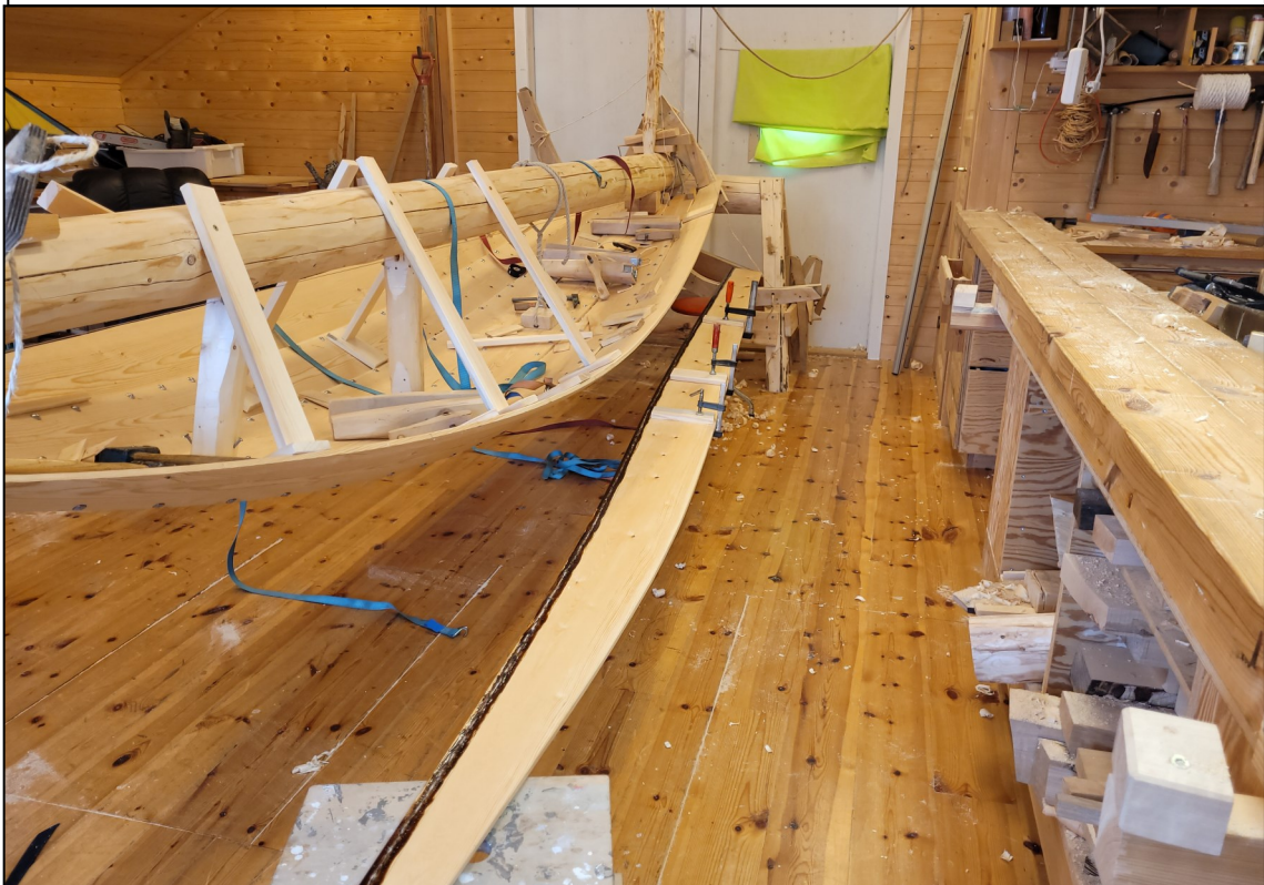
Fig. 36 Som i fig 35 ble det også forsøkt å feste bordet bak først. Det fungerte like dårlig.
