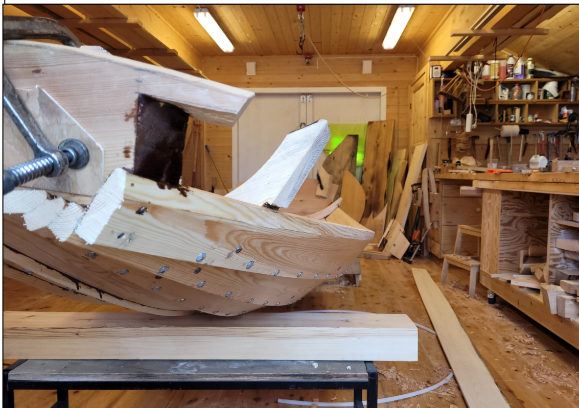
Fig. 50. Framspeilet er ferdig felt og det er satt av nok gods slik at den øvre delen av speilet kan dekke over øverste bordgang. Tilsvarende beskyttelse av øvre bordgang var det også på Lårdalsprammen. Det var noe mer tungvindt å gjøre det slik, men det var trolig viktig å kunne beskytte den øvre bordgangen mot tråkk.
