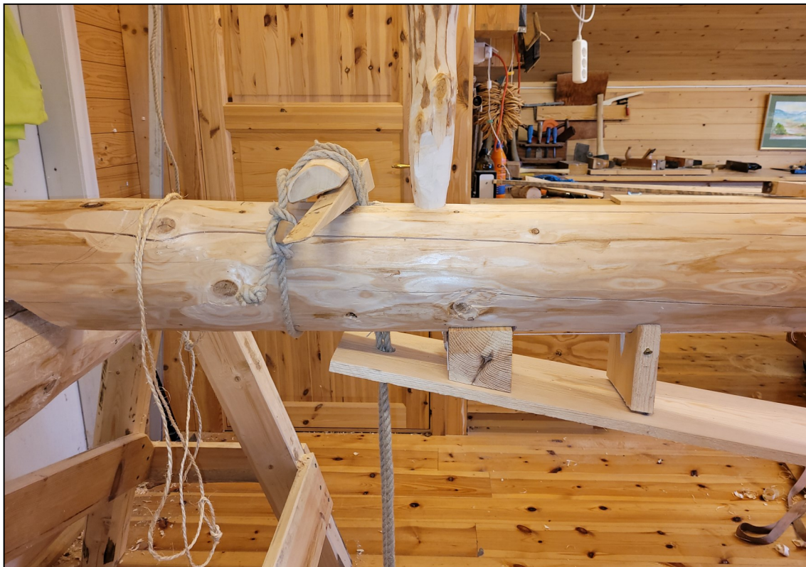
Fig. 5. Innledende forsøk med innfesting av et grovt tilskjært prambord. Det ble tidlig klart at den lille tjønnprammen hadde for smalt prambord til at innfesting med to hull og vidje ikke var gjennomførbar. Jeg valgte i stedet å bore et hull i prambordet og et tilsvarende i byggestokken. Tauet løper dobbelt opp igjennom hullet for så å knytes rundt byggestokken. Prambordet strammes opp ved å slå kiler under løkken på tauet. På tilsvarende måte som det ble det ble brukt kiler til å stramme opp vidjene på Stigums fotografi.
