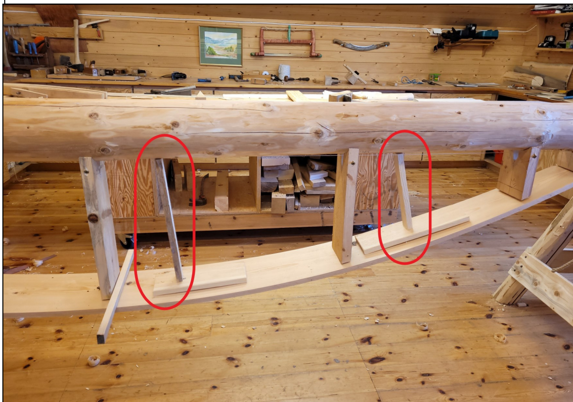
Fig. 8. Utprøving av skoreplassering. Både lengde på skorene og plassering ble undersøkt. Etter en rekke forsøk som også innbar at opptrekket (Fig.9.) ble justert, ble endelig plassering bestemt. Noen få millimeter luft under hvert av de midlertidige avstandsstykkene på samme tid var retningsgivende.
