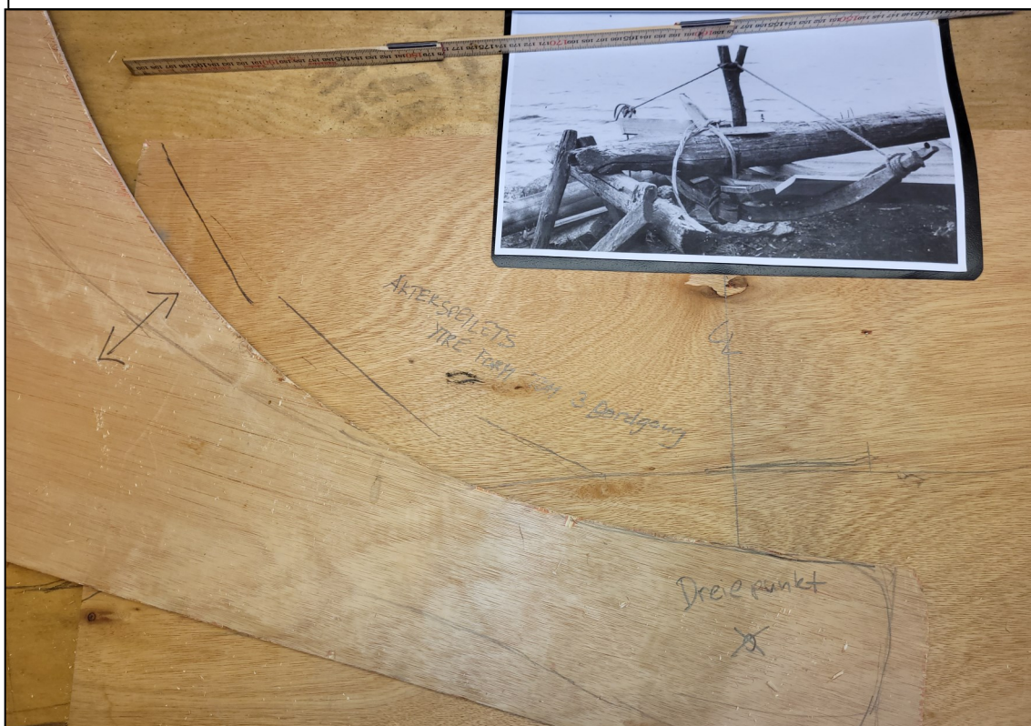
Fig. 10. Støttespantene ble laget av kryssfiner. Strekene markerte akterspeilets ytre side av bordgangene. Det ble konstruert et dreiepunkt og en bue som skulle kunne justeres slik at støttespantet i størst mulig grad kunne være parallell med overflaten av bordene.
