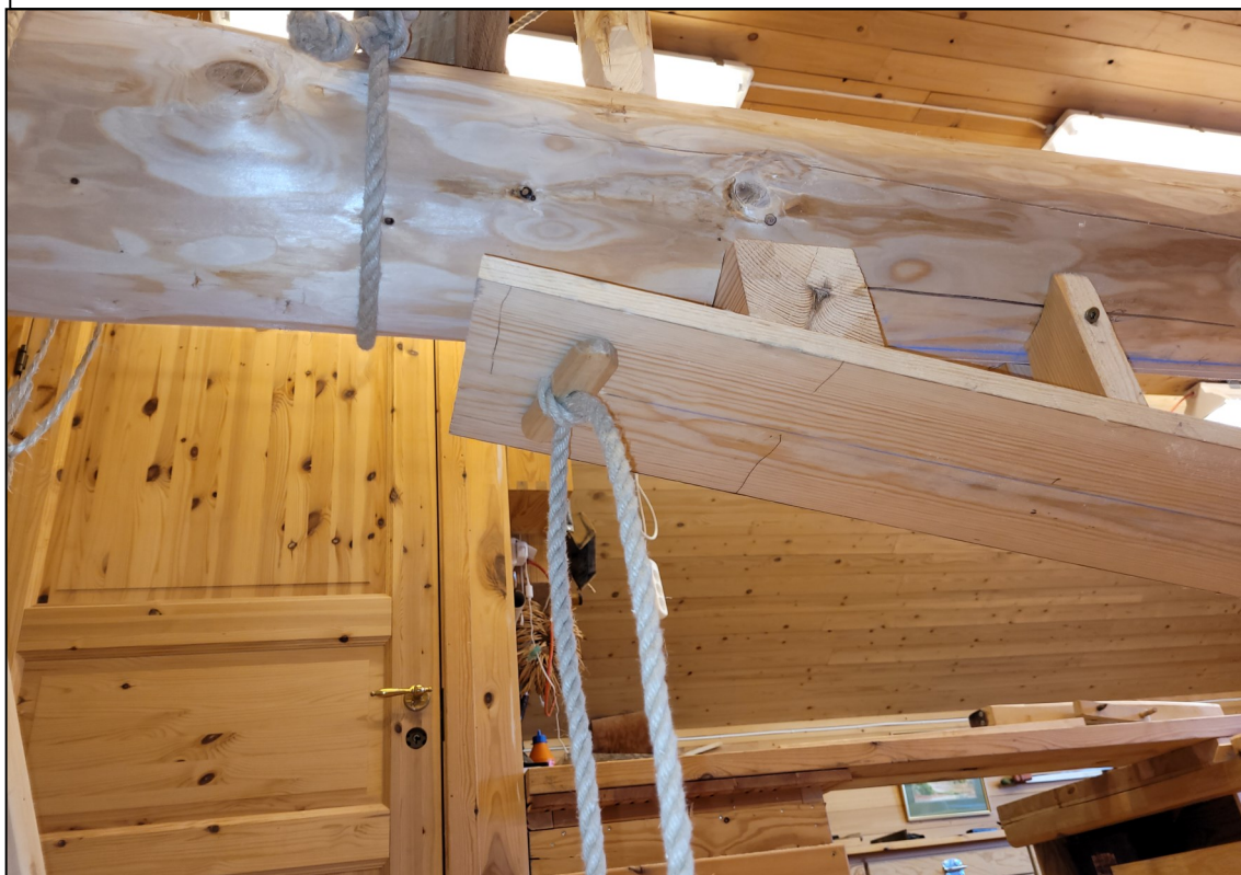
Fig. 6. På undersiden hindret en liten kloss løkken fra å trekkes ut. Klossen gav i tillegg noe tverrskips fordeling av kreftene som bordet ble utsatt for under oppspenningen. I klossen var det skjulpet ut et lite spor slik at tauet som skulle feste støttespantet ikke skulle skli og slik at støttespantet kunne monteres så nært prambordet som mulig.
