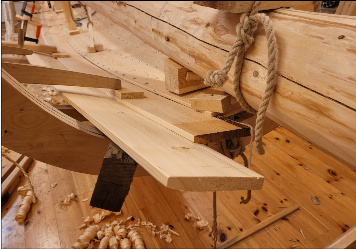
Fig. 31. Tilsvarende operasjon som på fig 30 kunne av og til også gjøres kun med en kile.
