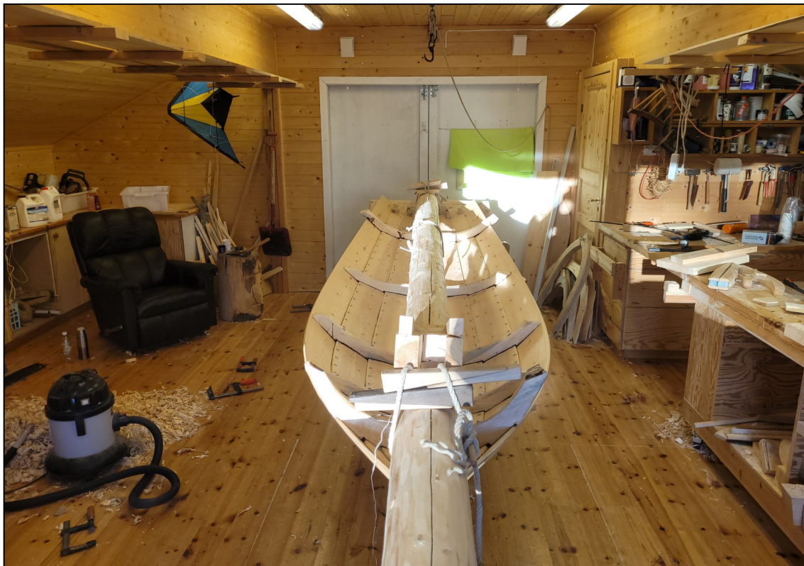
Fig. 43. Prammen var bordet til tredje bordgang. Banda var festet og prammen var klar til å bli sluppet ned fra byggestokken.
