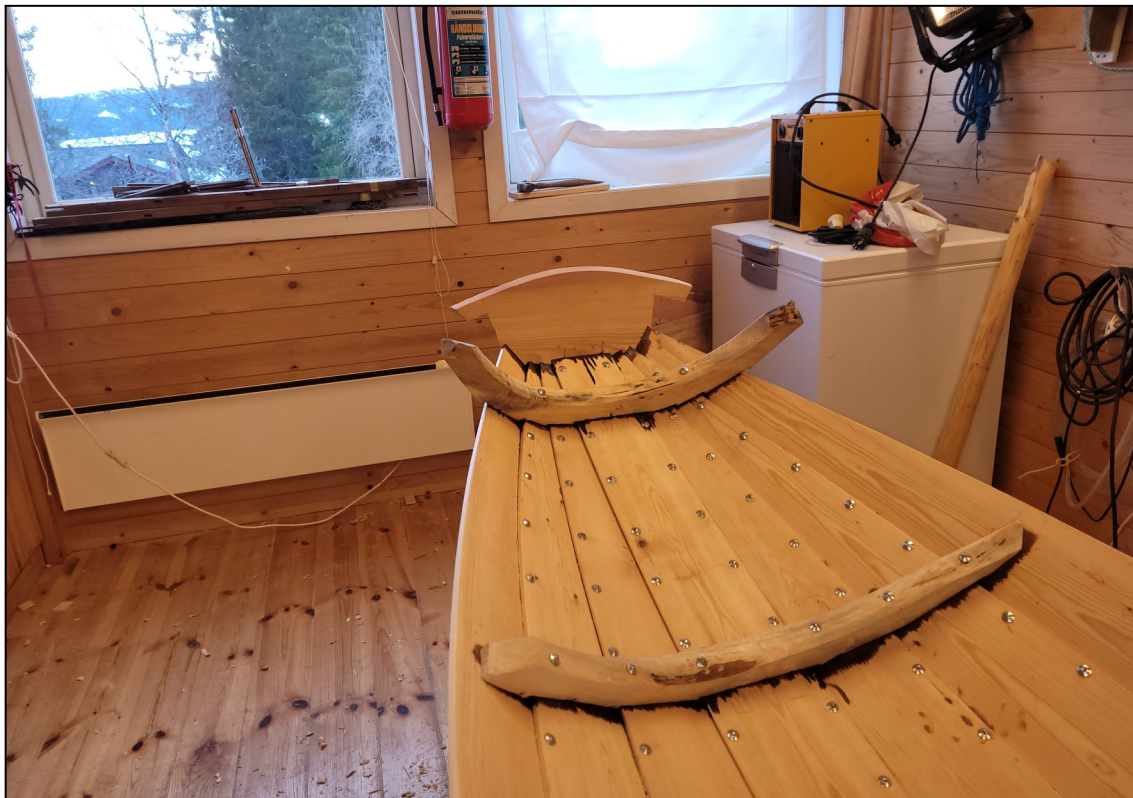
Fig. 49. På Lårdalsprammen var framspeilet delt, men spikret sammen til en plate i samme plan. De-lingen var ved tredje bordgang. Fellingen på Lårdalsprammen var ikke gjort med stor flid. Framspeilet skulle ikke ned under vann og behøvde ikke å være vanntett.
