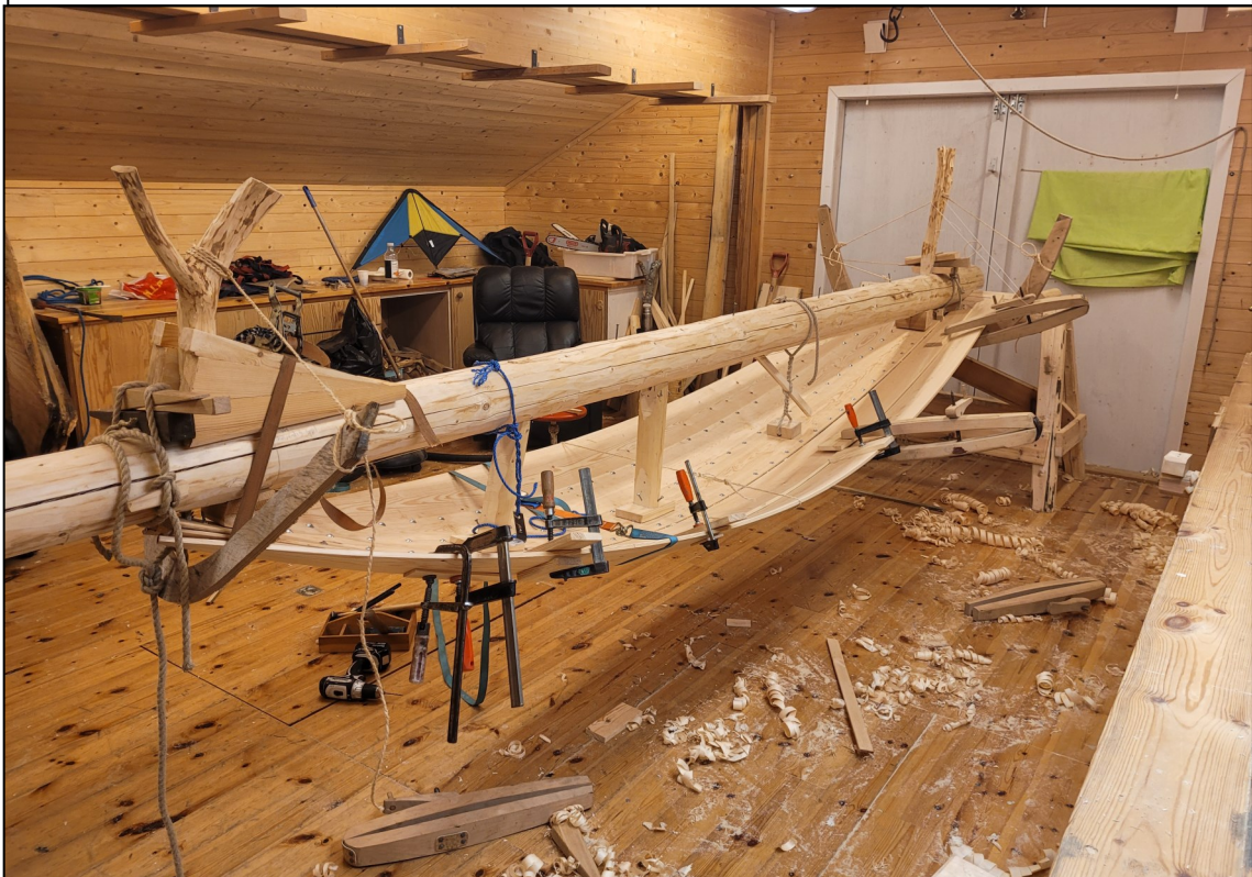
Fig. 32. Når bordene var sømmed, hadde ikke støttespantene lenger noen funksjon. Det gjorde at støttespantet fremme kunne slippes løs på den siden bordet var festet og dras ekstra opp på den siden det skulle et på nytt bord. Skruetvingene bortetter båtbordet holdt på plass en liten bordbit som markerte kanten på sua og hindret båtbordet fra å skli innunder forrige bordgang før det ble festet.
