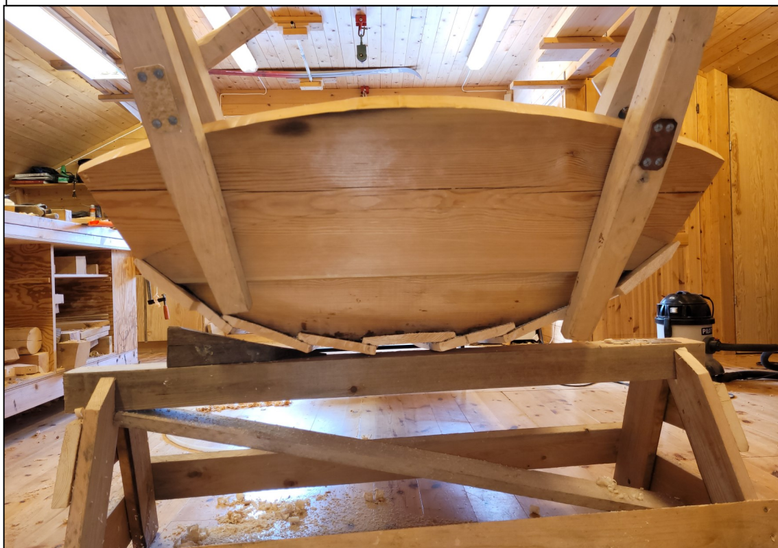
Fig. 48. Akterspeilet ble festet før fjerde og siste bordgang ble prøvd på.
