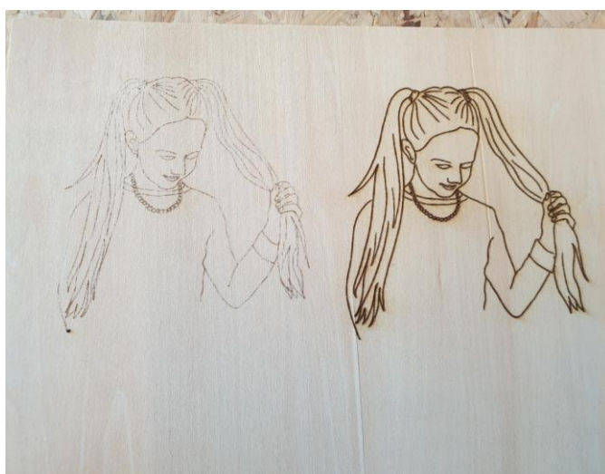
Bilete 27: Utprøving av laseregraving med ulik graveringsstyrke. Fil teikna på I-pad
