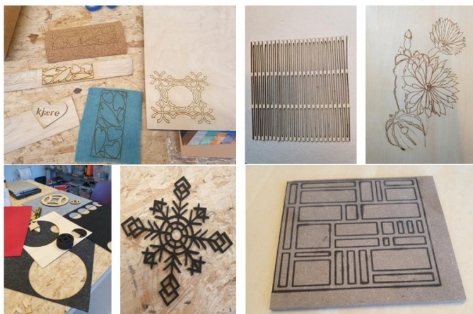
Bilete 26: Utprøving av ulike kutte og graveringsinnstillingar u ulike materiale. Her vist med filt, ull, trefiner, MDF og kork
