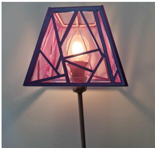
Bilete 36: Lampeskjerm utprinta i tofarga filament og fastprinta tyll undervegs i printeprosessen
