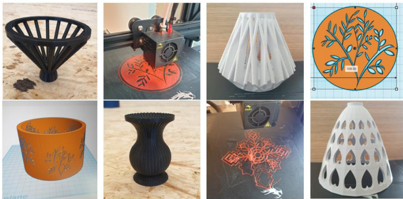
Bilete 19: Utprøving av 3d-printing , variasjon av teikna modellar og utprinting av vellukka og mislukka print
