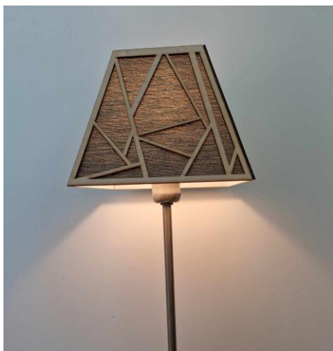
Bilete 37: Lampeskjerm utskore på laser i trefiner, tapet utskore på Cricut
