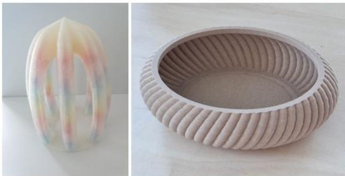
Bilete 22: Gjennomsiktig filament med farga glasperler tilført undervegs i printet, skål i trefilament
