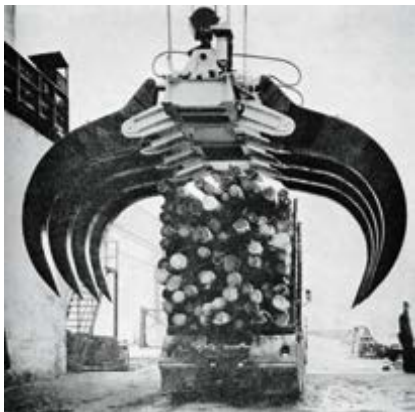
Skogbruk og tømmerforedling vedble lenge å være en vital kjede i Telemarks næringsliv. Også her ble arbeidsmetodene endret. Biltransport erstattet fløtingen, og mye arbeid ble mekanisert, som bruk av grabb ved tømmerlasting på Union Bruk, trolig omkring 1970. Foto: Fotograf ukjent. Fra Arnliot Strømme Svendsen: Union 1873–1973 , Aschehoug 1973, s. 217
