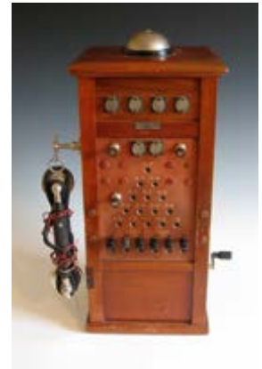
MANUELL TELEFONSENTRAL frå Porsgrunn i ei mahognikasse. Sentralen har to byliner og fire lokalliner. Sveiv på høgre side og rør på venstre side med ringebjelje på toppen. Foto: Fotograf ukjend / Telemark Museum
