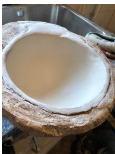
Figur 50. Gipsform med garnblåse som mal.
