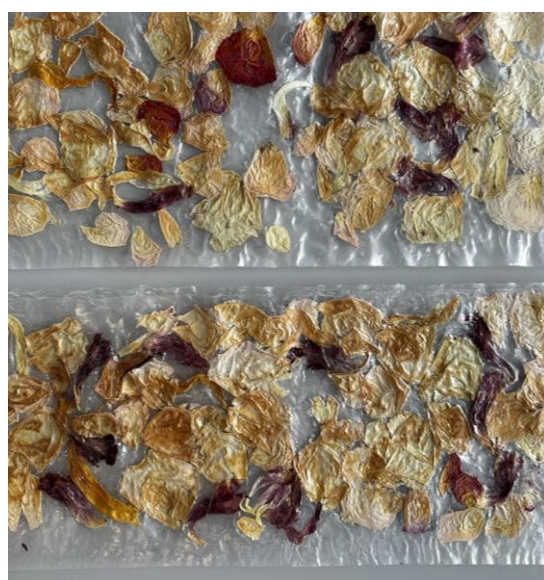
Figur 18: Utprøving med å «laminere» blomsterblande mellom to lag med 04 PE-LD.
