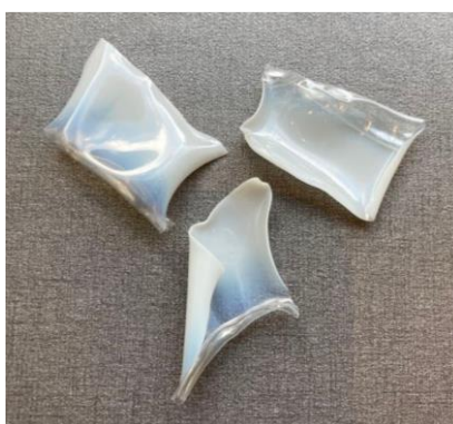
Figur 26: 01 PET varmebehandlet for å skape gradering.
