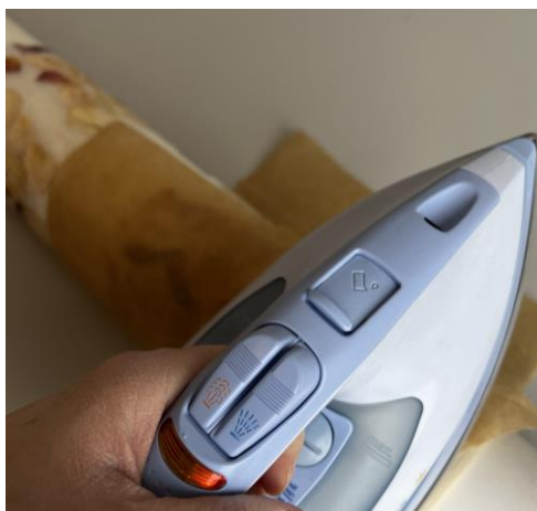
Figur 29: Viser hvordan man enkelt kan forme 04 PE-LD ved å stryke det rundt ønsket form.
