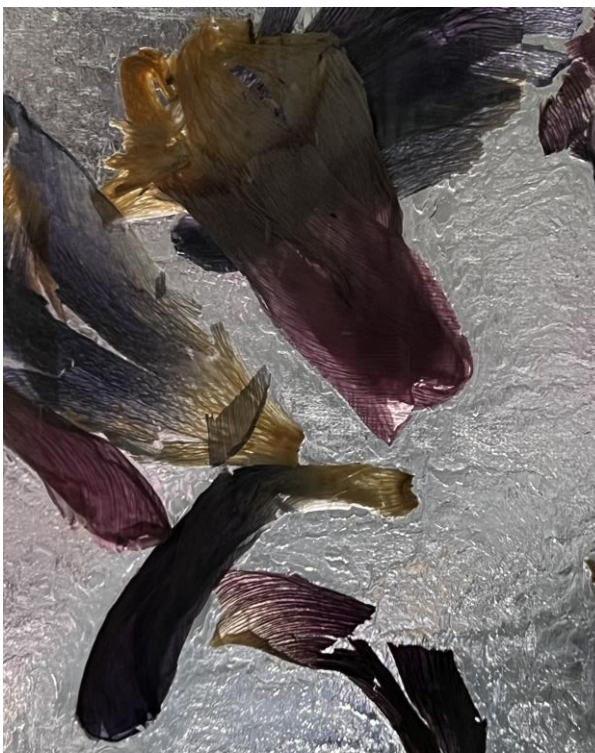
Figur 30: 04 PE-LD etter en varmeprosess med strykejern.
