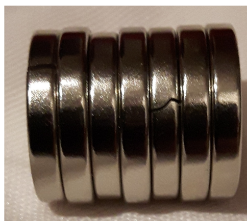
(b) Brudd i \varnothing 19 mm magnet plasser inne i sammensetningen.
