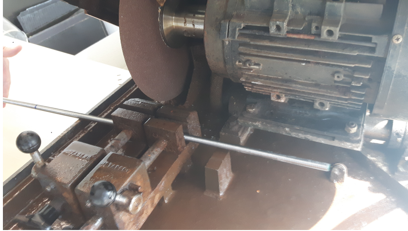
Figur 4.15. Kutting av gjengestang med våtsag.
