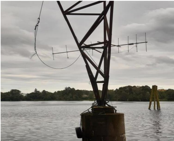
Figur 12. Antenner og datalogger utplassert ved utløpet til Falkumelva. Denne tok inn signaler fra fisk nedstrøms mot Hjellevannet og oppover mot Farelva, i tillegg til å dekke nedre del av Falkumelva.
