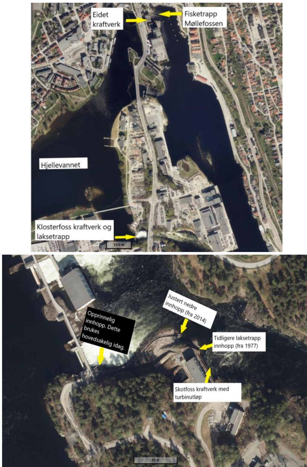
Figur 7. Øverst: Skiensfallene med Klosterfoss og Eidet kraftverk og fisketrappene i Klosterfoss og Møllefoss hvor fisk kan vandre opp fra brakkvann i Bryggevatnet og opp i Hjellevannet. Nederst: Skotfoss kraftverk og fisketrapp. De to nedre innløpene ved undervann Skotfoss kraftverk er ikke i bruk i dag.
