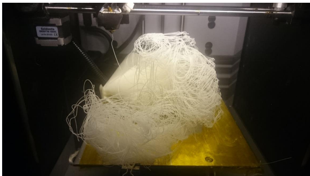
Figur 5: 3D-print hvor det har gått galt
