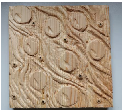
Figur 31: Planke 1, utskjært med multisliper
