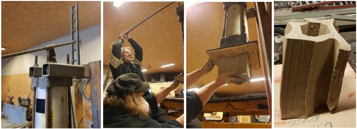
Figur 58: Viser montert jekktrapp med vektstangprinsipp. Figur 59: Visualiserer hvor mye kraft som må til for å utgjøre nok trykk i ekstruderen for å trykke massen gjennom åpningen, Stig Tore Rønning fra Mobilt Industriverksted bruker hele sin vekt ytterst på vektstangen, mens jeg tar imot den ekstruderte leira. Figur 60: Viser utpressing av masse, sett nedenfra. Figur 61: Viser utpresset modul
