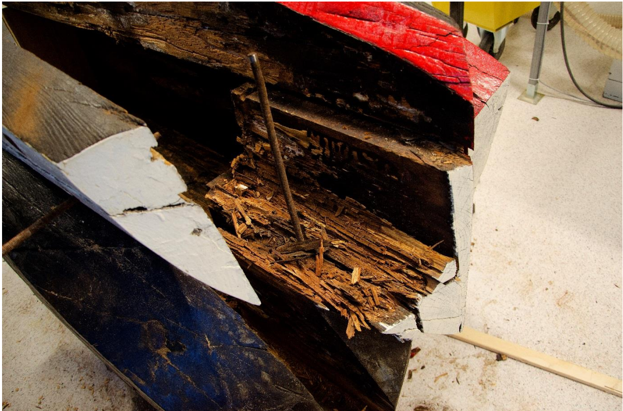
Illustrasjon 6: Bildet viser at trevirket i toppen av skulpturen er så dårlig at det ikke lenger henger sammen. Dette var ikke synlig ved besiktigelse, i og med at selv toppflaten fremsto ganske hel. Det var derfor noe overraskende at treverket bare var helt i de to-tre øverste centimeterne.
