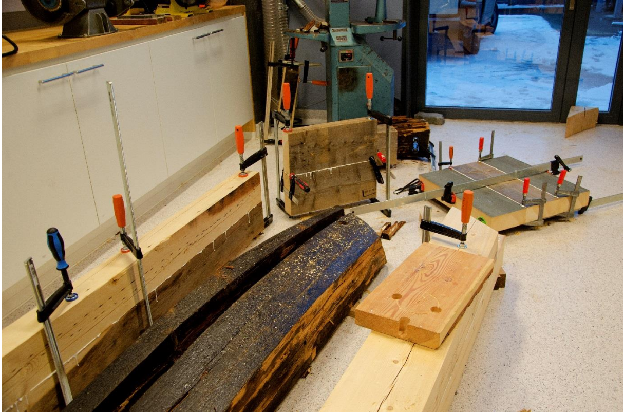
Illustrasjon 8: Bildet viser deler som er demontert fra skulpturen og nye tremner i tilsvarende proporsjoner og materialkarakter.
