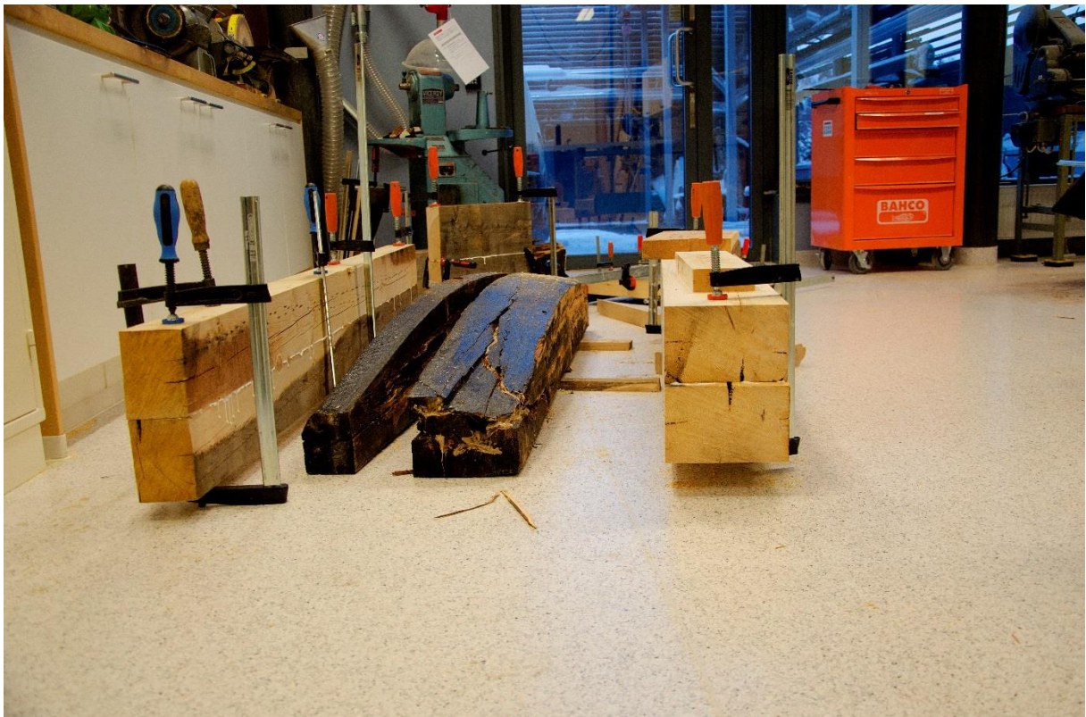
Illustrasjon 7: Bildet viser deler som er demontert fra skulpturen og nye treemner i tilsvarende proporsjoner og materialkarakter.
