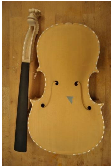
Figur 13 Innfelling. Halsen klar for innfelling, etter å ha berekna høgder og vinklar. Eige foto.
