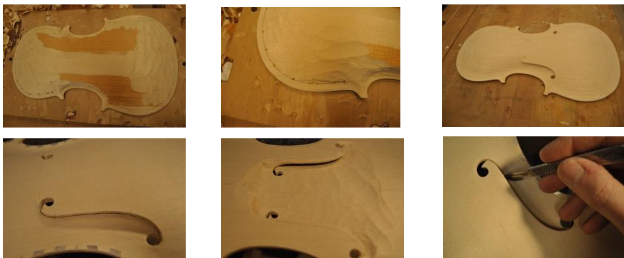
Figur 10 Hardingbratsjløk. Ulike fasar av arbeidet. Eige foto.
