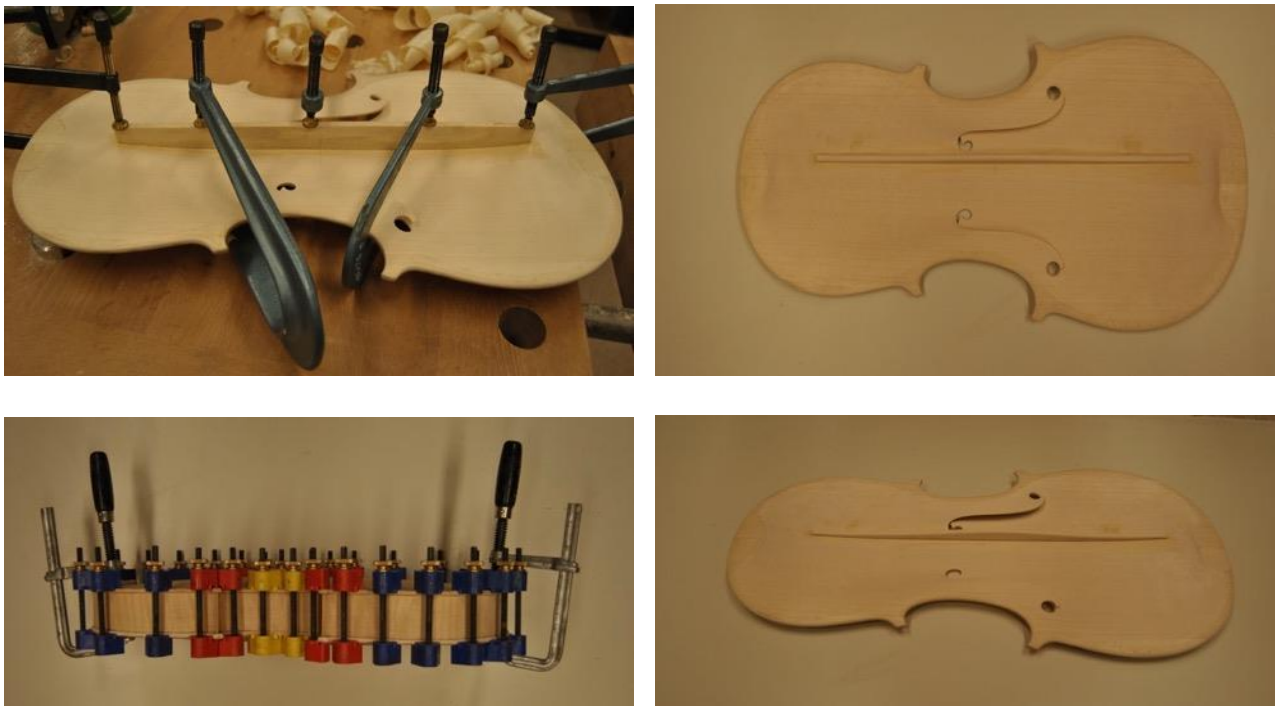
Figur 11 Basbjelke. Lima inn og forma, og løket deretter lima fast til sarg og botn. Eige foto.
