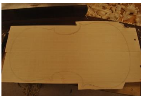
Figur 9 Gran frå Tinn. Ståande årringar og fiberretning liggande langs kvelvingane. Eige foto.
