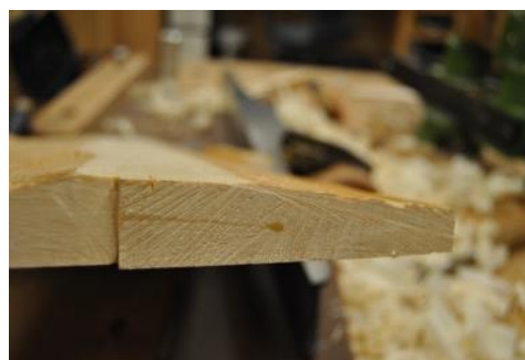
Figur 9 Gran frå Tinn. Ståande årringar og fiberretning liggande langs kvelvingane. Eige foto.
