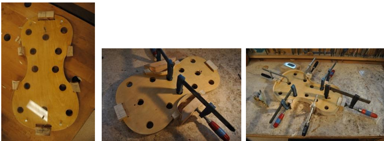
Figur 5 Sargform og sargar. Indre form brukt som konstruksjonsmetode. Eige foto.
