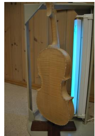
Figur 14 UV- ljós. For farging av treet. Eige foto.
