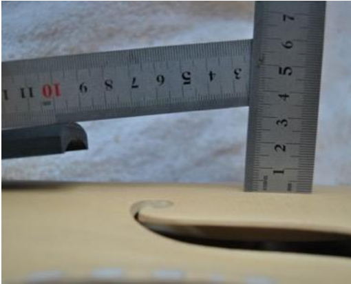
Figur 13 Innfelling. Halsen klar for innfelling, etter å ha berekna høgder og vinklar. Eige foto.
