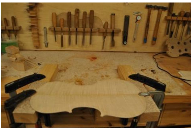
Figur 8 Indre arbeid. Utarbeiding av tjukkelsar i botnen. Eige foto.
