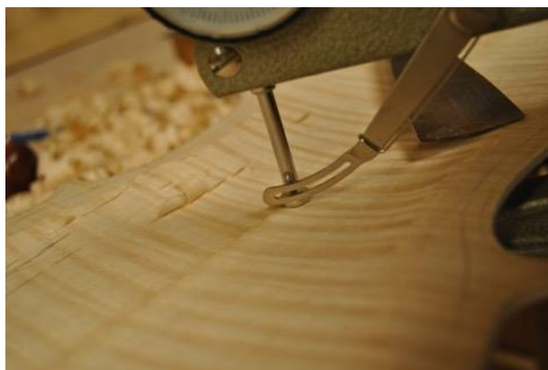
Figur 8 Indre arbeid. Utarbeiding av tjukkelsar i botnen. Eige foto.
