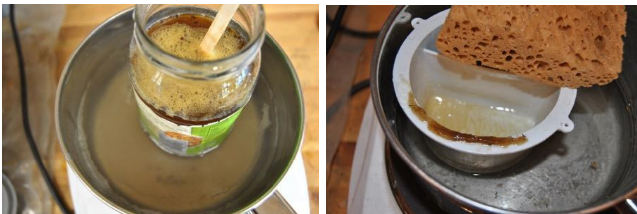
Figur 16 Blanding av spritlakk (venstre) og limgrunning (høgre). Eige foto.
