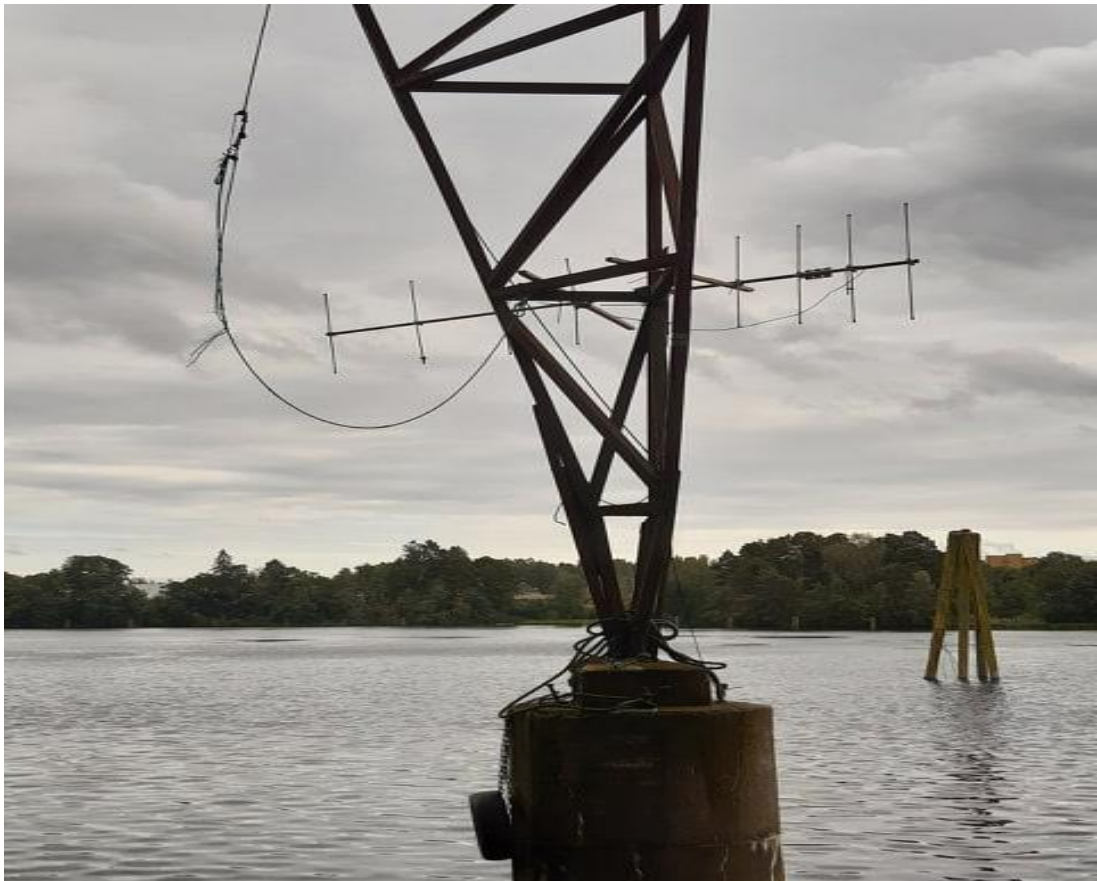
Fig 2.6. Antenne og datalogger 2, utplassert ved utløpet til Falkumelva. Denne tok inn signaler fra fisk nedstrøms mot Hjellevannet og oppover mot Farelva, i tillegg til å dekke nedre del av Falkumelva.
