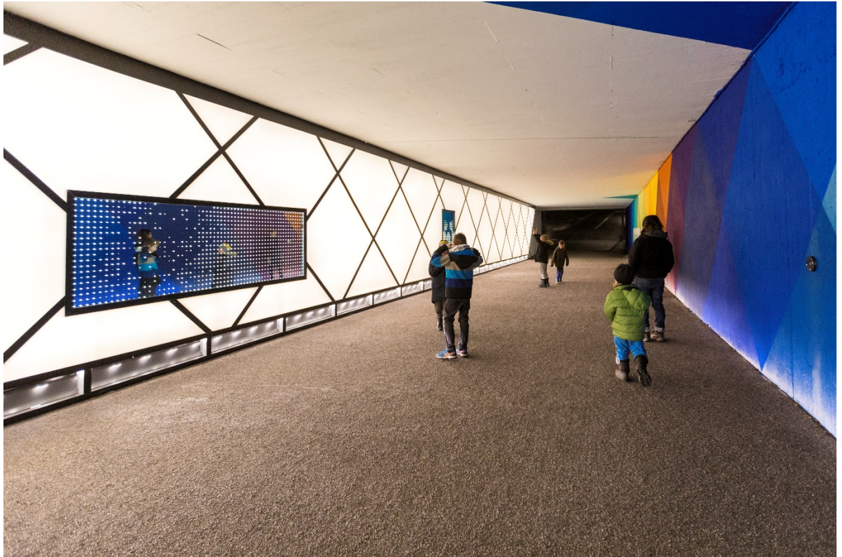
Figur 5 Belysning i undergangen på Lindeberg. Den jevnt belyste sideveggen gir et behagelig lysmiljø i gangtunnelen. Foto: Tomasz Majewski
