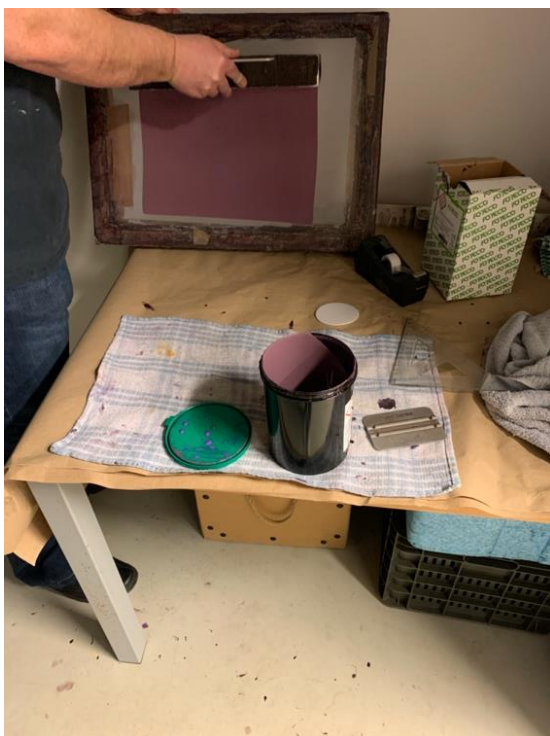
Figur 82: Legge fotoemulsjon på ramme
