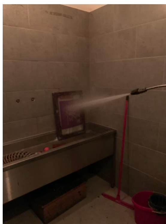
Figur 85: Skylling av ramme fra fotoemulsjon
