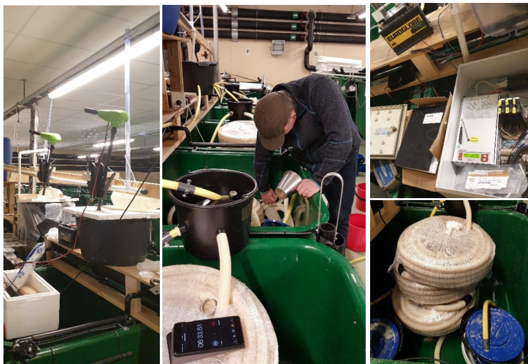
Figur 2. Bilder av forsøksoppsettet ved Syrtveit settefisk anlegg. Venstre: Røreverk for kalk-slurry (elektroske påhengsmotorer). Midten: Tidskontroll av forsøksvann til ulike kar med ulik oppholdstid. Høyre øverst: Kontinuerlig pH styring/logging. Høyre nederst: Fiskeeksponeringskar med 60 min-slange.
