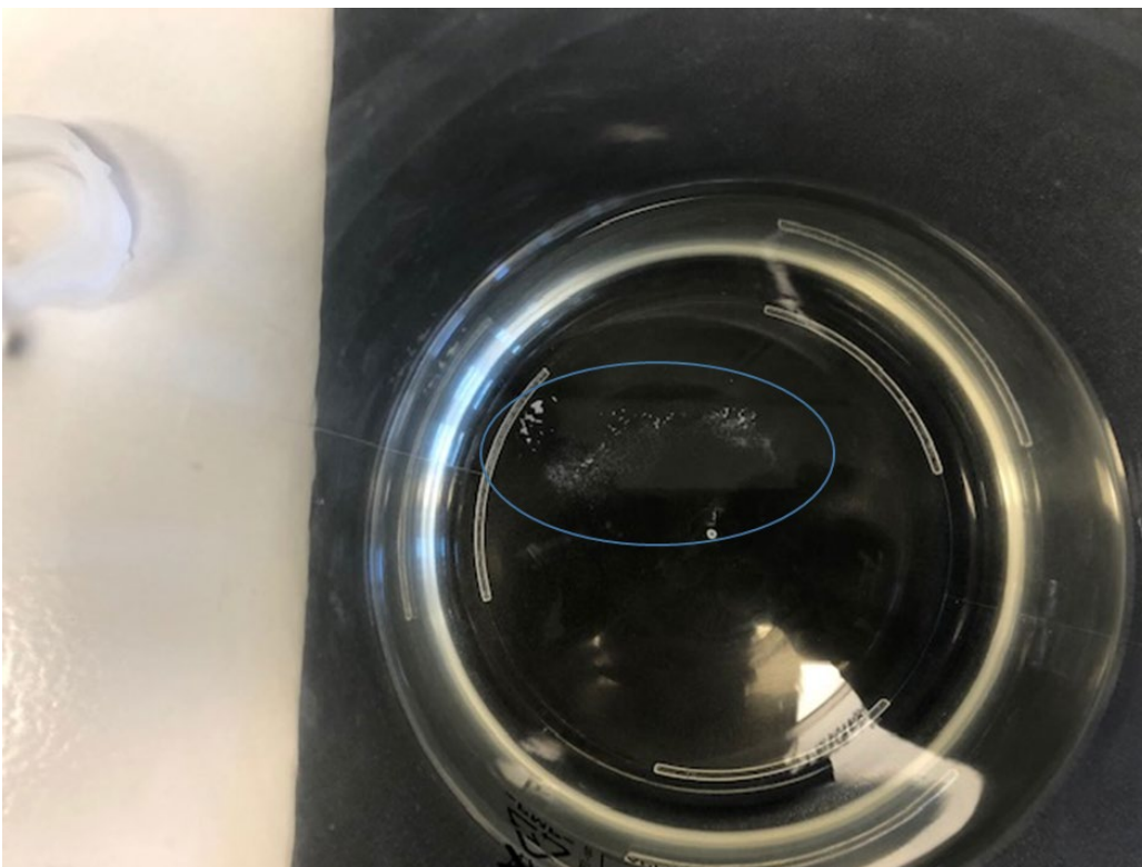
Figur 9. Ikke all Solaritt eller \text{CaCO}_3 lot seg løse i forsøkene. Bildet er tatt på slutten av ett av forsøkene med Solaritt, dvs. 4 timer etter at solaritt ble tilsatt. Det var primært ved de høyeste tilsetningene av syrenøytraliseringsmidler at uløst stoff var godt synlig (området innenfor blå ring).
