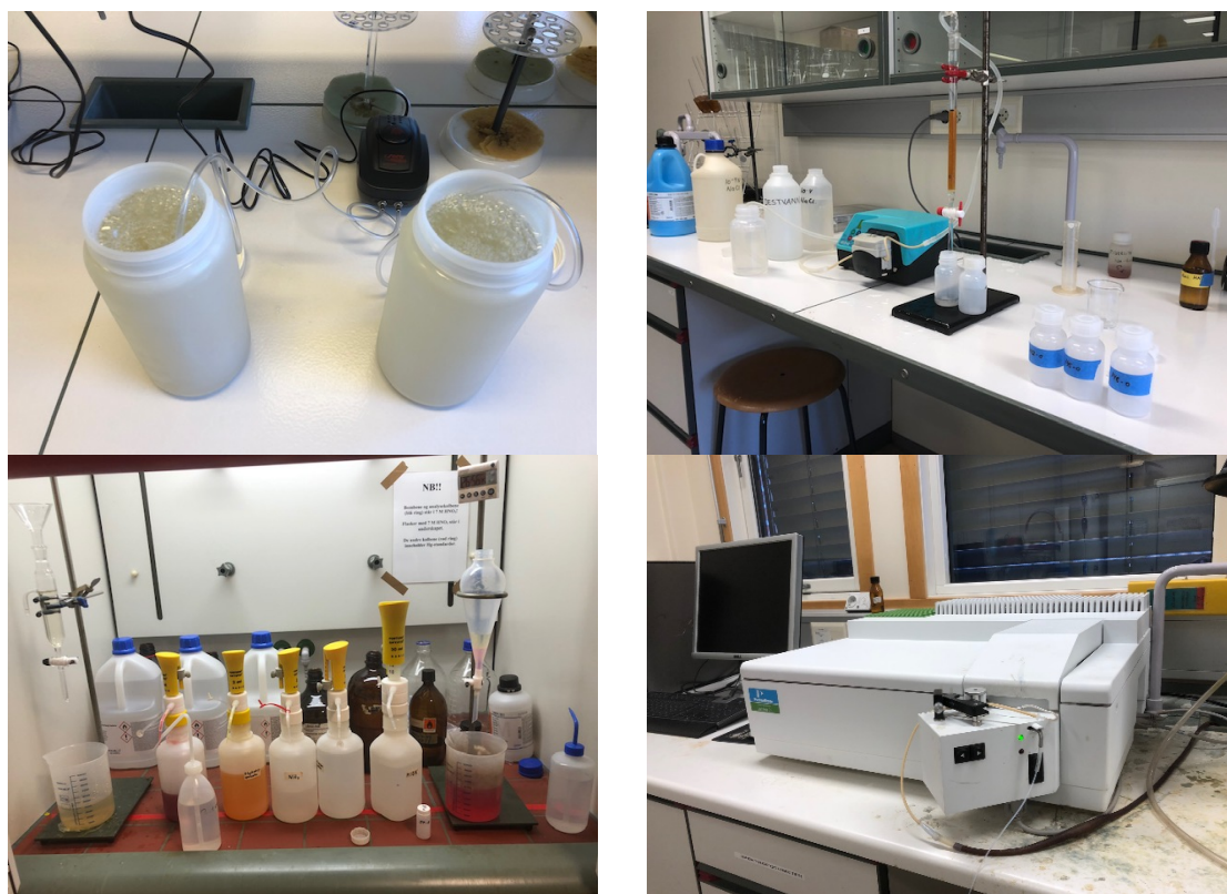
Figur 1. Bilder av forsøksoppsettet. Ulike mengde kalk og solaritt et tilsatt 2 L råvann, hvor akvariepumper er brukt som røreverk. (øverst til venstre). Kationebryteren for Al-fraksjonering vist øverst til høyre. HQ/MIBK ekstraksjonen utført i avtrekkskap er vist i bilde nederst til venstre, mens spektrofotometriske absorbansmålinger ble utført på et Perkin Elmer UV/Visible spektrometer, type Lamda 25 (bilde nederst til høyre).
