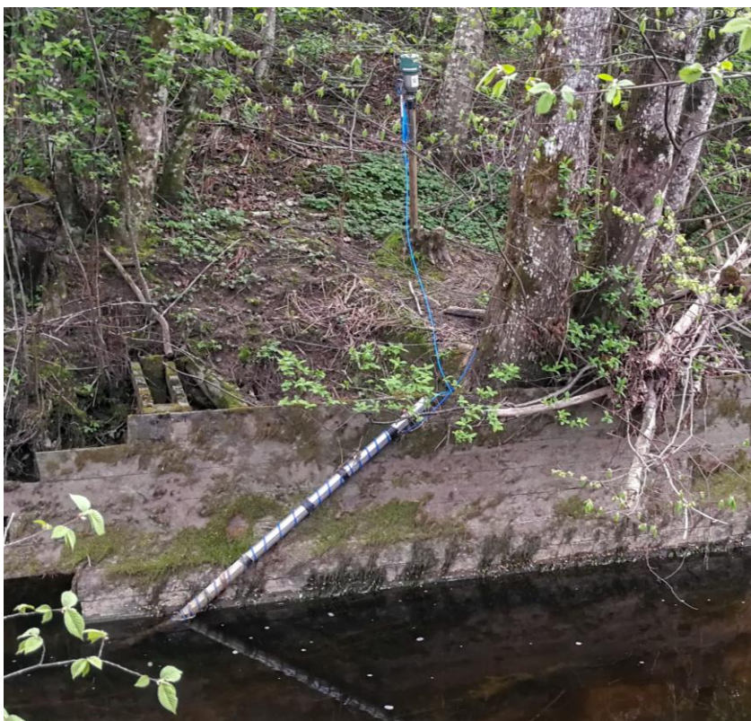
Figur 3-1. Automatisk målestasjon, ÅBY5, multiparametersonde til kontinuerlig overvåking av vannet i Åbyelva er plassert i foringsrøret. Foto: Yvonne Rognan
