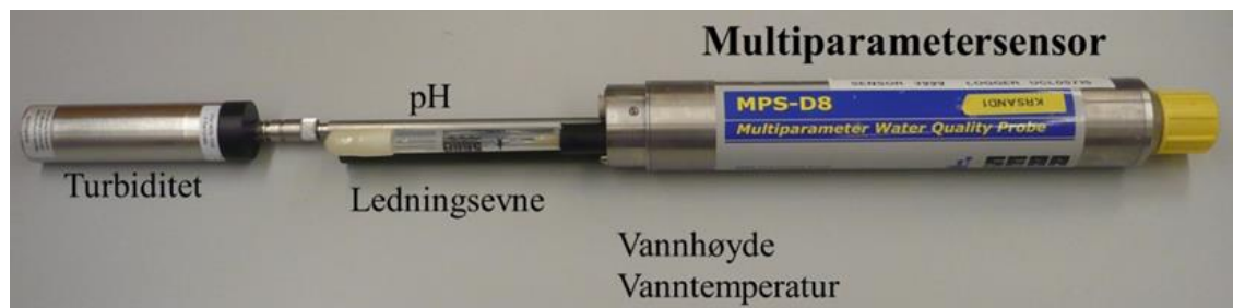
Figur 3-2. Multiparametersensor benyttet til måling av abiotiske parametere i Høenstjenna. Tilsvarende sensor er også benyttet i de automatiske målestasjonene for kontinuerlig måling av vannkvalitet bl.a. i Åbyelva ved ÅBY5.
