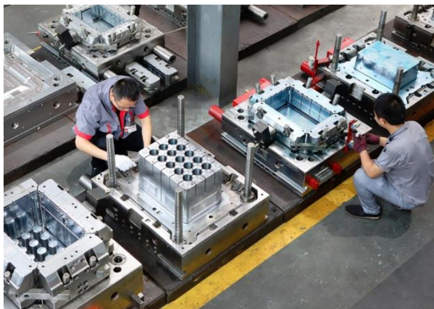
Figur 28: Sammensetting av former til sprøyttestøp [12]
