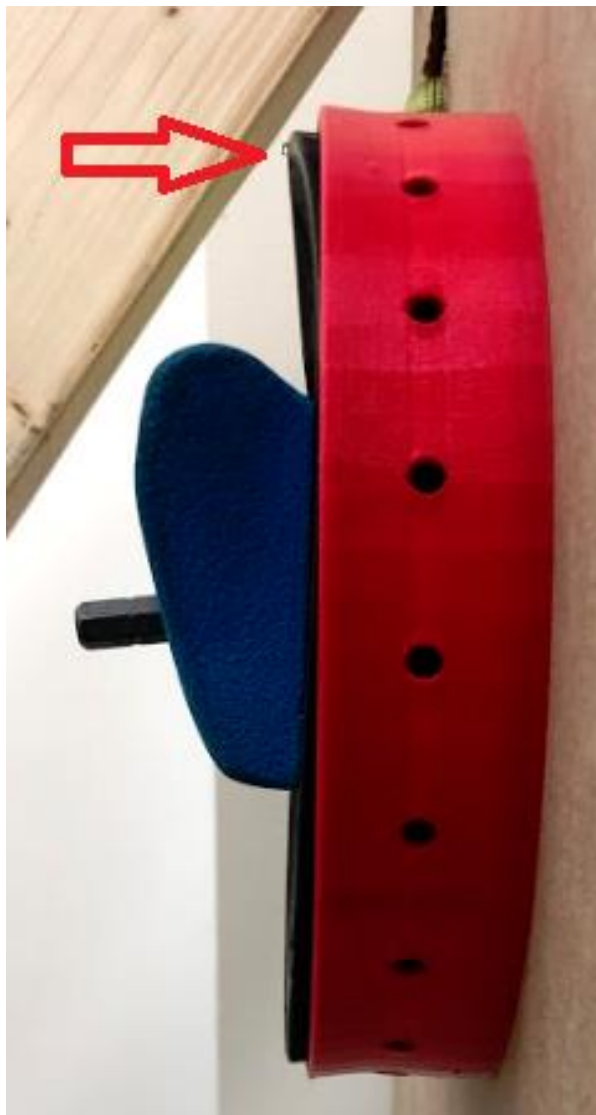
Vedlegg Figur 81: Virkelig deformasjon av lokk under 30Nm. Målt til å være ca. 2mm fra startpunkt
