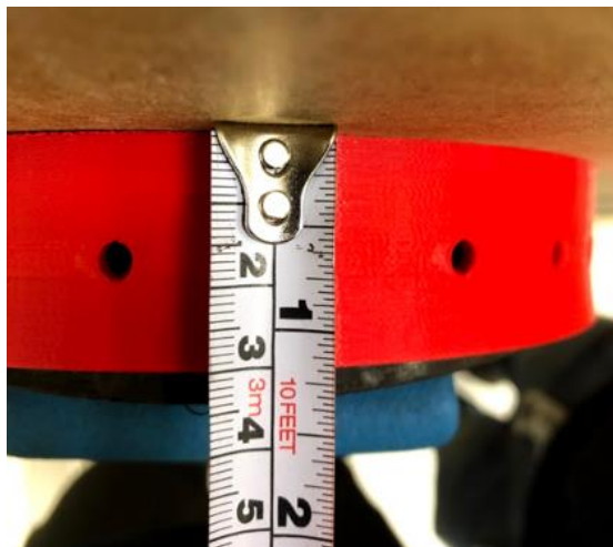
Vedlegg Figur 74: Deformering av lokk sett ovenfra
