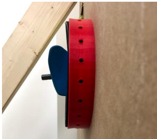
Vedlegg Figur 75: Deformering av lokk sett fra siden
