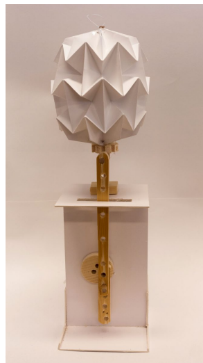
Figur 13, «Bevegelsesmekanisme 2», 2018, eget arbeid. Bildet viser egen mekanisme med utgangspunkt i Halloween-effekten. Svingarmene til mekanikken ble laget i tre, med hull i ulike avstander. Dette ga mulighet for å regulere utslag på bevegelsen. For å skape bevegelig ledd mellom svingarmene ble det brukt rundstokk som tapp.
