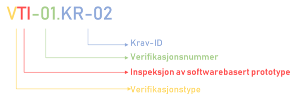
Te-Fig.2: Verifikasjonskode for teoretisk inspeksjon
