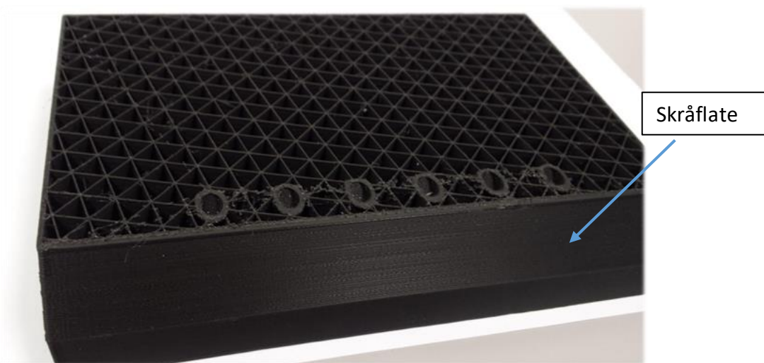
Figur 5.1.1: Feil ved 3D-printing av testdel
