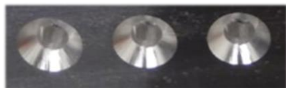
Figur 12.1.2: Matningshastighet på 0,05 mm/s for forsænking
