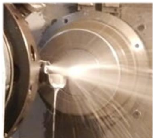
Figur 10.1.3: Dreining i første oppspenning
