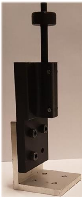
Figur 5.2.2: Ferdig 3D-printet probe og feste
