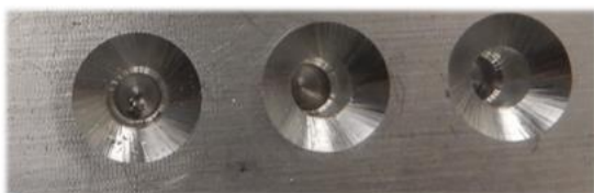
Figur 12.1.1: Matningshastighet på 0,2mm/s for forsænking
