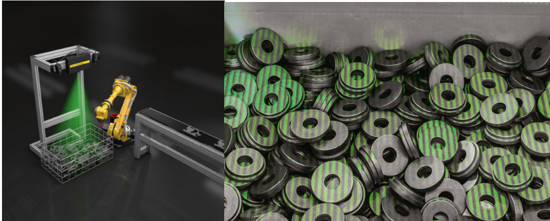
Figur 6.2.1.1: Illustrasjon av 3D iRvision system. [29], [30]
