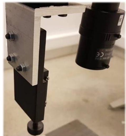
Figur 5.2.3: Ferdig 3D-printet probe og feste tilkoblet robot
