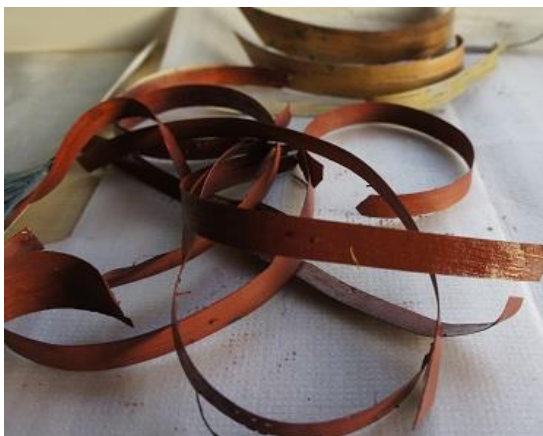
Figur 50: Jernoxidrød linoljefarge påført neverremser.
