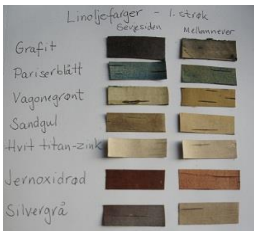
Figur 46: Fargeprøver. Ett strøk med linoljefarger.
