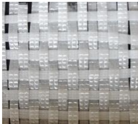
Figur 39: Plastremser med kontrast i matt og blank overflate.
