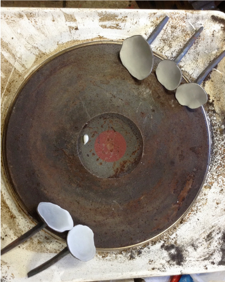
Bild 61. Torkning av svampelement på värmeplatta. Emaljen är Thompson grundeemalj GC-16 och den är påförd vått med pensel.
