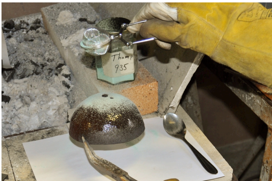
Bild 73. Varmströning av täckemaljen. Båda lagren ströddes på samma vis.
