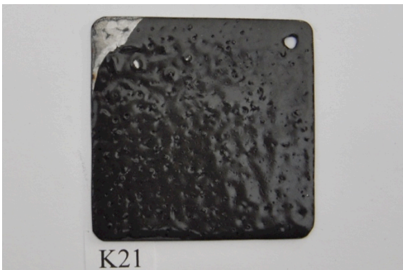
K21 glödd och lätt slipad, Thompson grund GC-16, emalj strödd torrt & kallt, 2,05g emalj, S 840°C, bränd i 4min.
