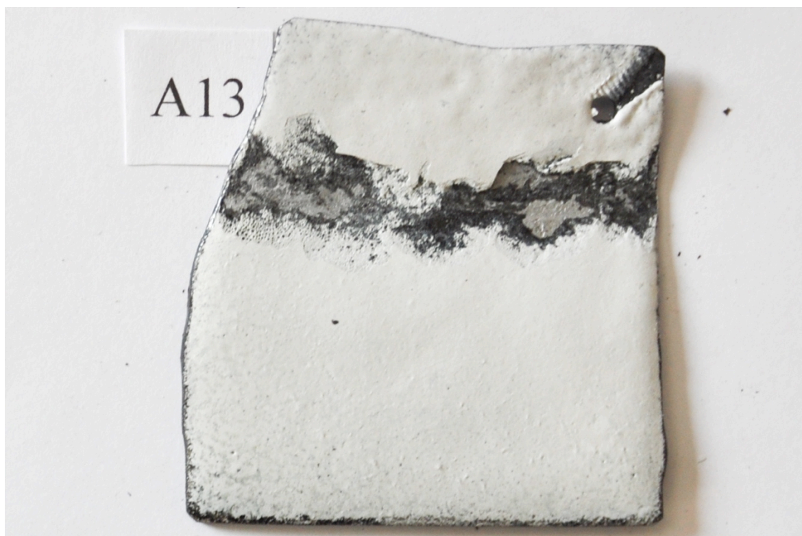
Bild 52. A13 emaljerad med WG Ball grundemalj och 12541 White. Emaljen ser ut att sitta ganska bra men det är många små blåsor inne i emaljskiktet.
