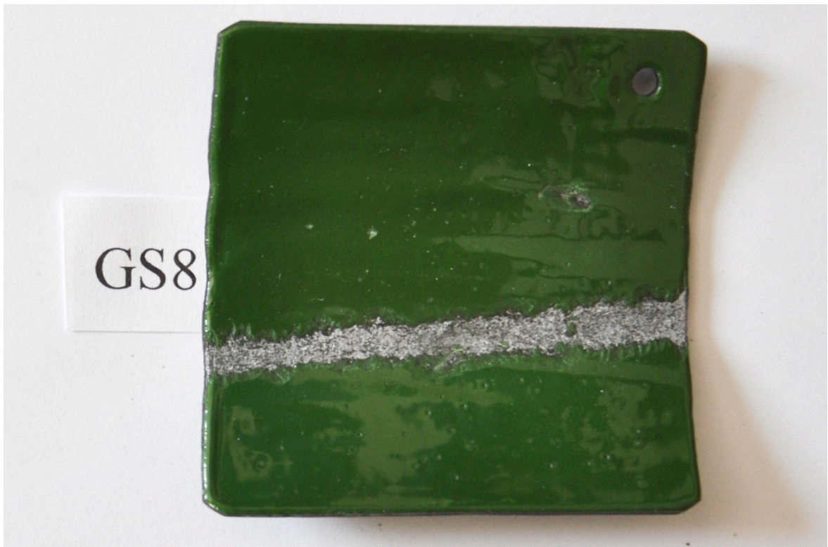
Bild 38. GS8 emaljerad med WG Ball 12554 Dark Green direkt på stålet utan grund. Den har intressant nog betydligt mindre blåsor än S5, som är ett riktigt emaljstål. Det finns dock små porer efter nästan igensmälta blåsor. Den får Klass 3.
