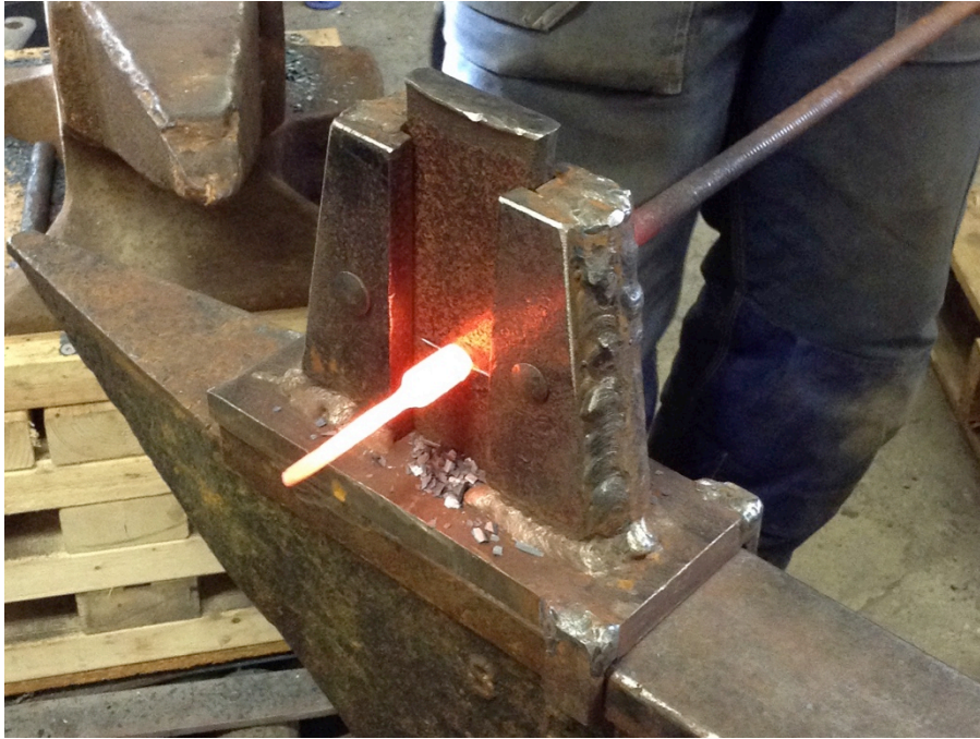
Bild 55. Kapning av ämnet till huvudet på svampelementen. Verktuget kallas giljotin och är både hållare för ett löst undersänke och styrning för ett översänke. Notera den utsmidda tången med tydlig övergång till rundstångens fulla diameter.
