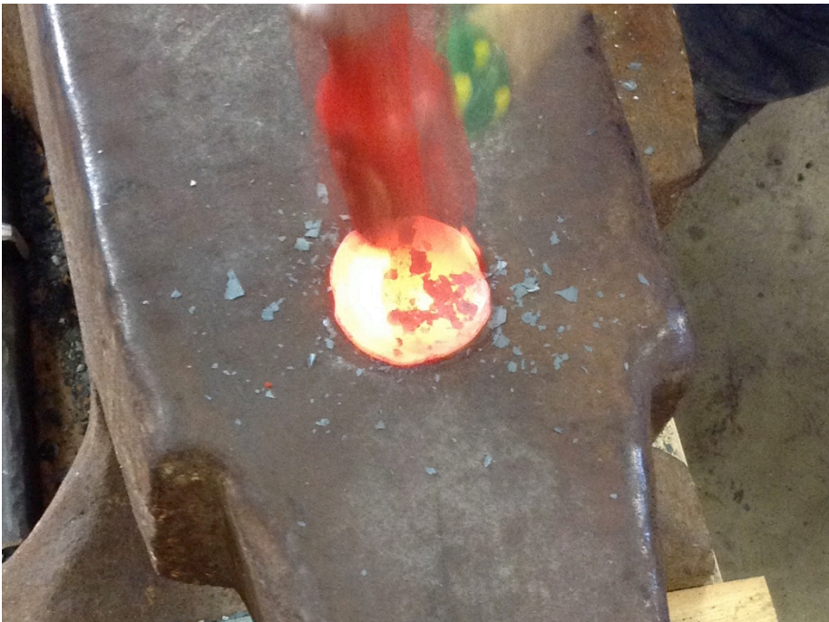
Bild 58. Formning av huvudet med hjälp av det stora runda hålet i städet.
