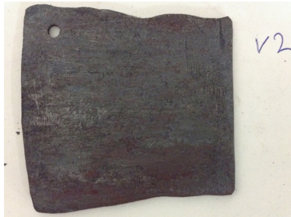
V2 Utsmidd från stång med oxiderad yta. 55x60mm.
