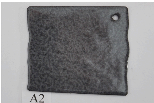
A2 WG Ball grund, emalj strödd torrt & kallt, 1,76g emalj, S 850°C, Bränd i 4min. Renslipad yta med vinkelslip före bränning. Yta motsvarande GS2.
