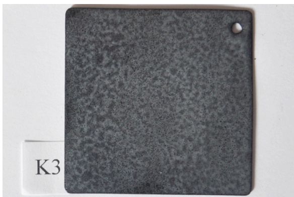
K3 60x60mm, WG Ball grund, emalj strödd torrt & kallt, S 820°C.
