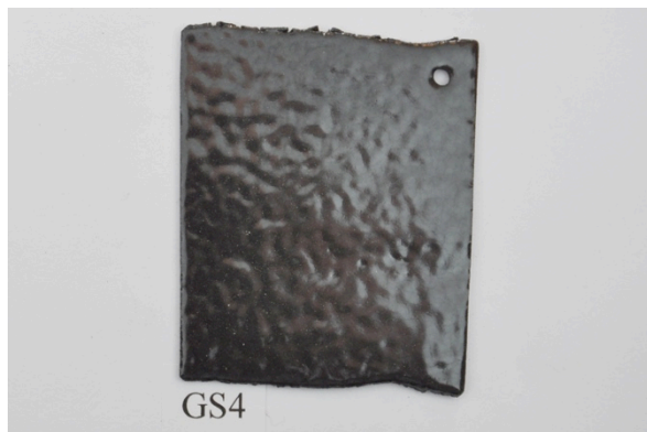
GS4 Thompson grund GC-16, emalj strödd torrt & kallt, 1,98g emalj, S 850°C, Bränd i 4min.
