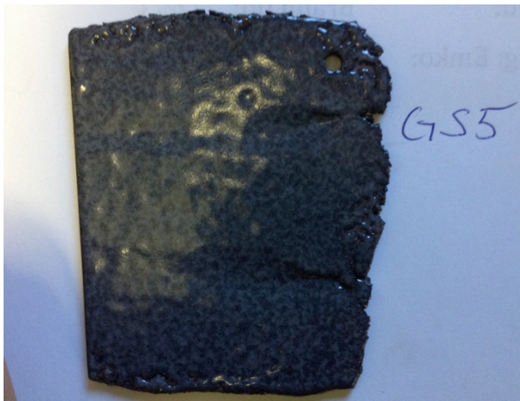
GS5 WG Ball grund, emalj strödd torrt & kallt, S 850°C, Bränd i 4min.
