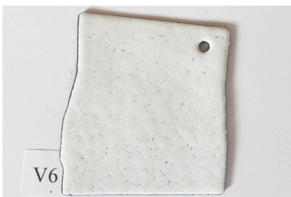
V6 WG Ball 12541 White, emalj strödd torrt & kallt, 2,05g emalj, S 830°C, bränd i 4min.
