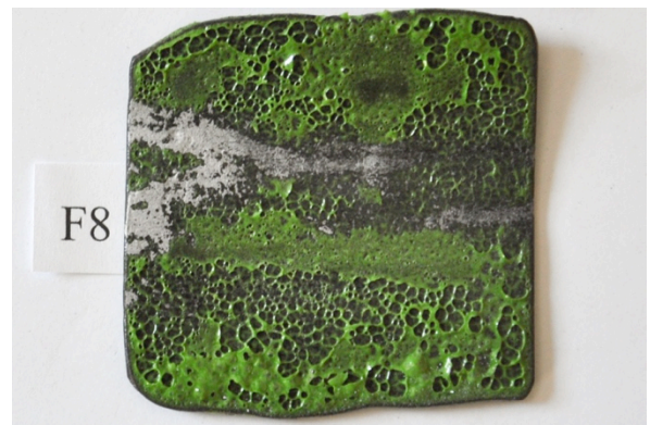
F8 Knäckt , Institute of Vitreous Enamellers visuell Klass; 4 . Böjd 10° radie ca 60mm.
