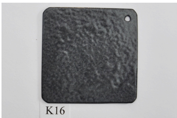
K16 glödd och lätt slipad, WG Ball grund, emalj strödd torrt & kallt, 2,11g emalj, S 840°C, bränd i 2min.
