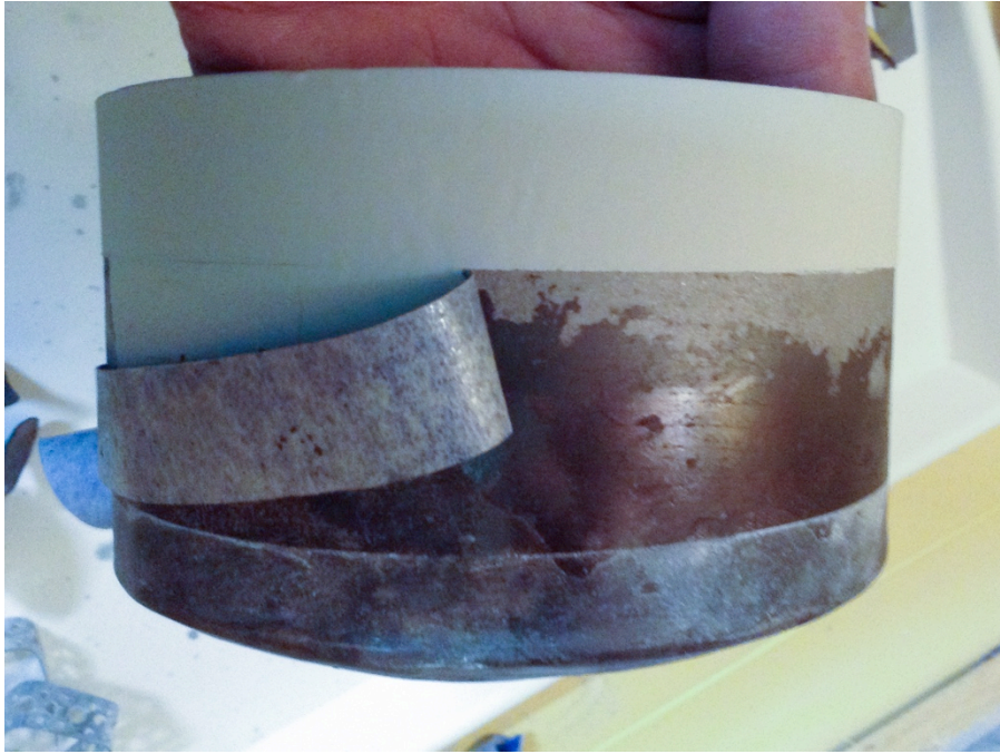
Bild 67. Avrivning av maskering för grundemalj, efter att den torkat. Metoden fungerade bra och det blev en tydlig kant. Emaljresterna nederst på lampkupan utanför maskeringen, borstades bort innan bränning.
