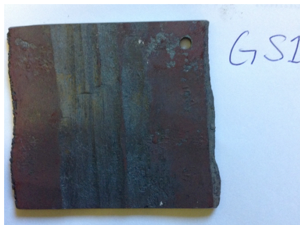
GS1 Stål smidd från rundstång. Glödskal på ytan från smidesprocessen.
