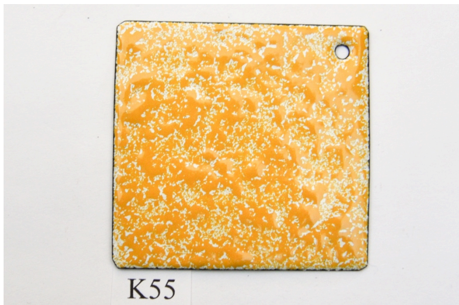
Bild 16. K55 är emaljerad med nr 12549 Deep Yellow, ovanpå vit.
