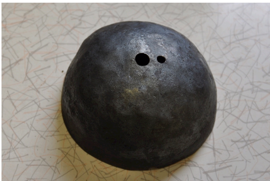
Bild 70. Färdig smidd takkupa med hål för elanslutning och fastskruvning till takfäste.
