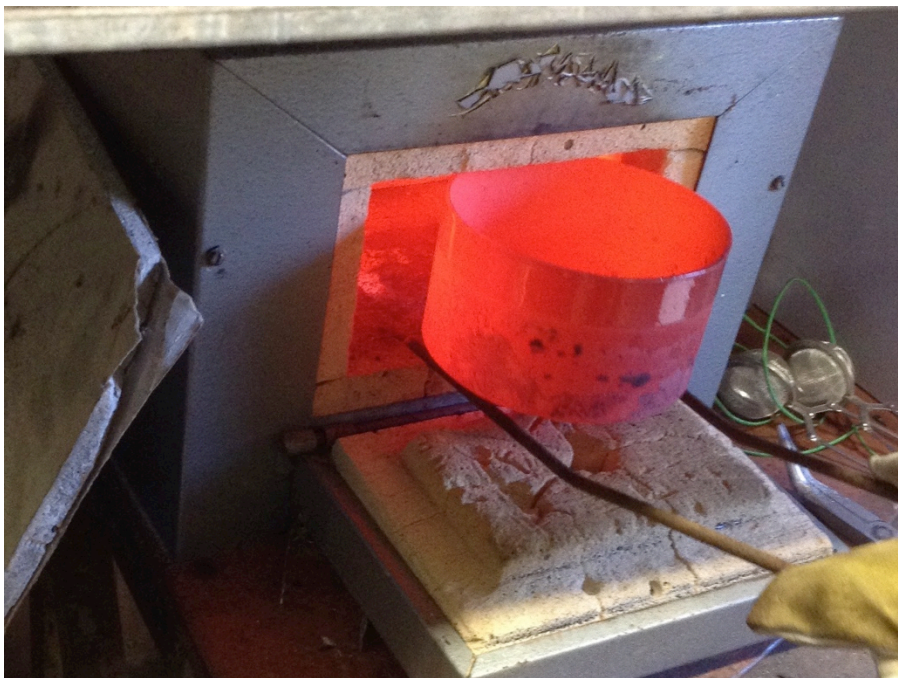
Bild 68. Bränning av lampkupan. Den är på väg ut ur ugnen med bränd grundemalj.
