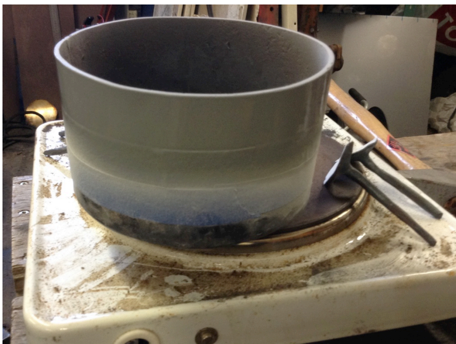
Bild 66. Torkning av grundemalj på lampkupan. Thompson grundemalj påförd våt med tryckluftsspruta. All emalj torkades på värmeplatta.
