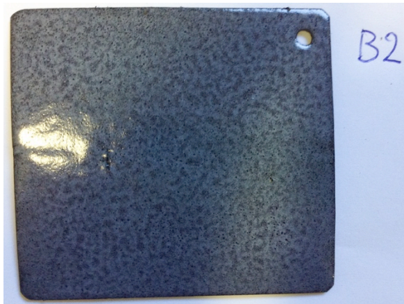
B2 WG Ball grund, emalj strödd torrt & kallt, 1,72g emalj, S 830^\circ\text{C} .
