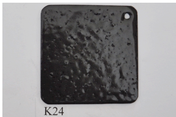
K24 glödd och lätt slipad, Thompson grund GC-16, emalj strödd torrt & kallt, 2,29g emalj, S 850°C, bränd i 4min.
