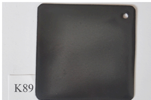
K89 Thompson grund GC-16, oxidfri yta avfettad med lacknafta och rödsprit, munstycke 0,8mm, S 820°C, Bränd i 4min, Sprutad med 3 skikt, 1,25g emalj
