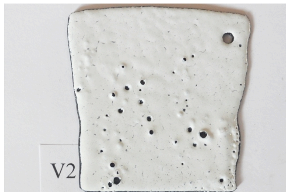
V2 WG Ball 12541 White, emalj strödd torrt & kallt, 2,23g emalj, S 830°C, bränd i 4min.
