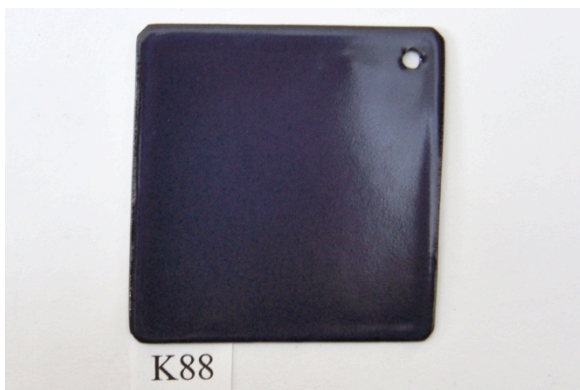
K88 Skillinge emalj grund, oxidfri yta avfettad med lacknafta och rödsprit, munstycke 0,8mm, S 820°C, Bränd i 4min, Sprutad med 3 skikt, 1,56g emalj.
