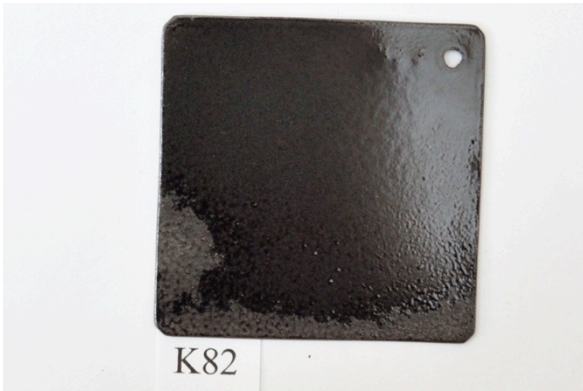
K82 Skillinge emalj grund, oxidfri yta avfettad med lacknafta och rödsprit, munstycke 0,8mm, S 820°C, Bränd i 4min, Sprutad med 1 skikt, 0,35g emalj.
