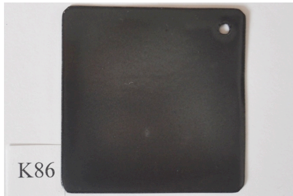
K86 Thompson grund GC-16, oxidfri yta avfettad med lacknafta och rödsprit, munstycke 0,8mm, S 820°C, Bränd i 4min, Sprutad med 2 skikt, 0,90g emalj.
