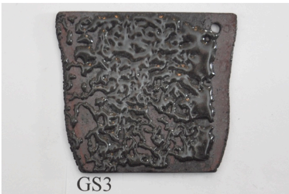
Bild 10. GS3 Med oxiderad yta. Thompson emalj torrströdd. Emaljen har dragit sig samman och lämnat stora delar av stålytan fri från emalj. Jämfört med GS5 är det en tydlig indikation på betydelsen av oxider på stålytan. Men emaljen skiljer också mellan GS3 och GS5. Provbiten GS1 som är emaljerad med oxiderad yta och WG Ball grundemalj visar samma skrovliga yta som har dragit sig samman, dock inte i lika stor grad som på GS3.
