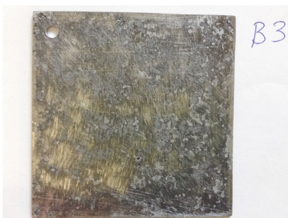
B3 60x60mm, av emaljerad genom glödning i ugn och därefter kylning i vatten. Sist slipad med vinkelslip.
