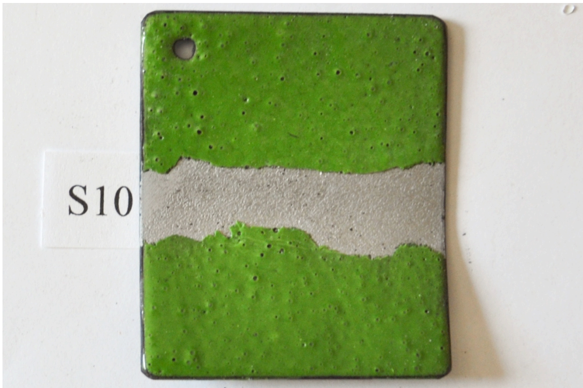
Bild 47. S10 emaljerad med Thompson 791 Hunter Green utan grund. Det är bubblor över hela ytan. Det är även möjligt att se de större kornen som blockerade sprutan som fläckar i ytan. Knäckningen visar att det är dålig vidhäftning till stålet.
