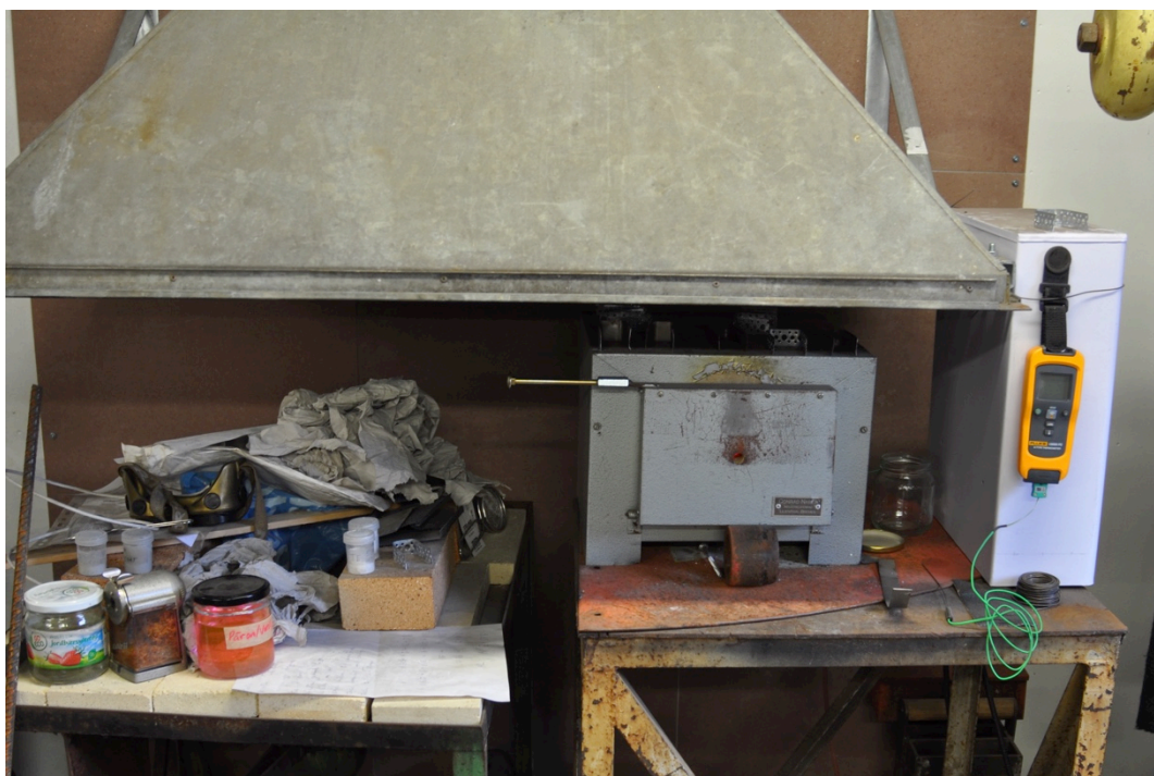
Bild 1. Naber emaljugn med PID-temperaturstyrning inbyggd i det vita skåpet till höger.
