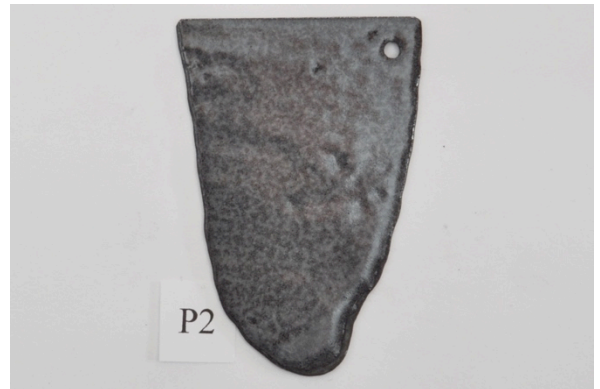
P2 WG Ball grund, emalj strödd torrt & kallt, 1,80g emalj, S 850°C, Bränd i 4min
