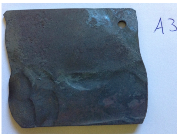
A3 Stål smidd från fyrkantstång. Glödskal på ytan från smidesprocessen.
