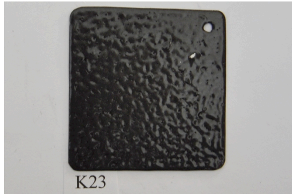
K23 glödd och lätt slipad, Thompson grund GC-16, emalj strödd torrt & kallt, 1,95g emalj, S 850°C, bränd i 2min.
