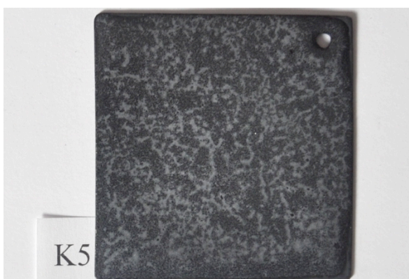
K5 60x60mm, WG Ball grund, emalj strödd torrt & kallt, S 830°C, bränd i 6min.
