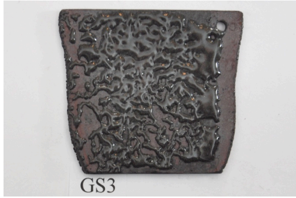
GS3 Thompson grund GC-16, emalj strödd torrt & kallt, 2,15g emalj, S 850°C, Bränd i 4min.
