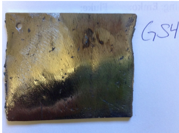
GS4 Stål smidd från rundstång. Ytan slipad oxidfri med vinkelslip.
