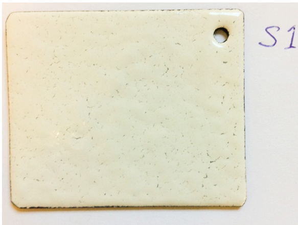
S1 WG Ball 12541 White, emalj strödd torrt & kallt, 1,65g emalj, S 830°C, bränd i 4min.
