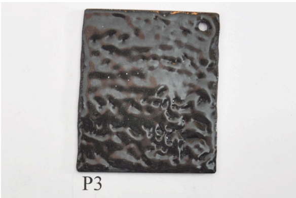
P3 Thompson grund GC-16, emalj strödd torrt & kallt, 1,87g emalj, S 850°C, Bränd i 4min.
