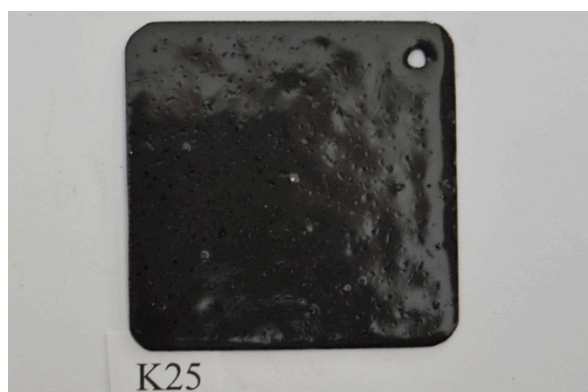
K25 glödd och lätt slipad, Thompson grund GC-16, emalj strödd torrt & kallt, 2,15g emalj, S 850°C, bränd i 8min.
