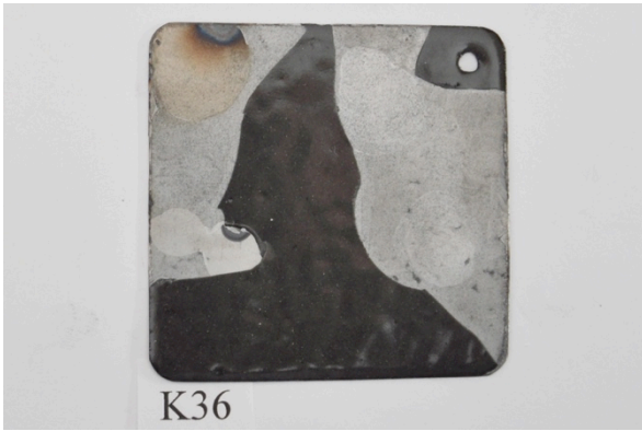
K36 Thompson grund GC-16, emalj strödd torrt & kallt, 2,16g emalj, S 850°C, Bränd i 4min
