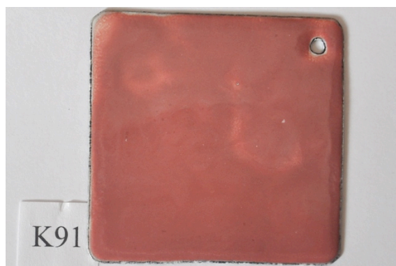
K91 Thompson grund GC-16, 1,24g emalj. Våtsprutad med 0,8 munstycke. Därefter Thompson 534 White, 1,42g emalj. Våtsprutad med 0,8 munstycke Därefter Thompson 937 Coral , 1,65g emalj. Våtpenslad. Alla lager är forcerat torkade med värmeplatta. Alla lager är brända med S 820°C, i 4min.
