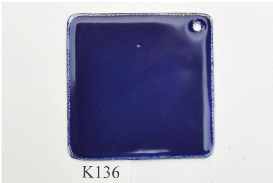
Bild 27. K136 är emaljerad med 2,46g 12555 Royal blue från WG Ball. Den är även om det ser ut på bilden här som att den är något vit eller ojämn i mitten, ett av de jämnaste
