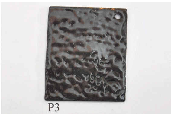
Bild 11. P3 PurusFe stål med mycket låg kolhalt i likhet med Armco. Kolhalt max 0,010 % vanligtvis innehåller den 0,003 % (HKM Stahl GmbH, 2015). Trots den mycket låga kolhalten har emaljen dragit sig samman och bildat klumpar. Den visar att även väldigt
