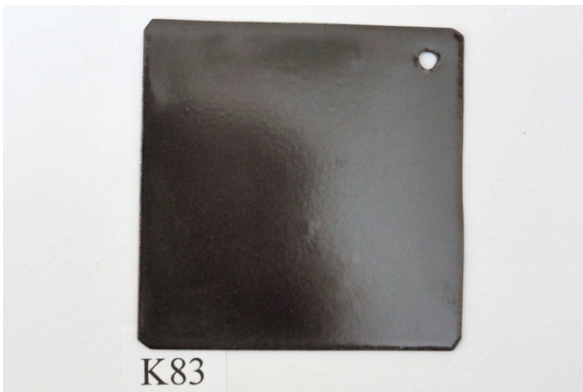
K83 Thompson grund GC-16, oxidfri yta avfettad med lacknafta och rödsprit, munstycke 0,8mm, S 820°C, Bränd i 4min, Sprutad med 1 skikt, 0,84g emalj.
