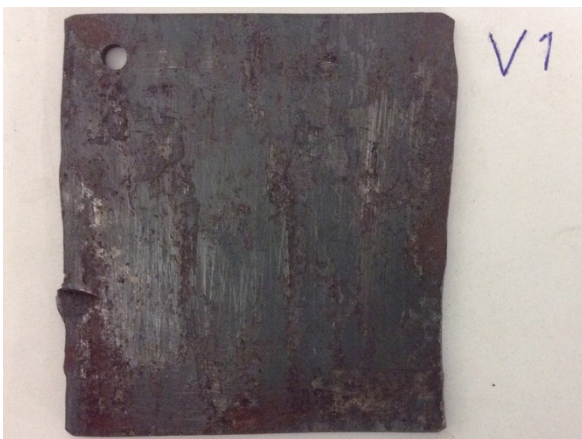
V1 Utsmidd från stång med oxiderad yta. 58x54mm.
