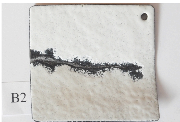
B2 Knäckt, visuell klassificering enligt IVE Klass 3. Böjd 20°, radie på böjningen ca 6 mm.
