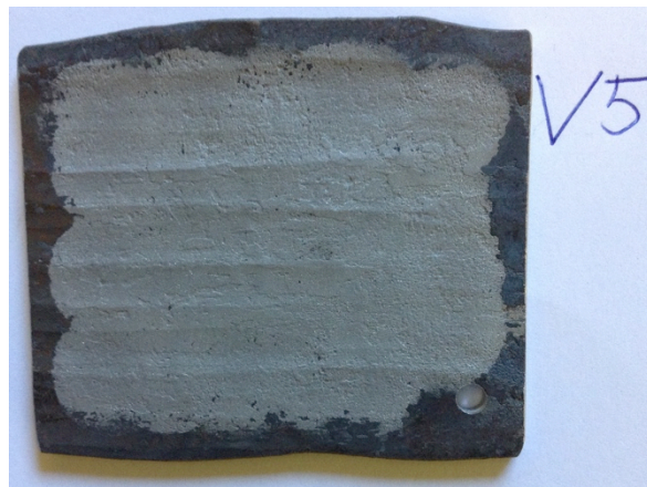
V5 Stål smidd från plattstång. Glödskal på ytan från smidesprocessen, på kanten av biten. Mitten blåstrad fri från oxid med punktbläster med kiselkarbid.
