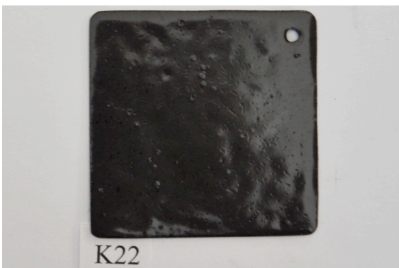
K22 glödd och lätt slipad, Thompson grund GC-16, emalj strödd torrt & kallt, 1,90g emalj, S 830°C, bränd i 8min.
