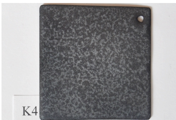
K4 60x60mm, WG Ball grund, emalj strödd torrt & kallt, S 830°C, bränd i 7min.
