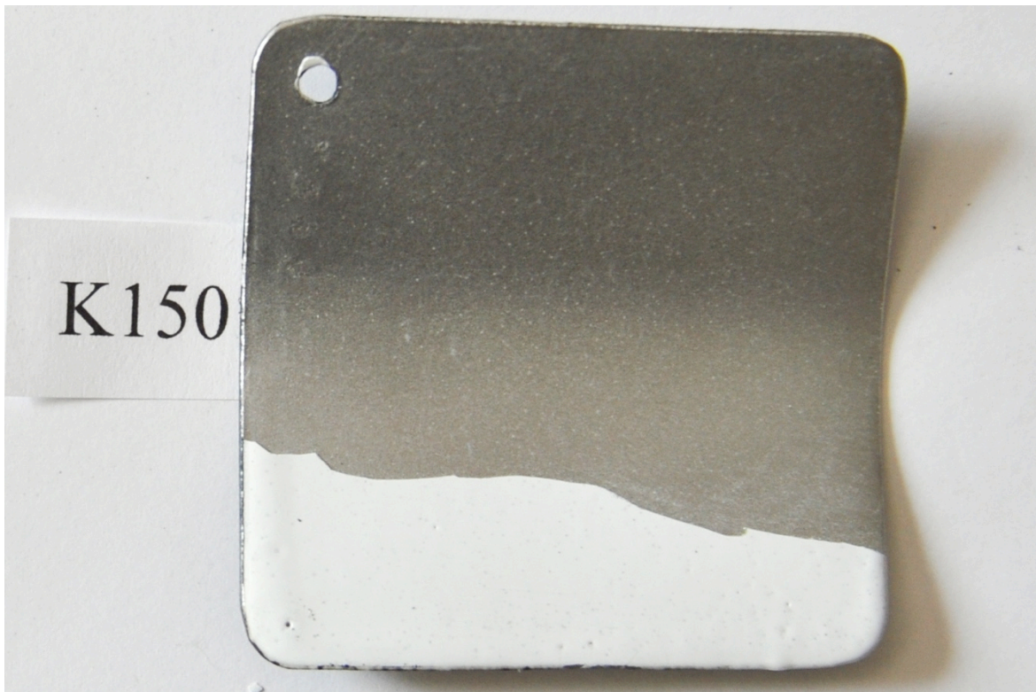
Bild 42. K150 emaljerad med Skillinge titandioxid vit utan grund. Det är dålig vidhäftning till stålet och emaljen släpper i stora flak även långt utanför deformationsområdet. Klar Klass 5. Jämför med prov K149 som är med grundemalj.
