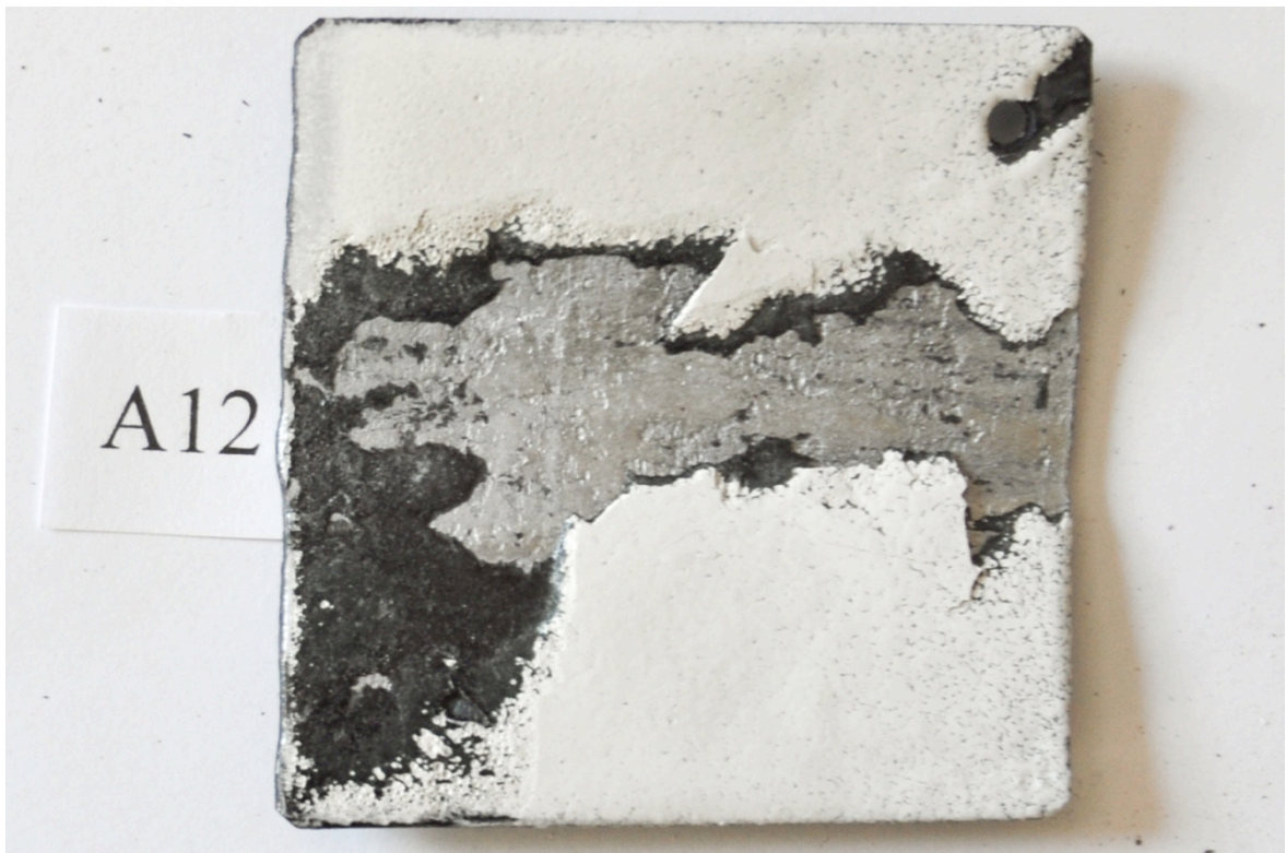
Bild 50. A12 emaljerad med Thompson grund och 533 White torrt och varmt. Bara små blåsor inne i emaljskiktet. Dock visar knäckprovet att emaljen inte sitter särskilt bra på stålet. Emaljen har lossnat och lämnat stora delar av deformationsområdet helt utan emalj och kanterna på emaljen är skarpa.
