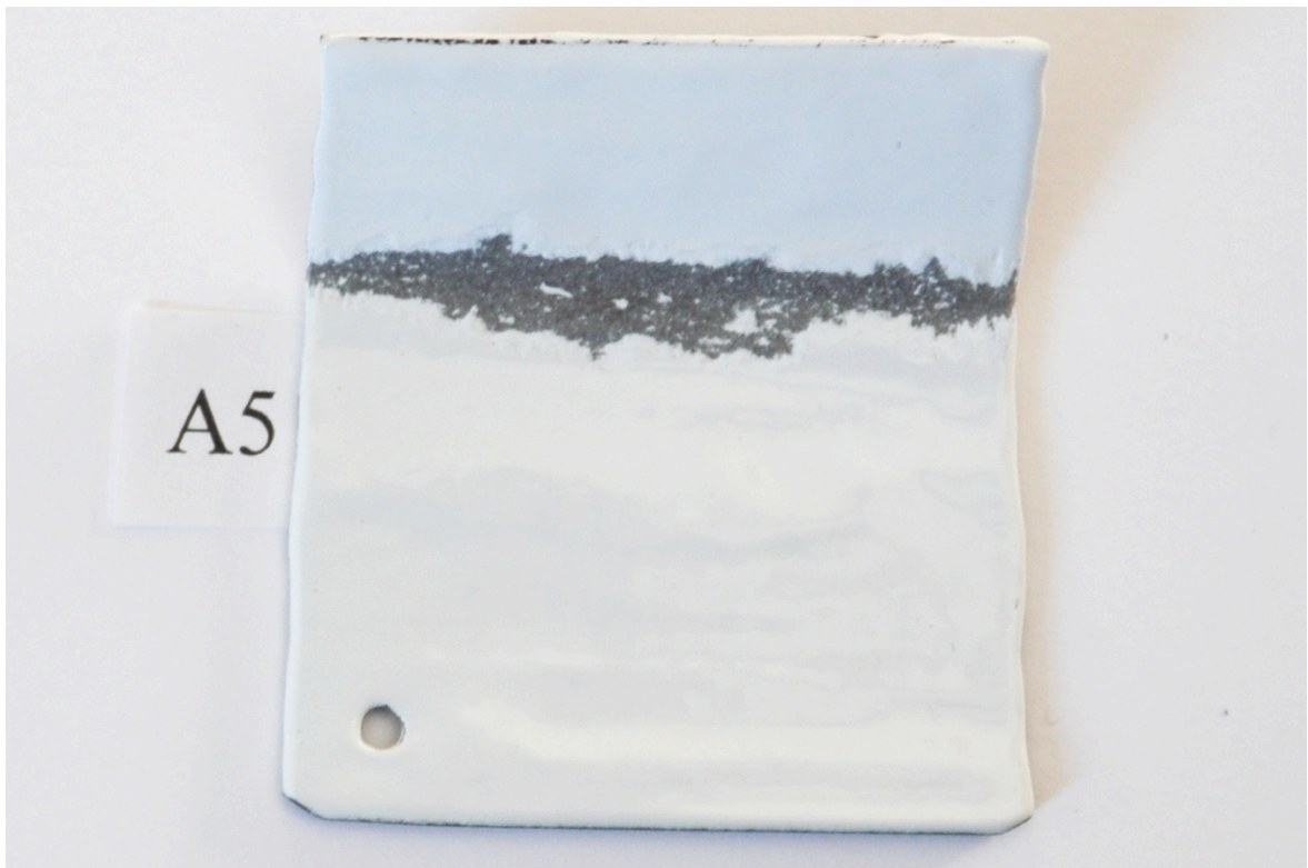
Bild 35. A5 emaljerad med WG Ball 12541 White direkt på stålet utan grund. Visar den släta ytan med de låg kolhaltiga stålen och hur mycket bättre emaljen sitter på den blåstrade ytan jämfört med den helt släta. Jämför med S4.
