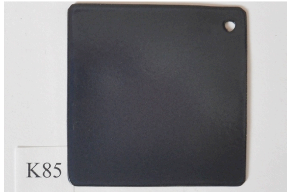
K85 Skillinge emalj grund, oxidfri yta avfettad med lacknafta och rödsprit, munstycke 0,8mm, S 820°C, Bränd i 4min, Sprutad med 2 skikt, 0,68g emalj.
