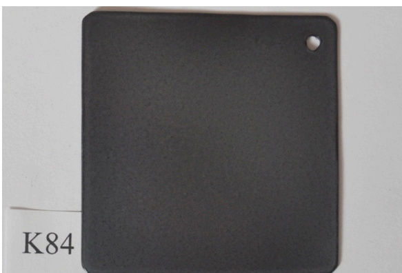
K84 WG Ball grund, oxidfri yta avfettad med lacknafta och rödsprit, munstycke 0,8mm, S 820°C, Bränd i 4min, Sprutad med 2 skikt, 0,59g emalj.
