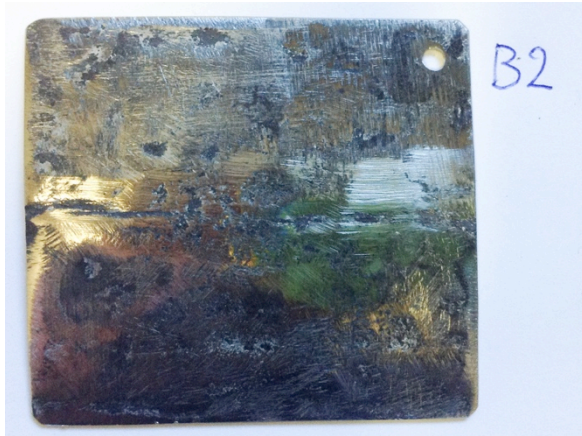
B2 65x61mm, av emaljerad genom glödning i ugn och därefter kylning i vatten. Sist slipad.
