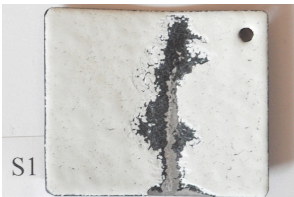
S1 Knäckt, visuell klassificering enligt IVE Klass 3. Böjd 20°, radie på böjningen ca 35 mm.
