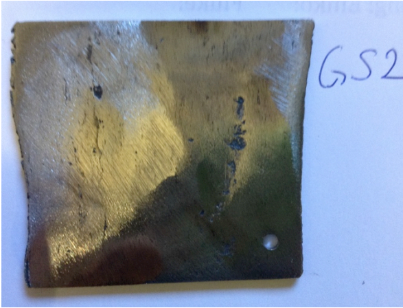
GS2 Stål smidd från rundstång. Renslipad med vinkelslip.
