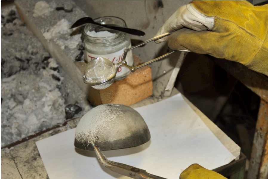
Bild 71. Torrsiktning av takkupan. Stålet är blåstrat och en tesil används för siktningen.
