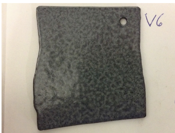
V6 WG Ball grund, emalj strödd torrt & kallt, 2,27g emalj, S 830°C, bränd i 4min.
