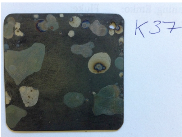
K37 Glödd 4 min i 850, tjockare oxidskikt som har bildat blåsor och släppt, oxidering under blåsorna. Lätt slipad efter glödning.
