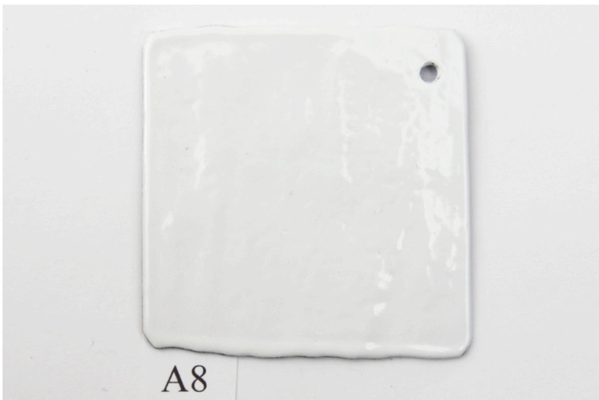
Bild 43. A8 emaljerad med Skillinge titandioxid vit utan grund. Det bästa provet i denna testserie. Spåren av blåsor är oväsentliga. Dock inte så bra bindning som med grundemalj. Jämför med V10 som har högre kolhalt.
