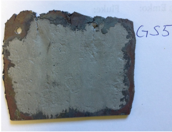
GS5 Stål smidd från rundstång. Glödskal på ytan från smidesprocessen i kanten på biten. Mitten blåstrad fri från oxid med punktbläster med kiselkarbid.
