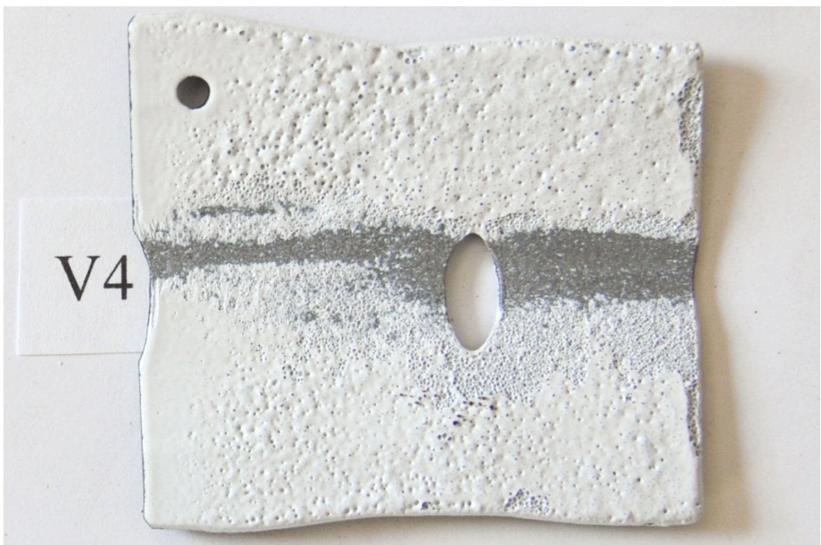
Bild 36. V4 emaljerad med WG Ball 12541 White direkt på stålet utan grund. Den visar hur emaljen blåser upp sig och blir bubblig när stålet innehåller mera kol. Emaljskiktet
