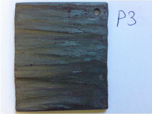
P3 Stål smidd från rundstång. Glödskal på ytan från smidesprocessen.
