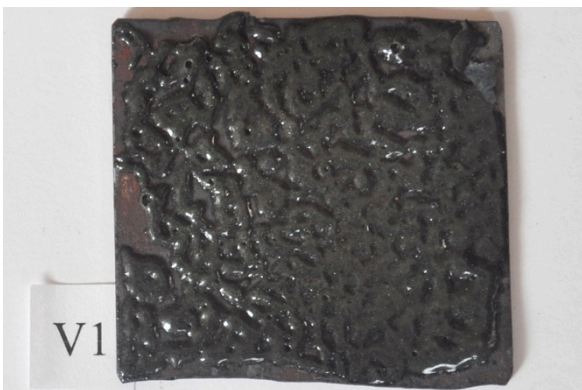
V1 Thompson grund GC-16, emalj strödd torrt & kallt 2,14g emalj, S 830°C, bränd i 4min.
