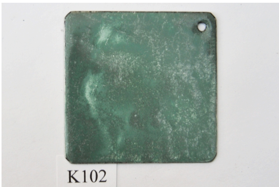
Bild 25. K102 är emaljerad med Thompson grund GC-16. Därefter Thompson 534 White och slutligen penslad med 1,49g Thompson 935 Robin Egg Blue. Den fick ett märkligt silveraktigt skimmer i ytan. Det syntes redan i burken med den våta emaljen. När emaljen rörs runt blir den helt jämn i färgen men får fort detta skimmer i ytan. När emaljen penslas på, är den jämn i färgen men innan torkning får den samma skimmer. K102 är kanske det tydligaste exemplet i denna serie med provbitar, men det finns fler om visar samma förändring. En orsak skulle kunna vara att emaljen är sammansatt av flera olika emaljer och att dessa skiktas sig när emaljen är vått. Det skulle vara intressant att testa att spruta emaljen i stället för att pensla den och att den då har mindre vatten så att emaljkornen inte
