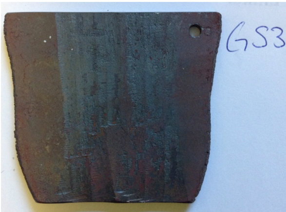
GS3 Stål smidd från rundstång. Glödska på ytan från smidesprocessen.
