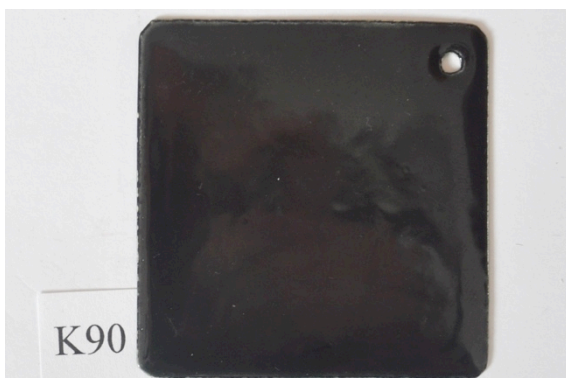
K90 Thompson grund GC-16, 1,26g emalj. Våtsprutad med 0,8 munstycke. Därefter Thompson 534 White, 1,40g emalj. Våtsprutad med 0,8 munstycke Därefter Thompson 772 Black , 1,13g emalj. Våtpenslad. Alla lager är forcerat torkade med värmeplatta. Alla lager är brända med S 820°C, i 4min.
