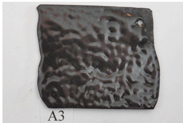
A3 WG Ball grund, emalj strödd torrt & kallt, 1,86g emalj, S 850°C, Bränd i 4min.
