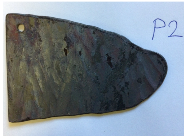
P2 Stål smidd från rundstång. Glödskal på ytan från smidesprocessen.
