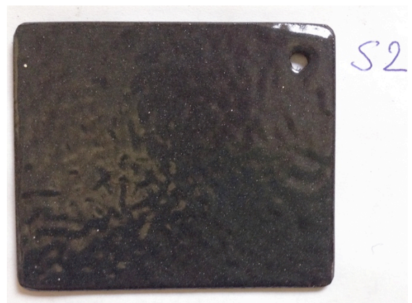
S2 Thompson grund GC-16, emalj strödd torrt & kallt 1,44g emalj, S 830°C, bränd i 4min.
