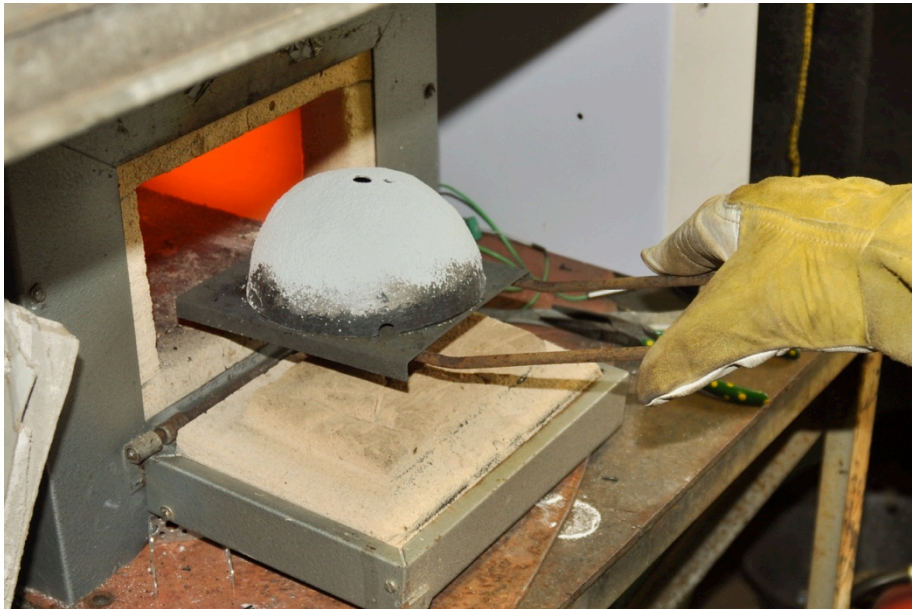
Bild 72. Takkupan på väg in i emaljgugnen med grundemaljen strödd kallt och torrt på.
