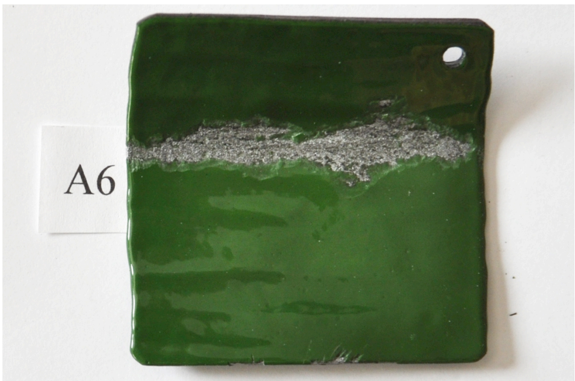
Bild 39. A6 emaljerad med WG Ball 12554 Dark Green direkt på stålet utan grund. Ytan är hel men med några försumbara små prickar i emaljen. Jämför med V8 nedan som har blåst upp sig över hela ytan.
