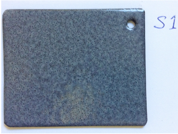
S1 50x60mm, WG Ball grund, glödd och renslipad, emalj strödd torrt & kallt, 1,76g emalj, S 830°C, bränd i 4min.
