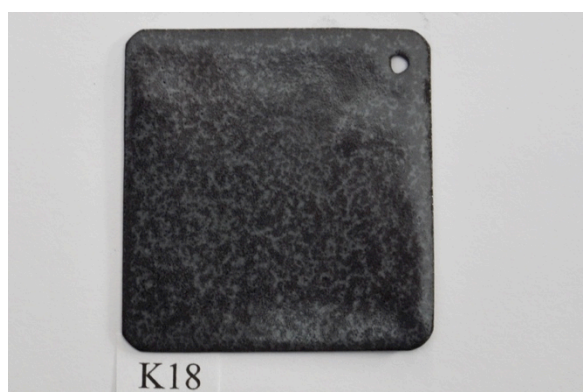
K18 glödd och lätt slipad, WG Ball grund, emalj strödd torrt & kallt, 2,11g emalj, S 840°C, bränd i 8min.
