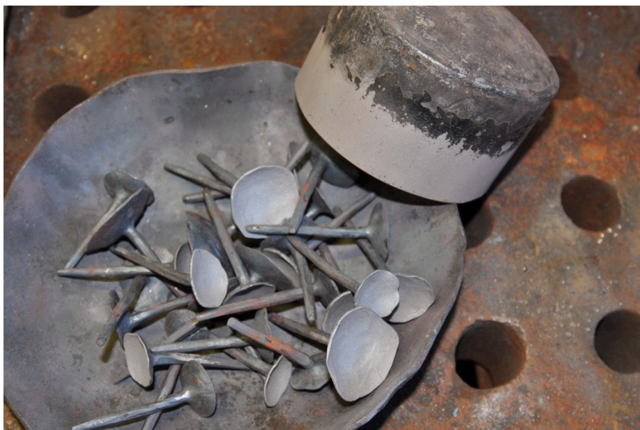
Bild 60. Smidda svampelement och stålkupa blåstrade för emaljering.
