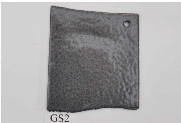
GS2 WG Ball grund, emalj strödd torrt & kallt, 2,20g emalj, S 850°C, Bränd i 4min.
