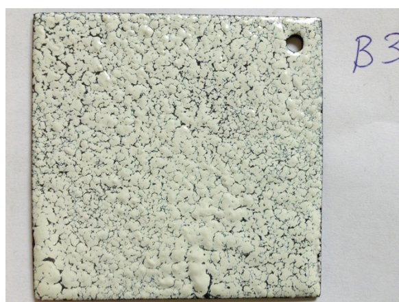
B3 Thompson 534 White, emalj strödd torrt & kallt, 1,58g emalj, S 830°C, bränd i 4min.
