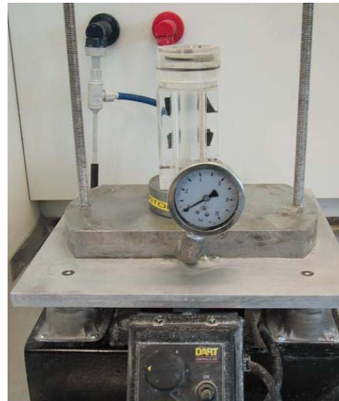
Figur 3.9 Matrisen montert sammen med vakuumkammer og vibrasjonsbord
