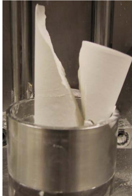
Figur 3.22 Pulversøylen viser et klart sviktplan etter styrketesten
