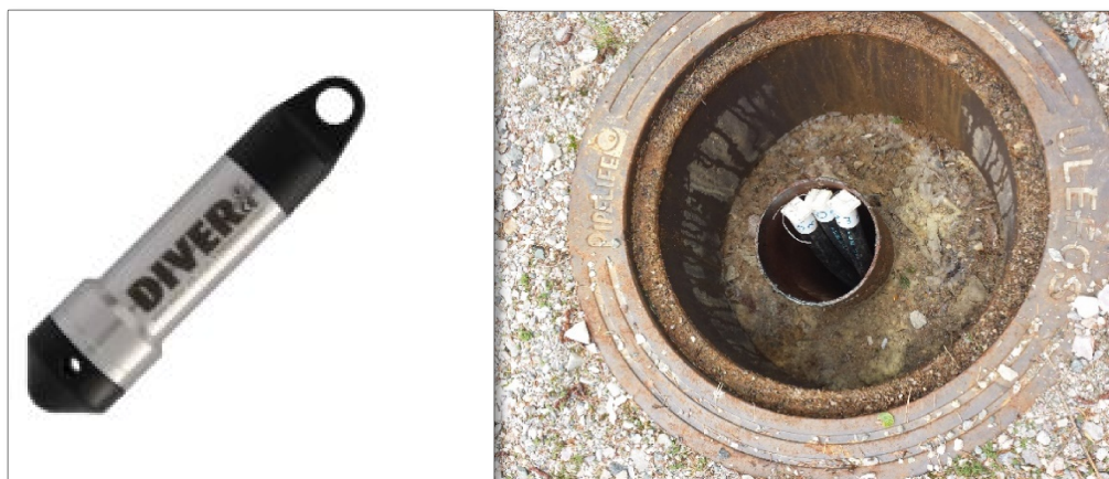
Bilde 2-4. Bildet til venstre viser en Minidiver som gir trykk og temperatur i hver piezometer, bildet til høyre viser en observasjonsbrønn med de tre piezometer og de er markert i forhold til filternivået.
