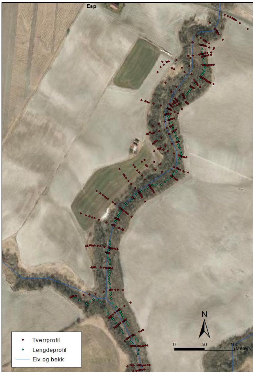
Figur 9-2 Tverr- og lengdeprofiler (røde og grønne punkter) målt i 2014 (se fig. 9-1). Blå strek viser hvor bekken hadde sitt løp før skredhendelsen. Flyfoto av Ristbekken fra 2011 ( http://kart.finn.no/ ).
