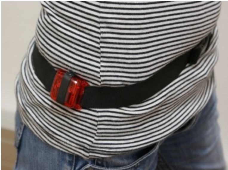
Figur 4.2: Bildet av akselerometeret Actigraph GT1M festet til beltet det bæres i på høyre hofte.
