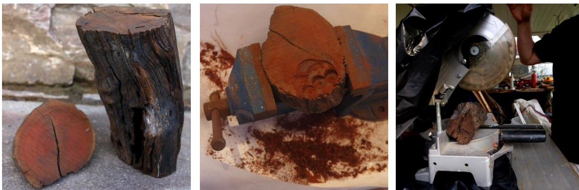
Figur 7: Fargetre fra Fredensborg og Lyra blir fliset opp med henholdsvis bor og sag.
