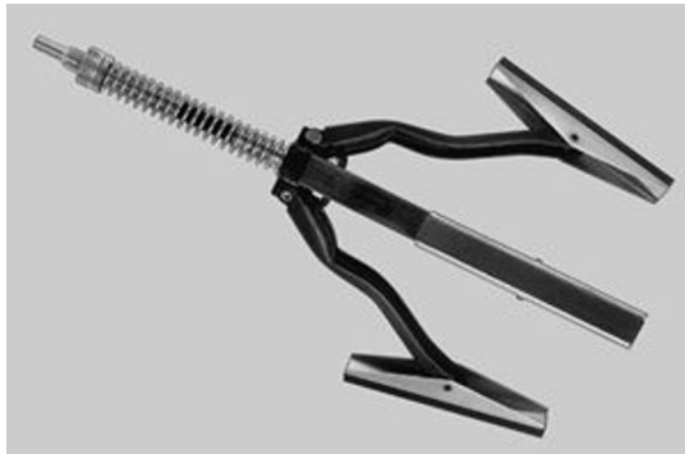
Figur 22: Typisk honeverktøy for å slipe sylindre i forbrenningsmotorer.
