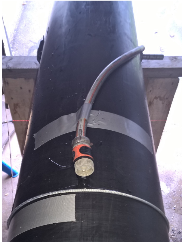
Figur 6: Forsøk på å oppnå våt friksjon
