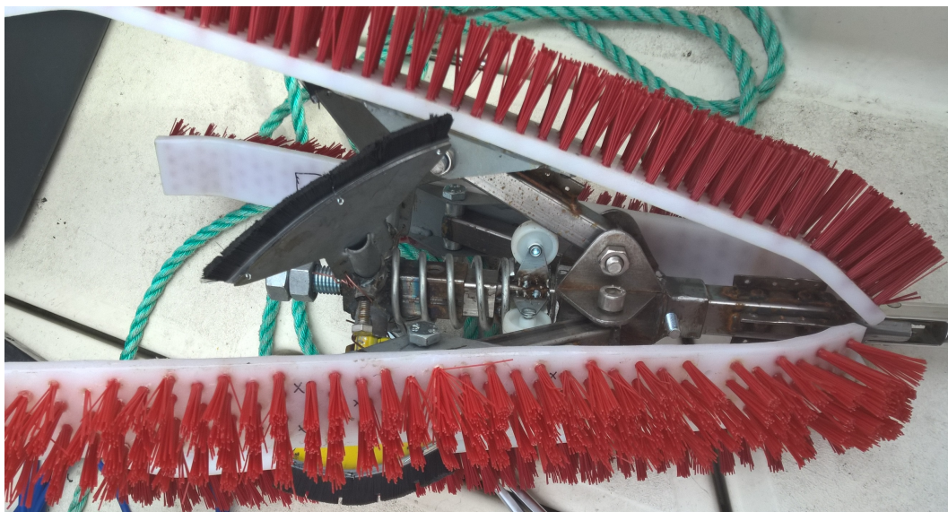
Figur 23: Fjærsystem og modifiserte blader på RE Mk. 2
