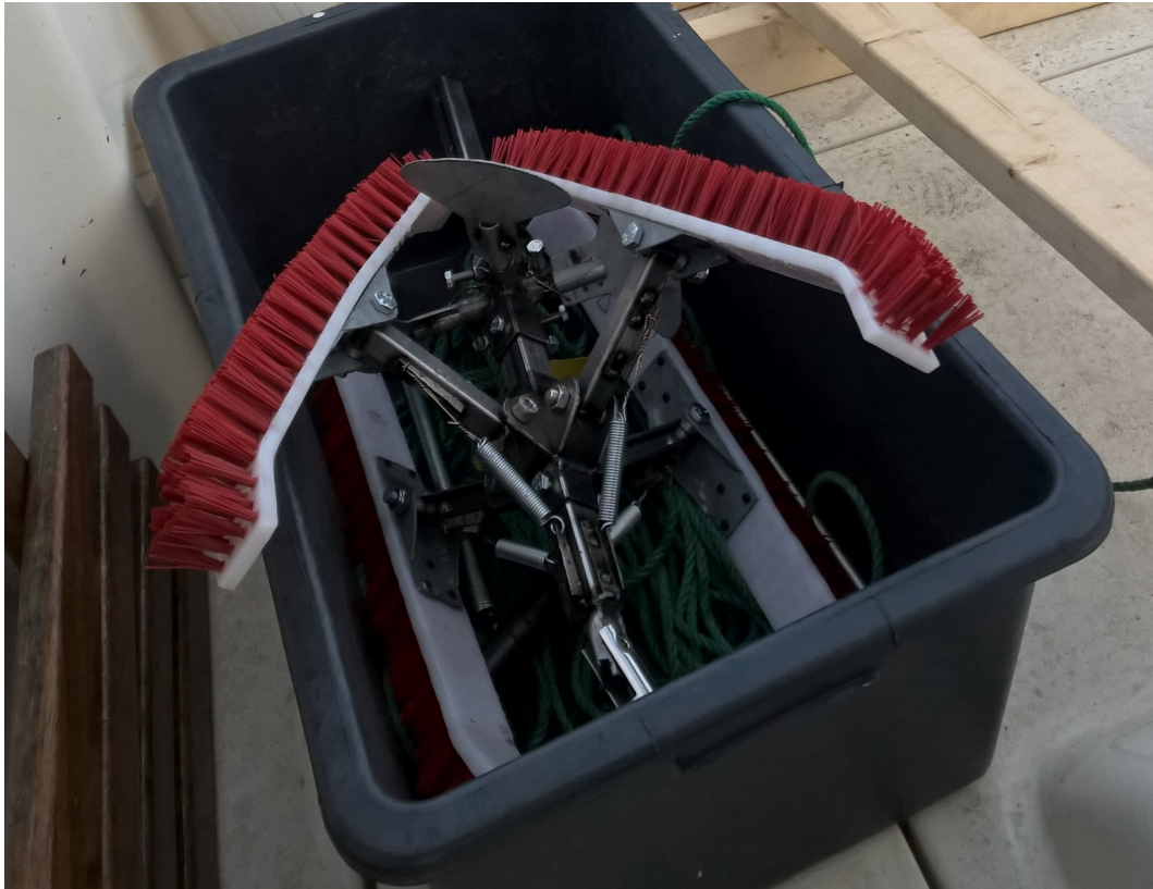
Figur 20: Fjærsystem på MK1 med strekkfjærer ses tydelig på dette bildet, hvis en ser nøye etter kan man også se de udekkede turbinbladene
