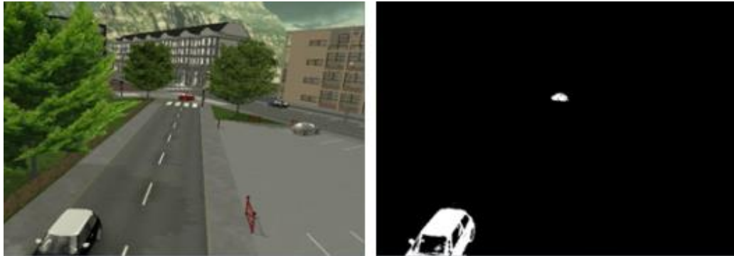
Figur 8: Biler i bevegelse (venstre er originalbilde, høyre er etter Background Subtraction ved hjelp av Mixture of Gaussians metoden)
