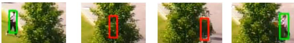
Figur 16: Eksempel, Kalmanfilter (video tatt fra 0:48 til 0:57 fra [19])
