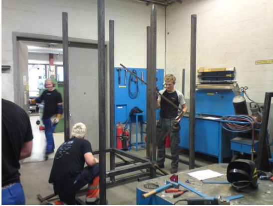
Figur 42 Sikkerhetsbur blir punktet sammen i sveisebua på OSO.
