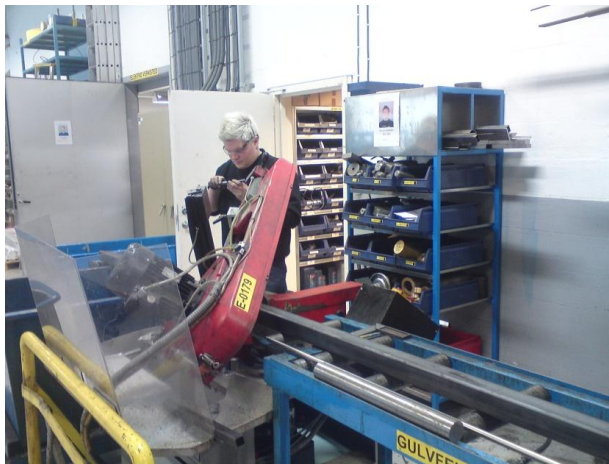
Figur 40 Ole kapper stål til sikkerhetsbur.
