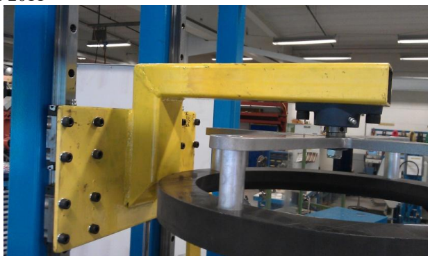
Figur 84 Påholdsbjelken hevet med 100mm for å passe alle tankene.
