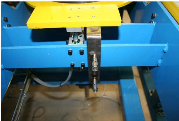
Figur 70 Sensorbrakett m/sensorer til stopper.
