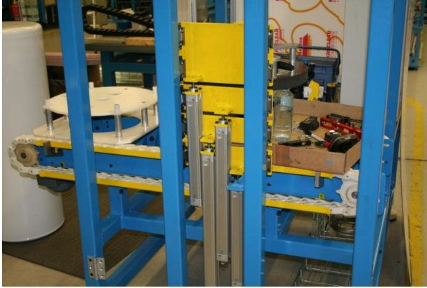
Figur 62 Sylindrerke i påhold montert.
