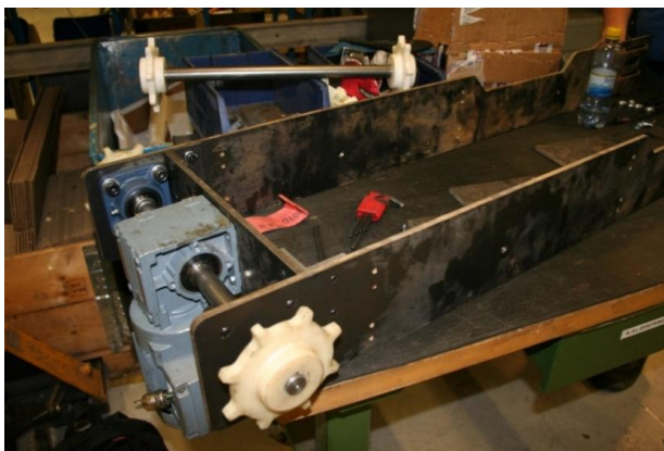
Figur 46 Båndmodul prøvemontert etter vannskjæring.
