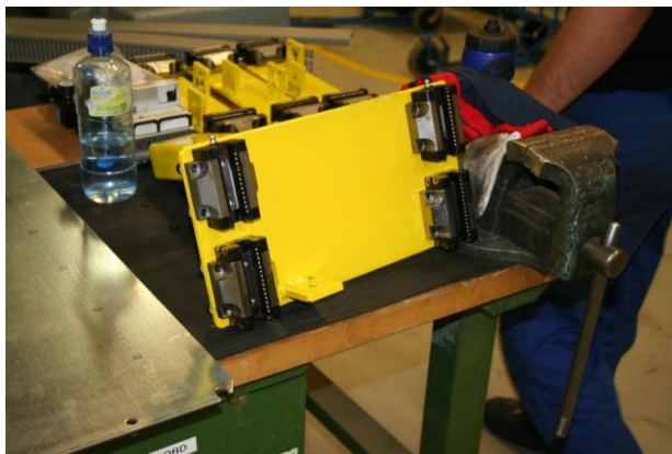
Figur 52 Montering av vogner for linjær kulebane i påhold.
