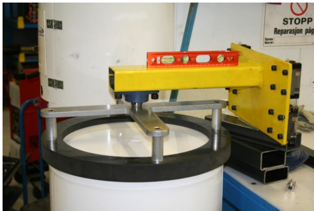
Figur 31 Påholdsring prøvemontert på tank.
