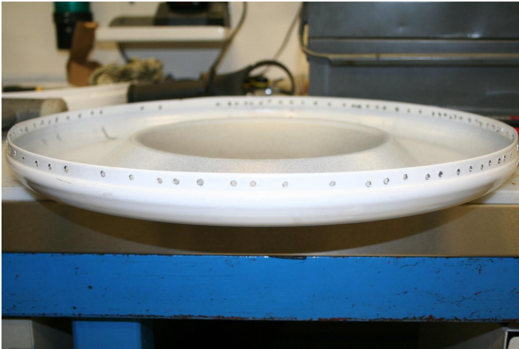
Figur 89 Test av skrukehøyde, skrudd 100 testskruer.
