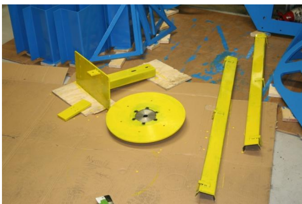
Figur 54 De gulmalte delene trengte flere strøk for å bli dekket.
