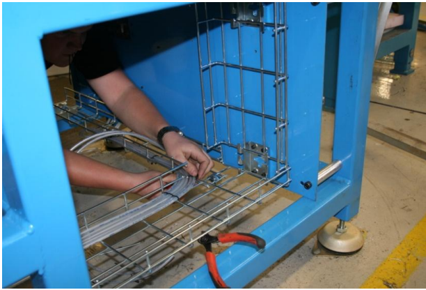
Figur 69 Pneumatiske slanger legges systematisk.
