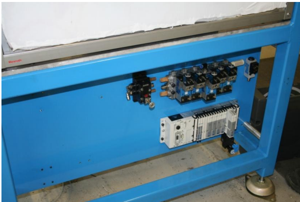
Figur 64 Plate for montering av luftbehandling, ventilblokker og koblingsboks.
