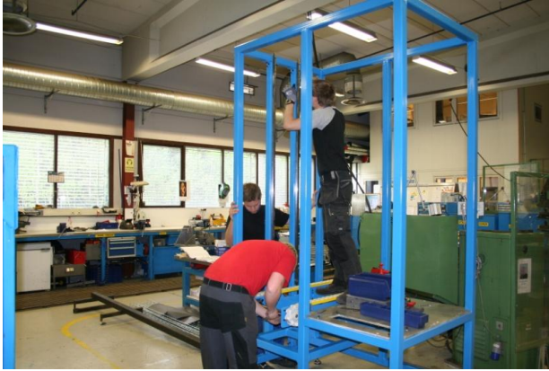
Figur 56 Montering av båndmodul og linjære kulebaner.
