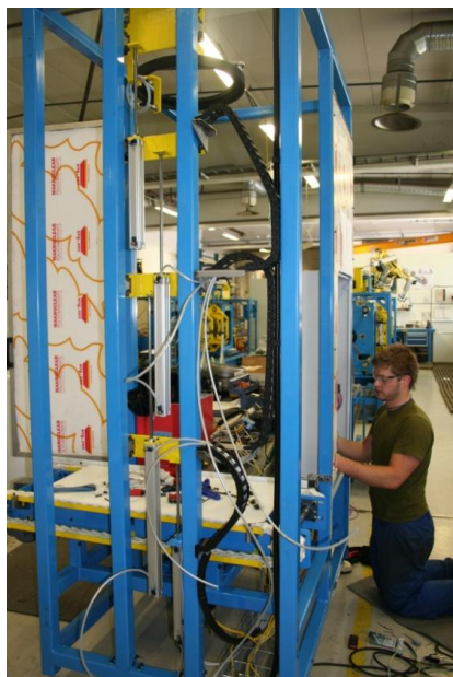
Figur 75 Kabelkjeder under montering, Svein kobler i el. skapet.
