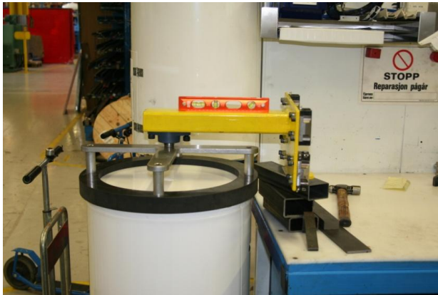
Figur 57 Prøveinstallering av påhold og oppmåling for sensorbrakett.
