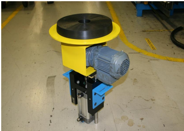
Figur 22 På platen ble det montert en POM sentreringsplate.
