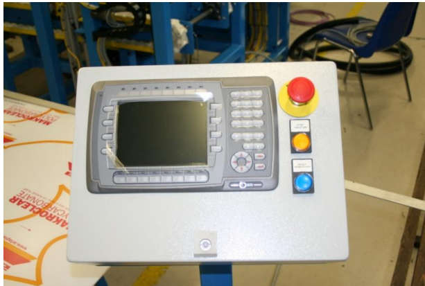
Figur 78 Operatørpanel i skap med nødstopbryter og resetknapper til nødstop og grindstop.
