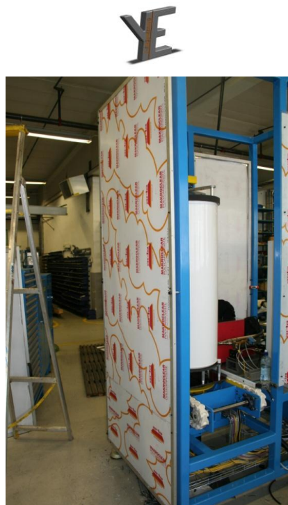
Figur 80 Montert lexan beskyttelsesvegg.
