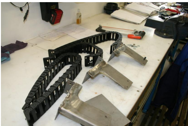
Figur 74 Kabelkjeder og braketter for føring av pneumatiske slanger og sensorledninger til påholdet.
