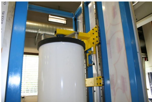
Figur 81 Første tvangskjøring av påholdet, passer bra på tanken.
