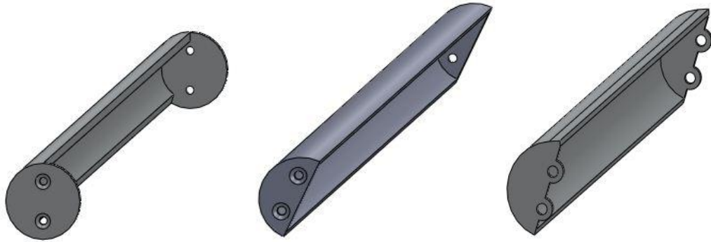
FIGUR 02.01 – TRE ALTERNATIVE LØSNINGER SOM KREVER SVEISING
