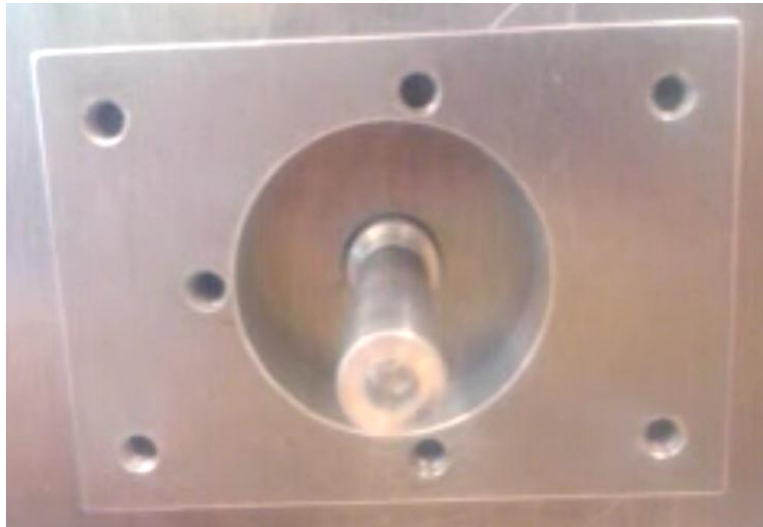
FIGUR 02.01 – SKJEV AKSEL TILHØRENDE RENNINGSBOM
