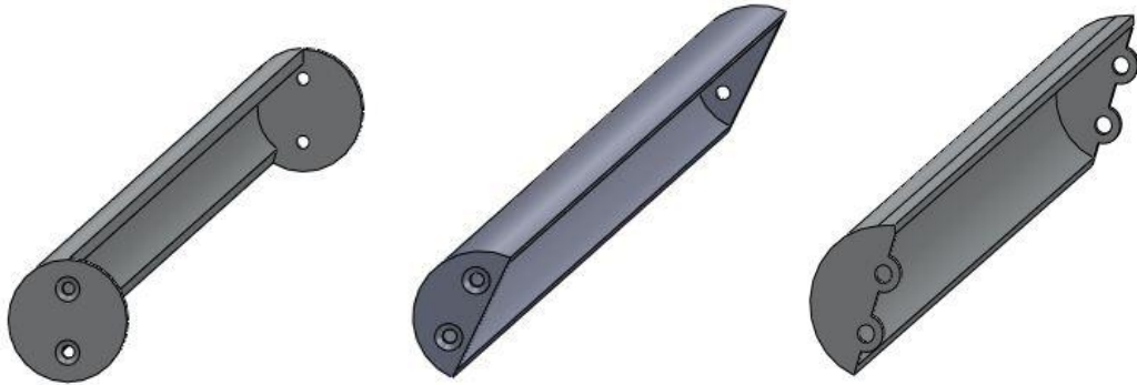
FIGUR 03.01 – TRE ALTERNATIVE LØSNINGER SOM KREVER SVEISING
