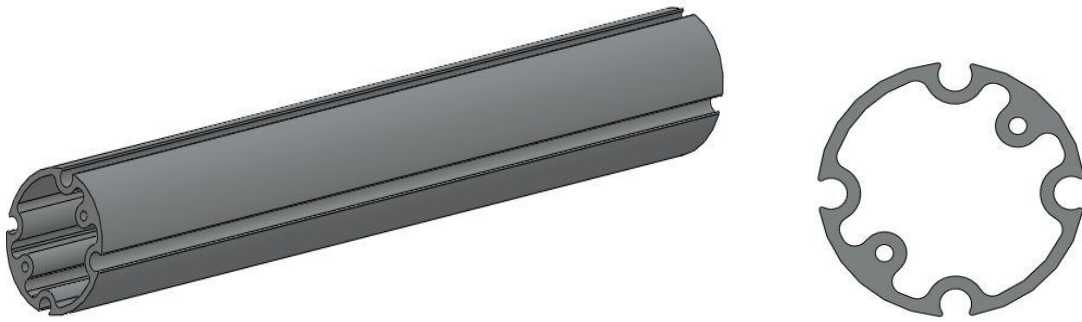
FIGUR 03.06 TVERRSNITT OG SIDEVIEW PÅ RENNING/VAREBOM
