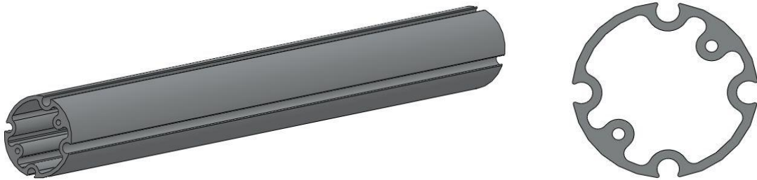
FIGUR 02.06 – LØSNINGSFORSLAG TIL RENNING/VAREBOM
