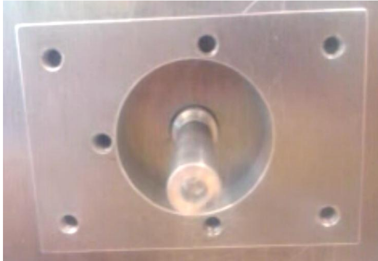
FIGUR 06.01 – SKJEV AKSEL TILHØRENDE RENNINGSBOM
