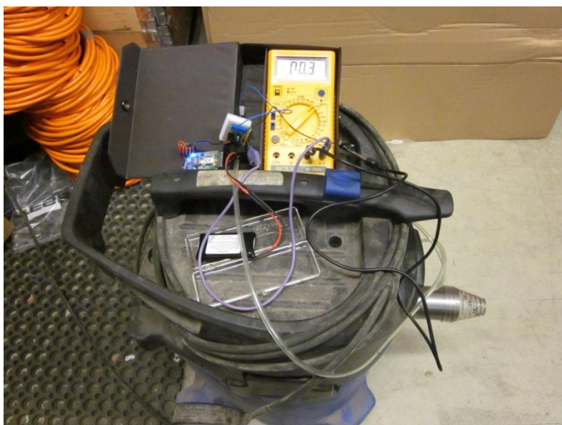
Figur 1. Instrumenter for undertrykksmåling. Til høyre ses adapter for undertrykksmåler og adapter for forskjellige slangestørrelser.
