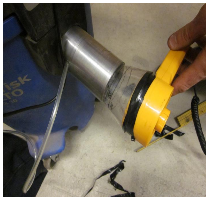
Figur 3. Viser støvsugeren påmontert adapter for undertrykksmåling under 55mm testen.
