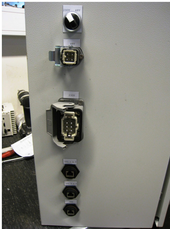
Bilde 2 Testtrigg sett fra siden med tilkoblinger
