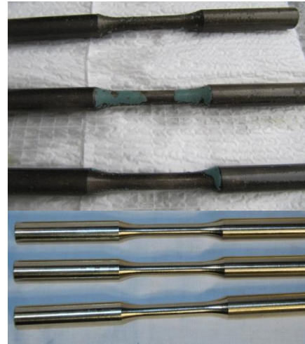
Figur 4.3 – Prøvestaver Ni – Al bronse utsatt for overflatekorrosjon. Under: upåvirket for korrosjon.
