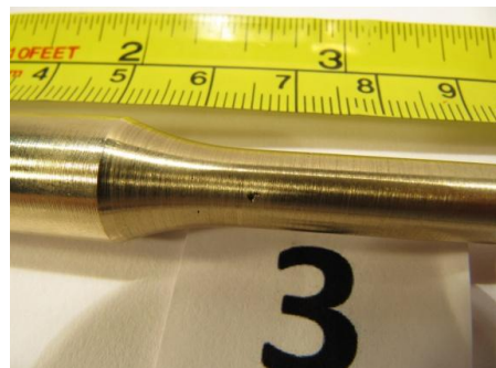
Figur 12 – Stor pore på overflaten
