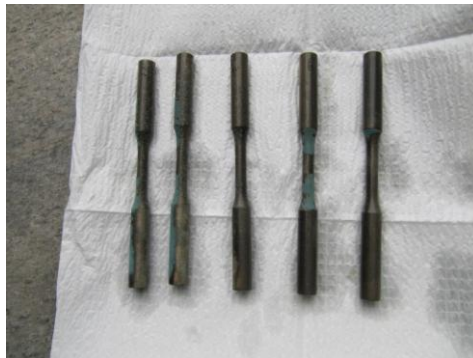
Staver etter saltvannsopphold. Tydelig overflatekorrosjon.
