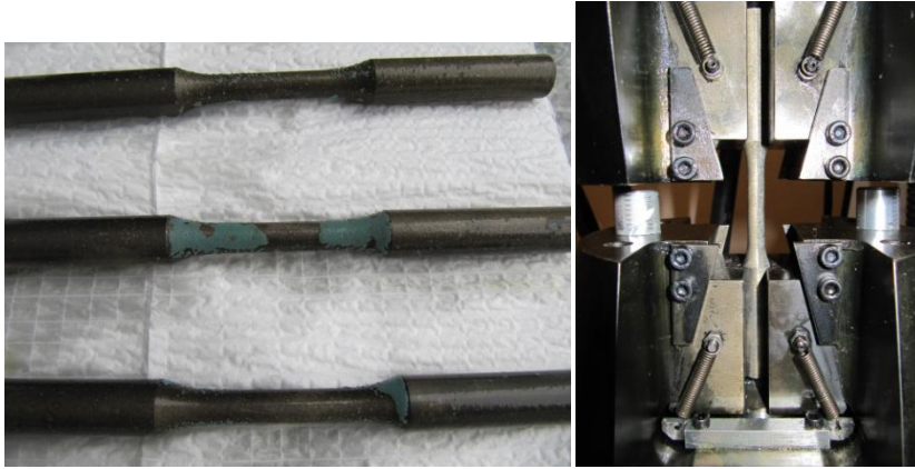
Figur 1 – Staver etter saltvannsopphold. Stav i maskin.
