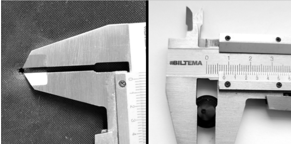
Figur 5: Forskjell i kaliber og hullstørrelse viser elastisiteten til det første polymerlaget av målskiven.
