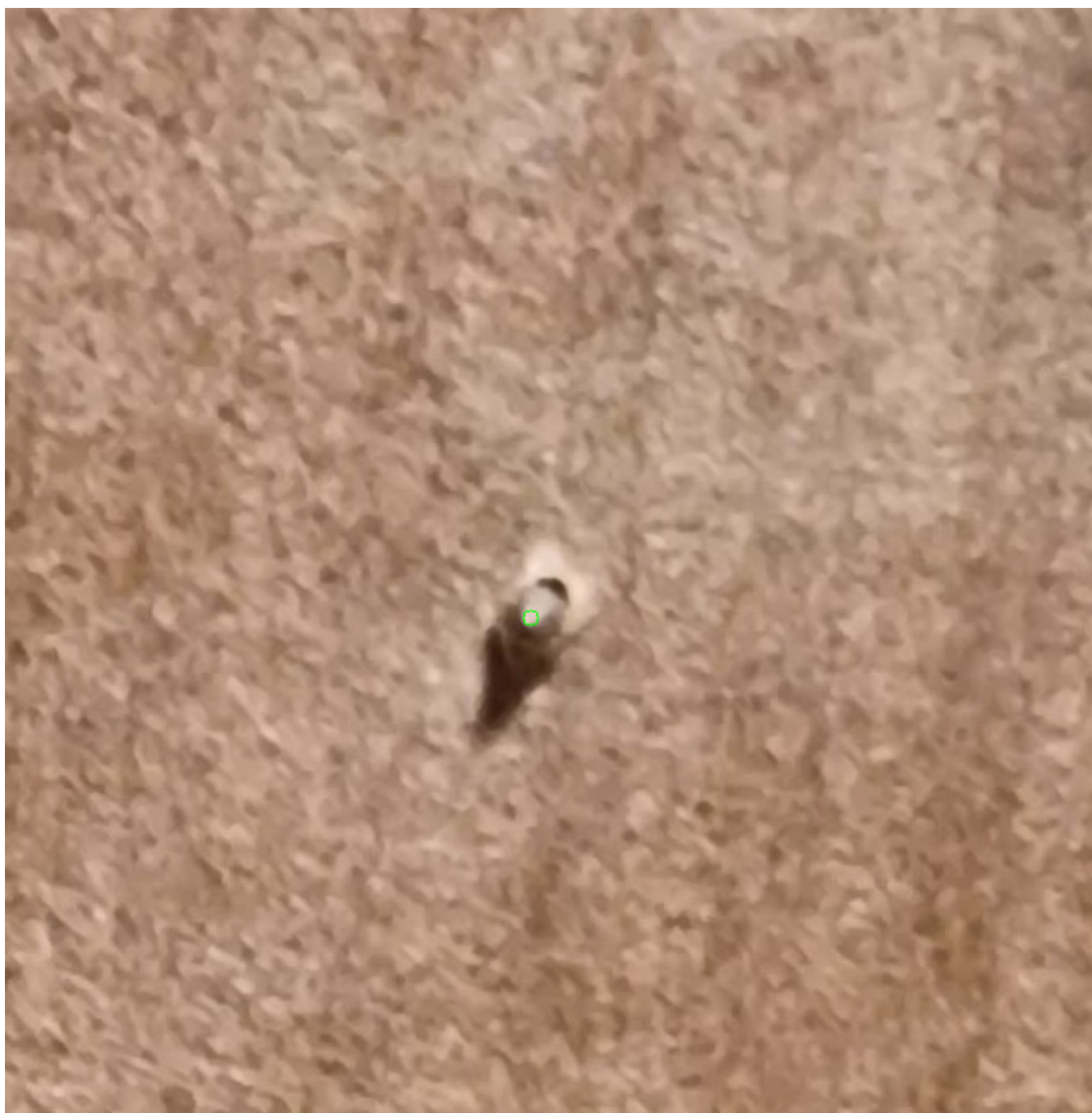
Figur 18: Deteksjon av metall topp. Den grønne sirkelen markerer spissen, altså midten på punktet.
