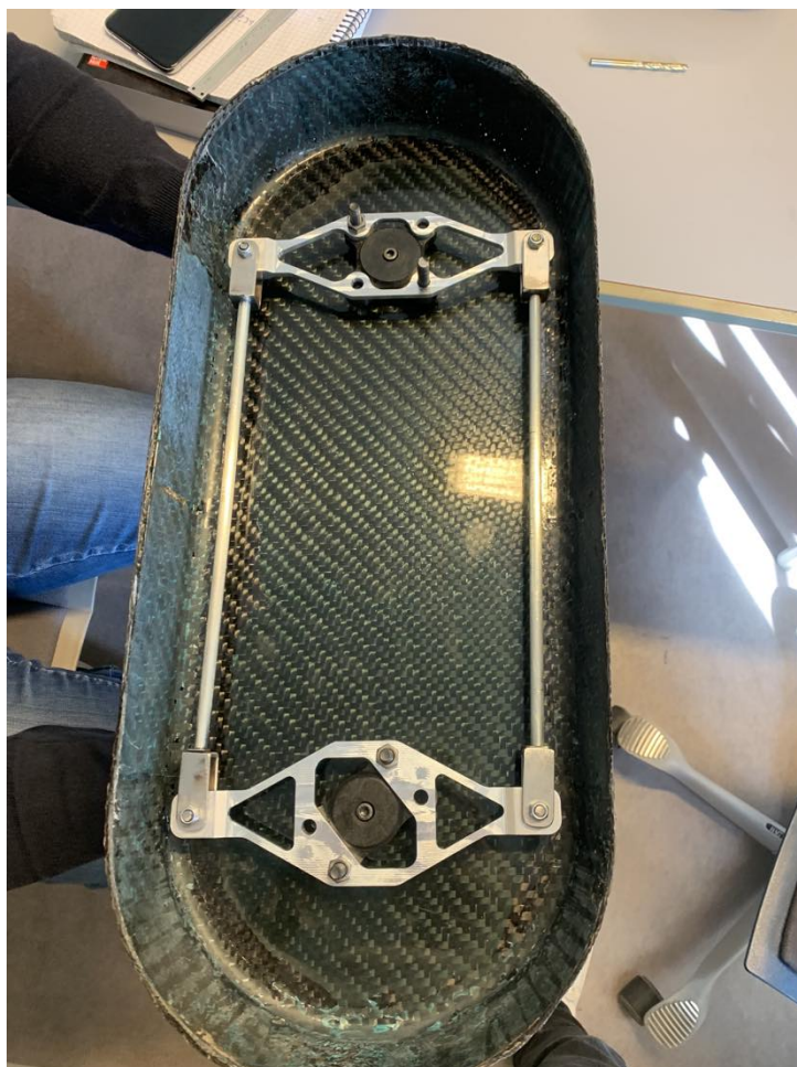
Figur 5.87: Styremekanisme montert inne i karbonfiberdekselet
