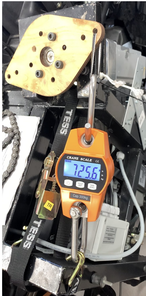
Figur 5.32: Måling av moment fra steppermotor
