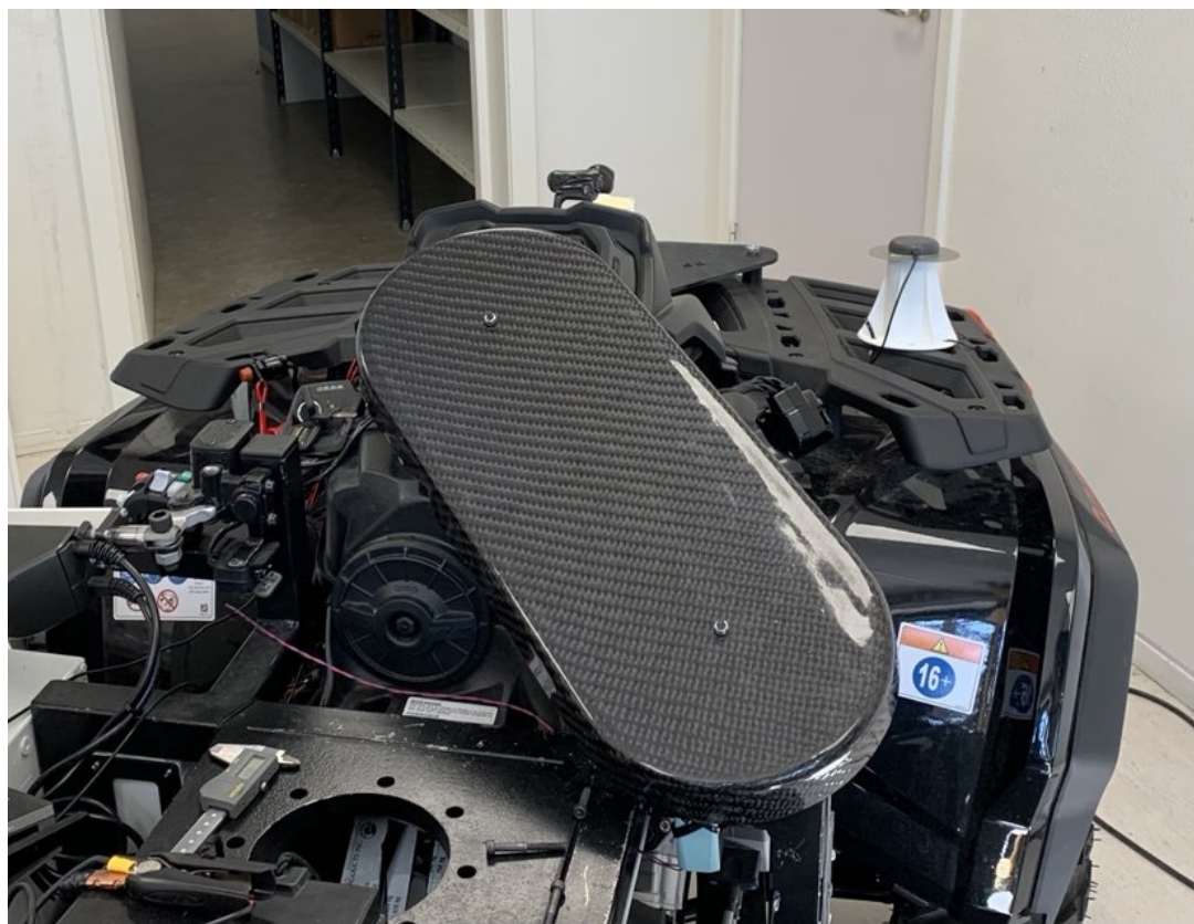
Figur 5.86: Karbonfiber deksel montert på ATV
