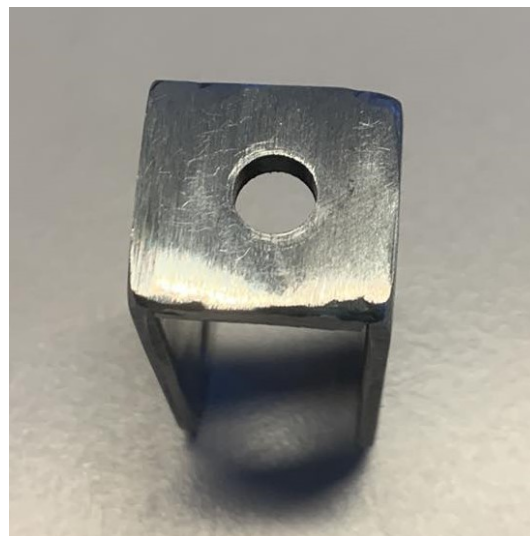
Figur 5.59: Sveist U-brakett etter sliping
