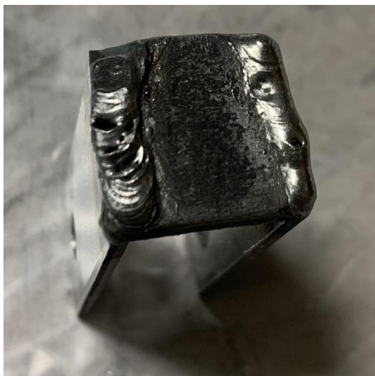
Figur 5.58: Sveist U-brakett før sliping
