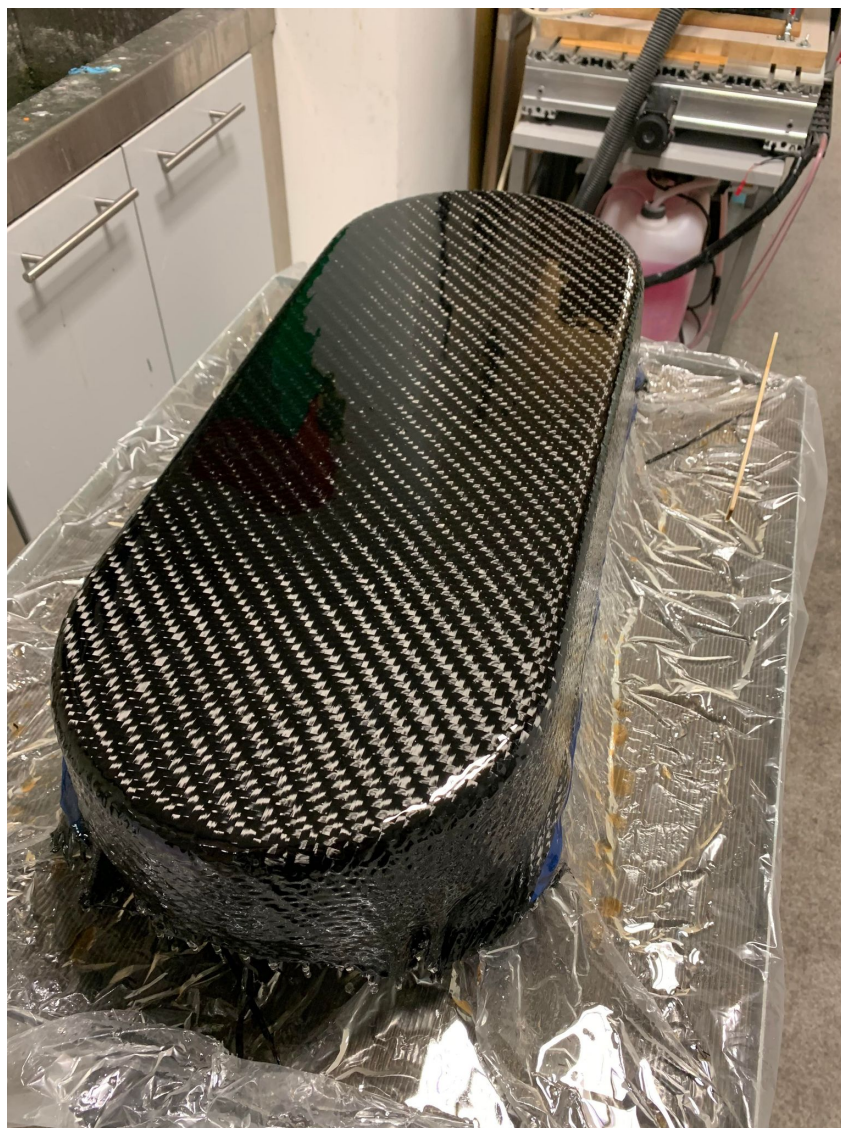
Figur 5.84: Karbonfiber deksel etter syv lag med epoxy
