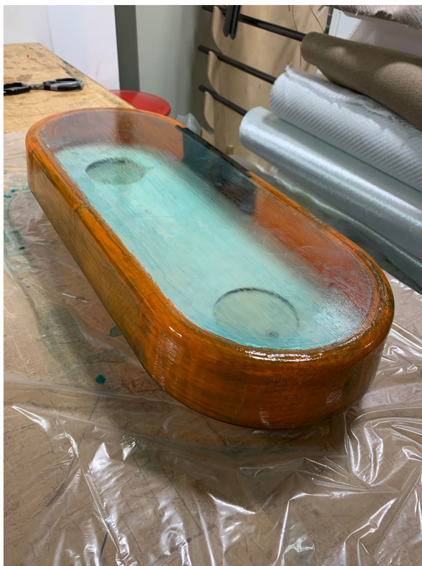
Figur 5.82: Støpeform etter tre lag med PVA trennfilm
