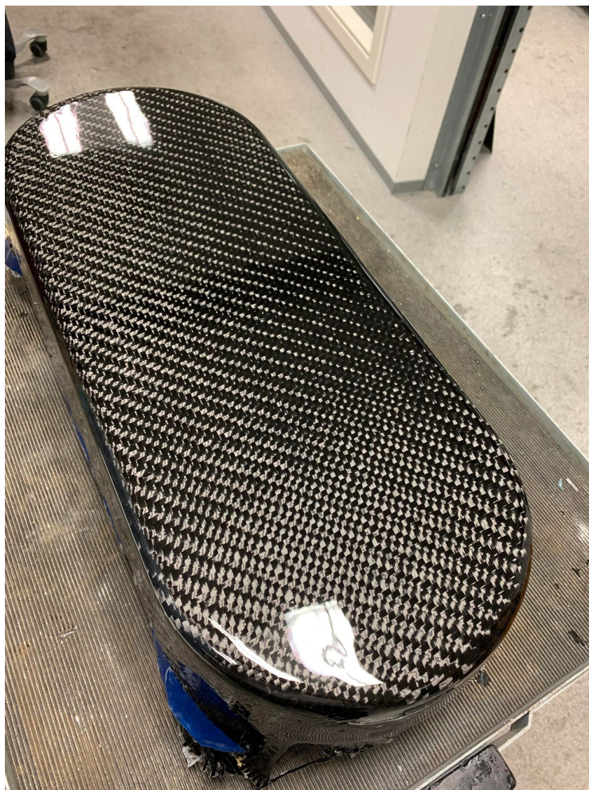
Figur 5.85: Karbonfiberdeksel etter klarlakk
