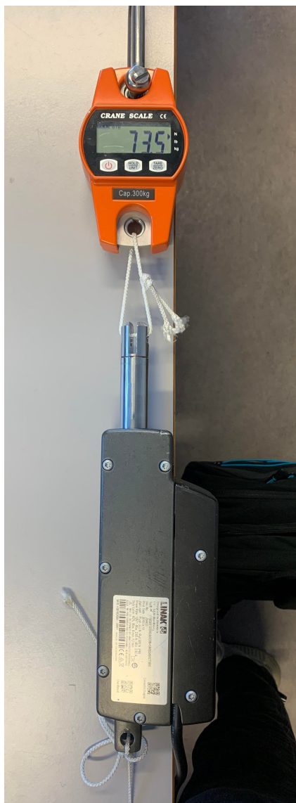
Figur 5.18: Test av påførte krefter på lineæraktuator
