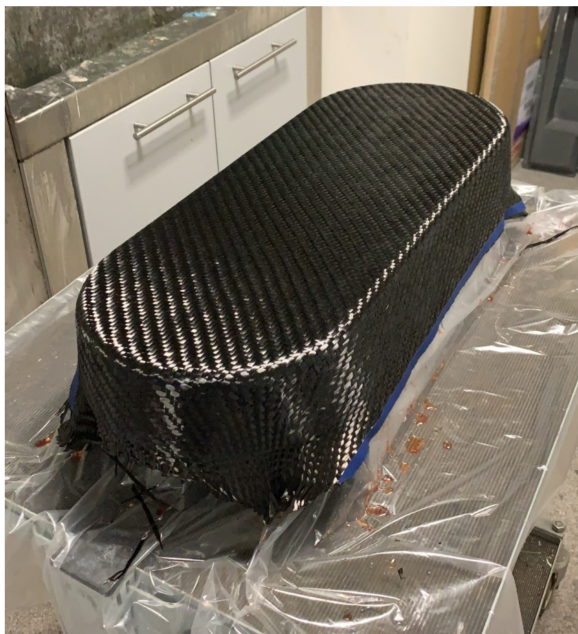
Figur 5.83: Første lag med karbonfiber på støpeformen
