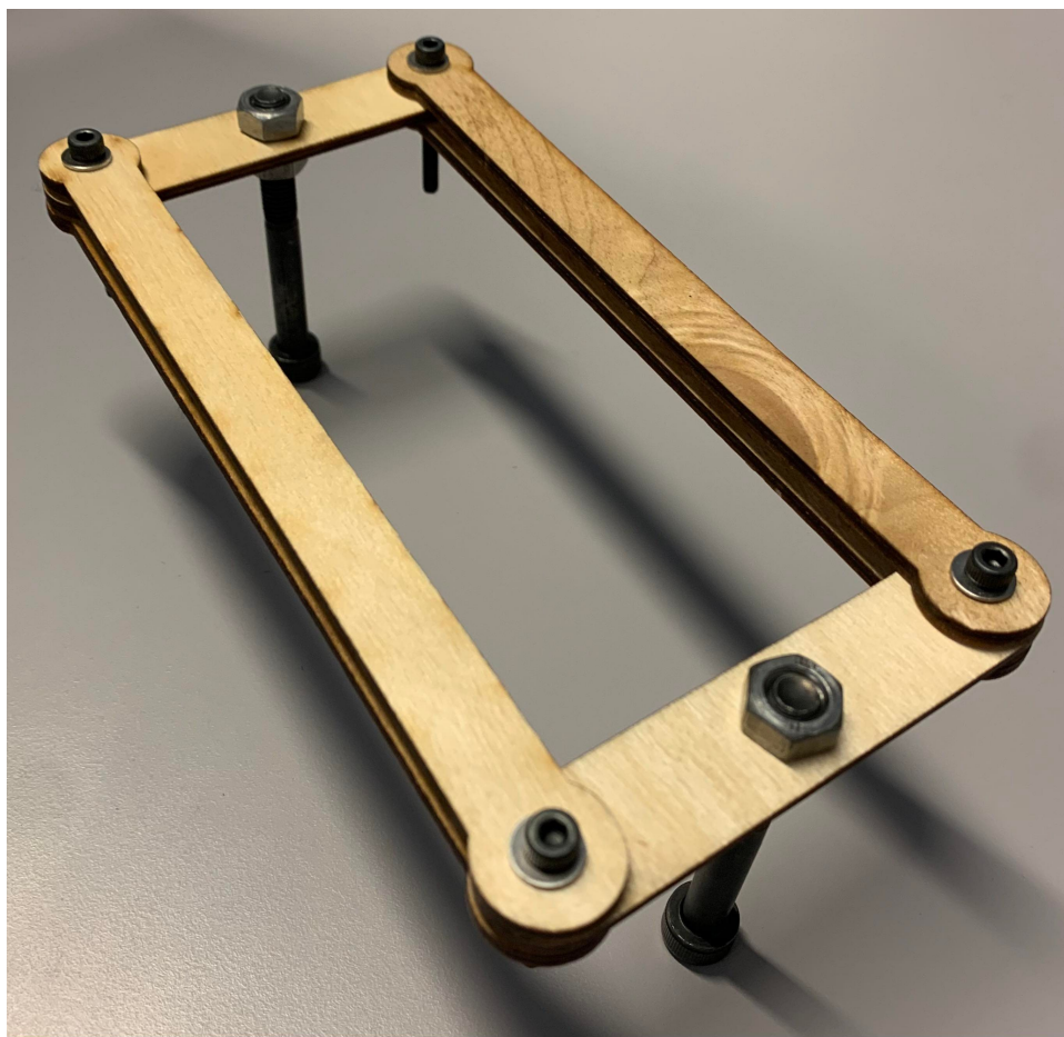
Figur 5.27: Miniaturprototype av styresystemet
