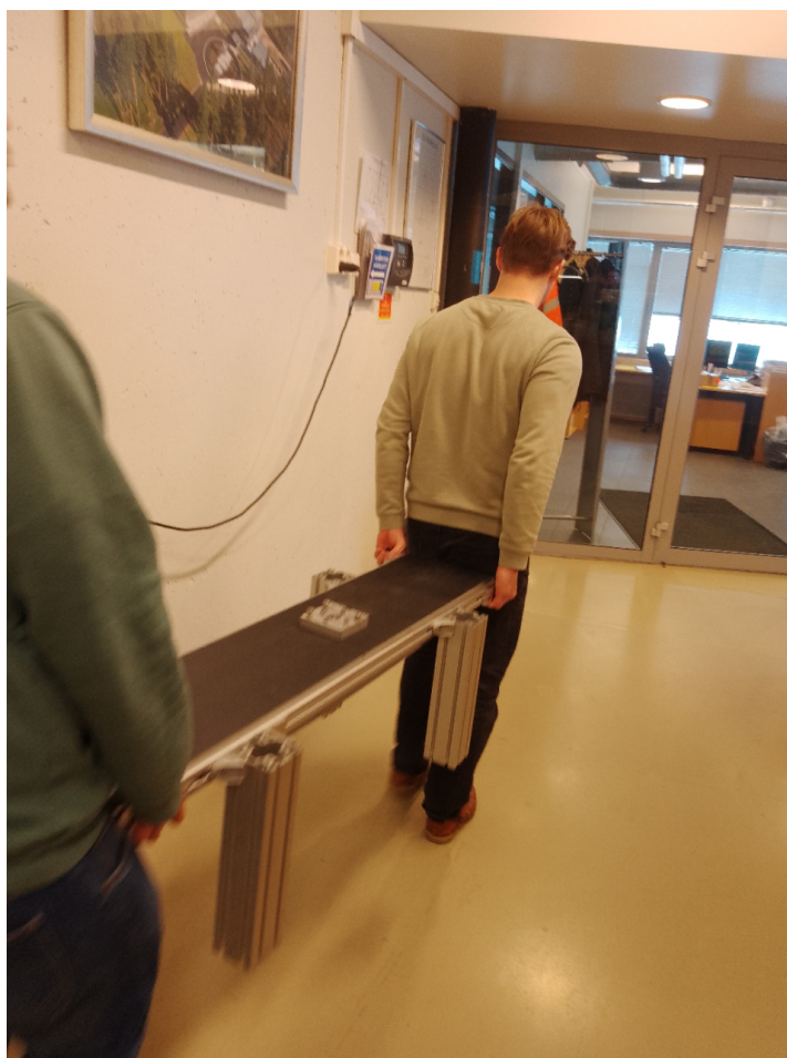
Figur 8.1: Innløpsbane som ble lånt fra Tronrud.
