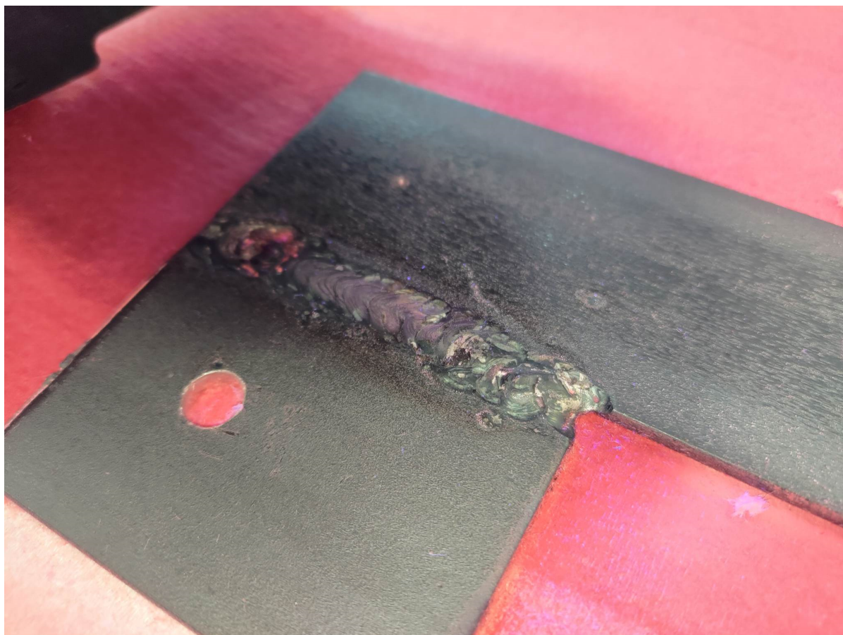
Figur 43: Ferdig godkjent sveis.
