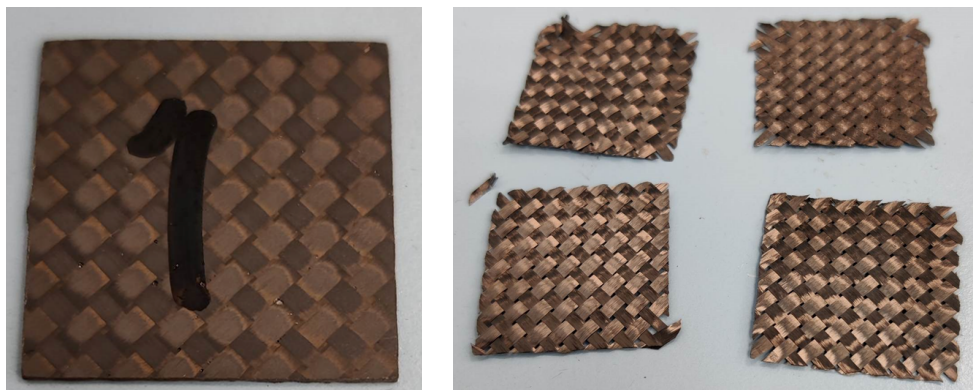
Figur 25: Karbon teststykke: Nytt teststykke 1 t.v. og ferdig varmet teststykke.
