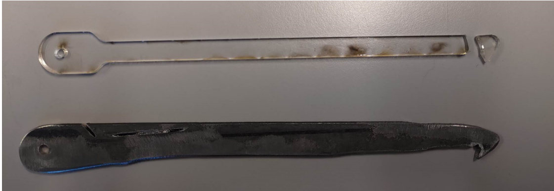
Figur 48: Låsearm i pleksiglass etter feilet test øverst. Sterkere og godkjent låsearm nederst.
